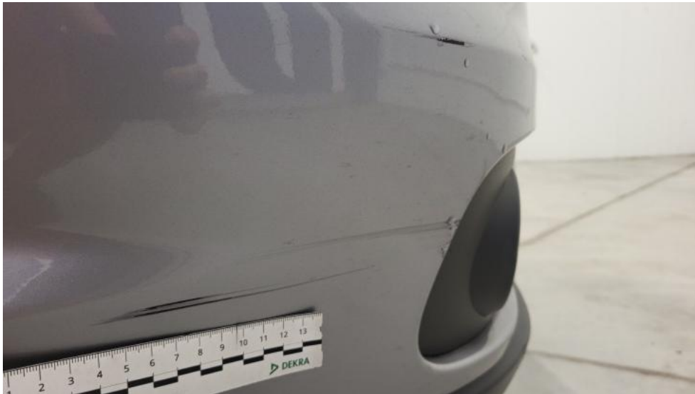
Fot. 53. Zderzak() - Rysa/odprysk 3
