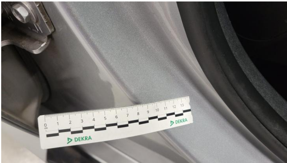
Fot. 75. Słupek środkowy P - Rysa/odprysk 1
