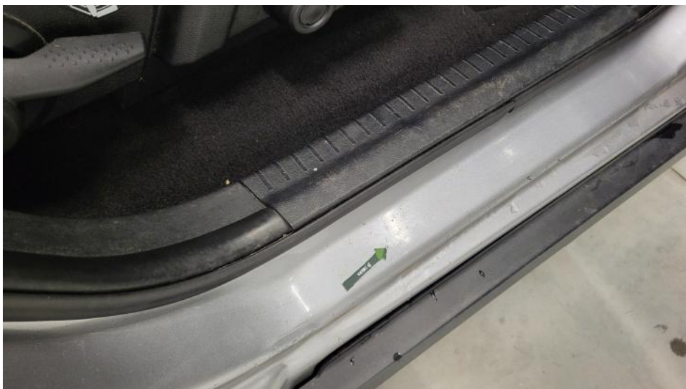
Fot. 70. Próg P - Wgniecenie/odkształcenie 1
