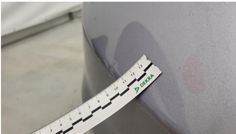
Fot. 54. Zderzak - Wgniecenie/odkształcenie 1
