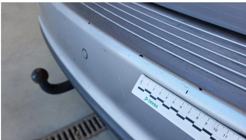
Fot. 84. Zderzak tylny - Rysa/odprysk 2
