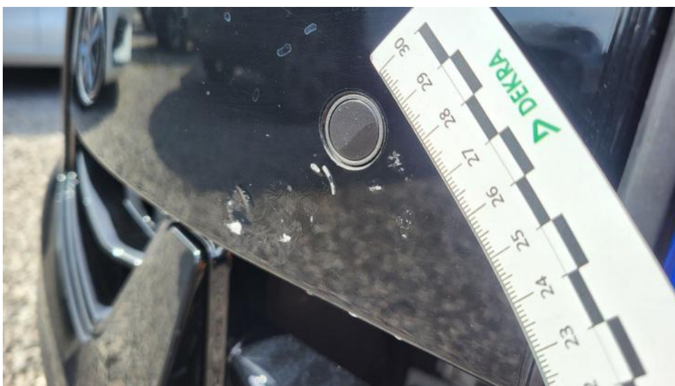
Fot. 41. Zderzak - Wgniecenie/odkształcenie 1
