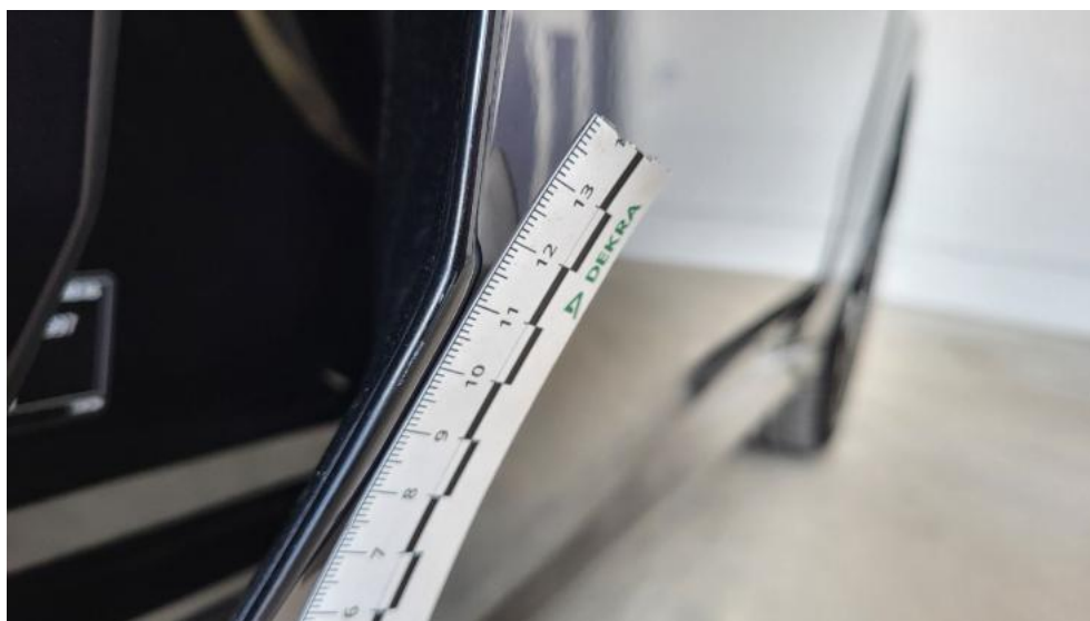
Fot. 60. Drzwi przednie P - Rysa/odprysk 1
