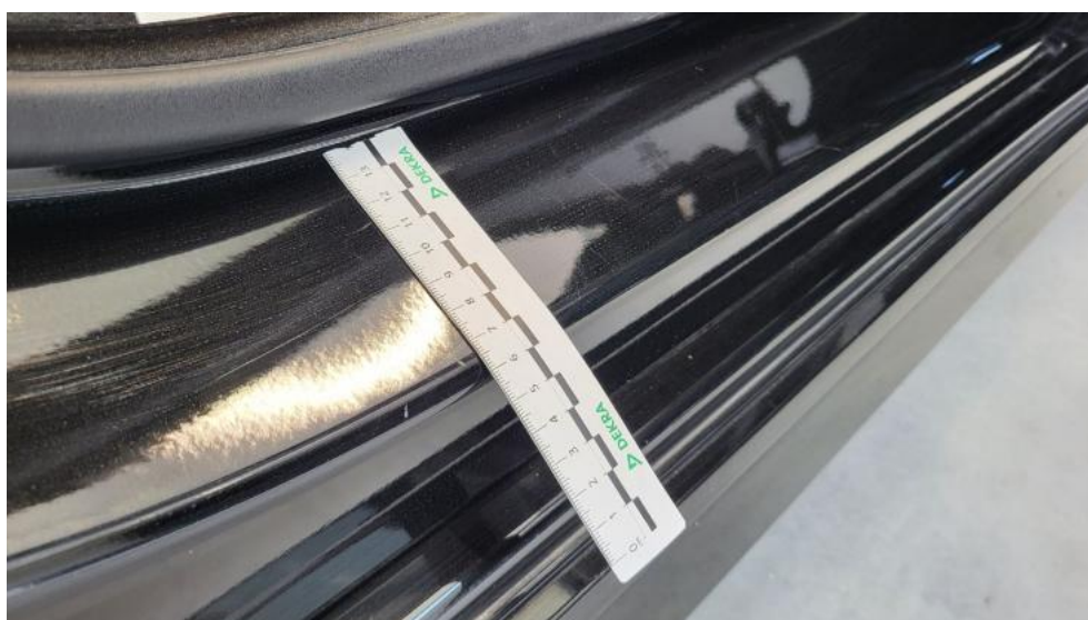
Fot. 64. Próg P - Rysa/odprysk 1
