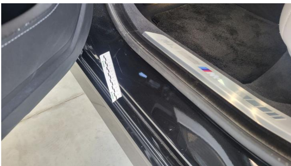
Fot. 74. Próg L - Rysa/odprysk 1
