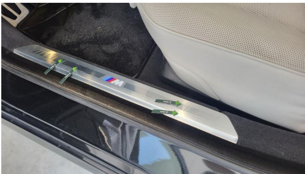
Fot. 79. Listwy progowe lew. - Wgniecenie/odkształcenie 1
