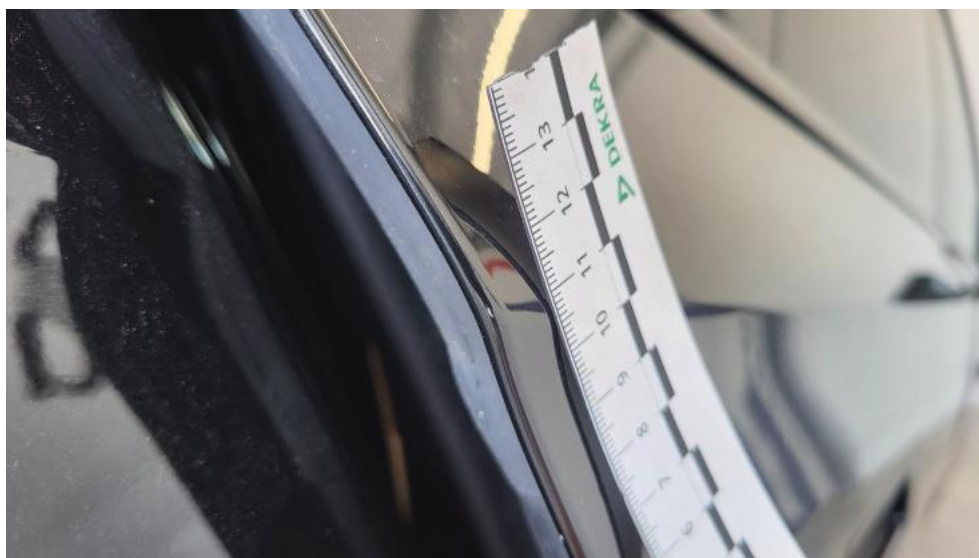
Fot. 62. Drzwi tylne P - Rysa/odprysk 1
