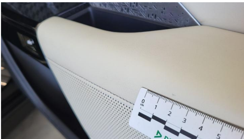
Fot. 77. Tapicerka drzwi przednich P - Rysa/odprysk 1
