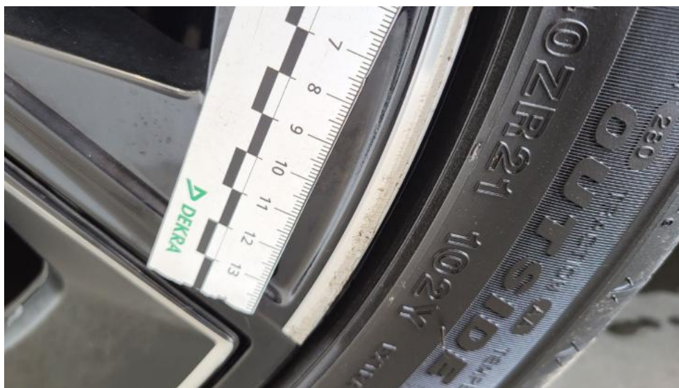
Fot. 75. Felga Aluminiowa przednia L - Rysa/odprysk 1
