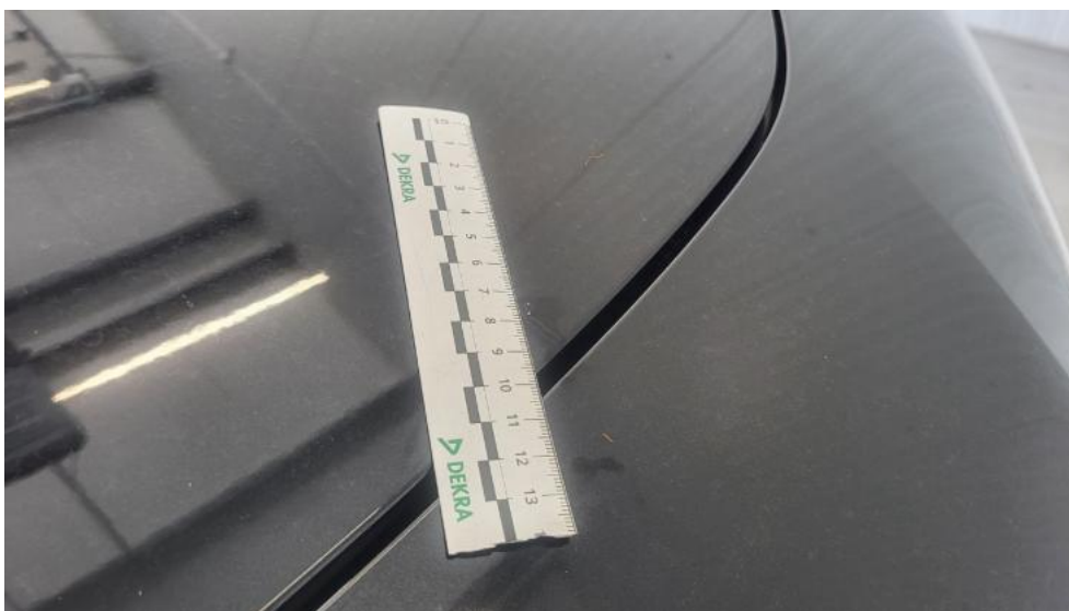
Fot. 55. Pokrywa komory silnika - Rysa/odprysk 1
