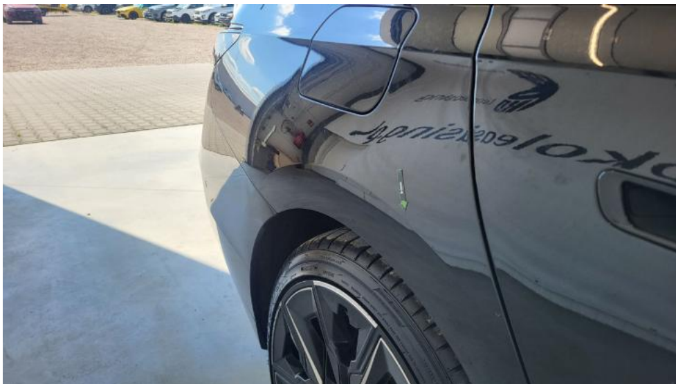
Fot. 65. Błotnik tylny P / Ściana boczna P - Wgniecenie/odkształcenie 1
