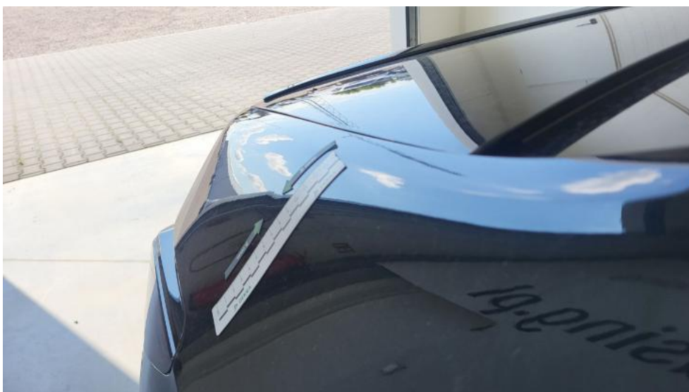
Fot. 66. Błotnik tylny P / Ściana boczna P - Wgniecenie/odkształcenie 2
