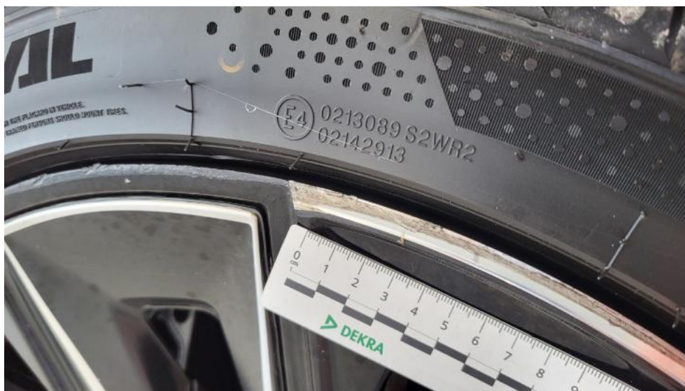
Fot. 59. Felga aluminiowa przednia P - Rysa/odprysk 1
