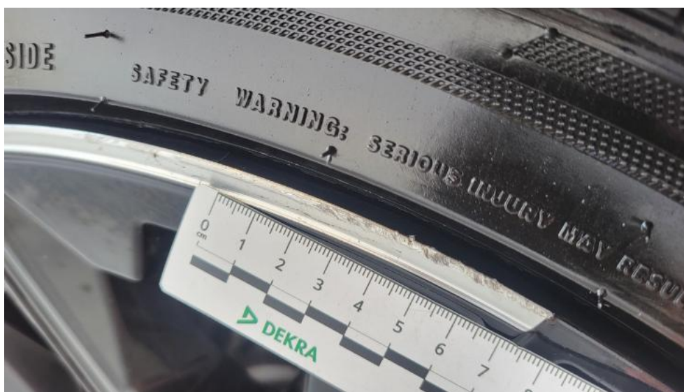
Fot. 67. Felga aluminiowa tylna P - Rysa/odprysk 1
