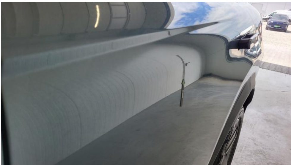
Fot. 65. Drzwi tylne L - Wgniecenie/odkształcenie 2
