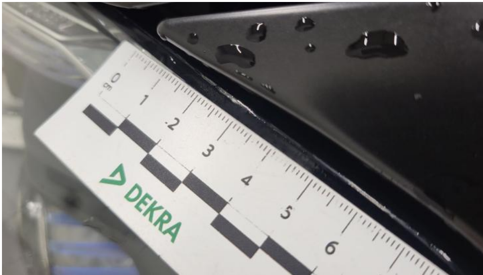
Fot. 61. Reflektor L - Rysa/odprysk 1
