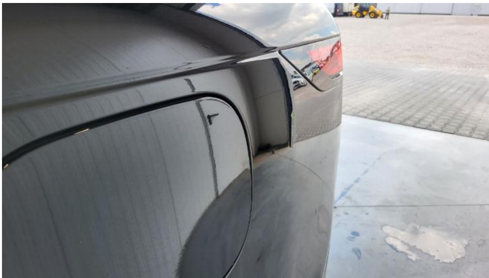
Photo 61. Błotnik tylny L / Ściana boczna L - Wgniecenie/odkształcenie 1
