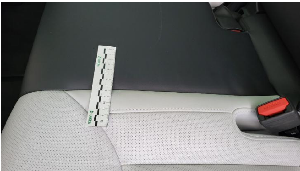
Photo 63. Kanapa tyl. - Rysa/odprysk 1
