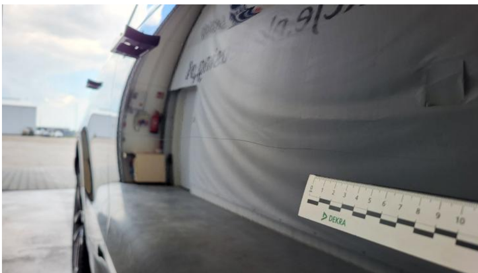
Photo 57. Drzwi przednie P - Rysa/odprysk 2
