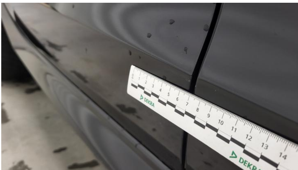
Photo 54. Drzwi tylne P - Rysa/odprysk 1
