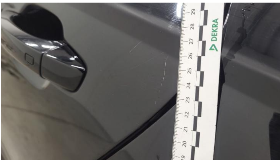
Photo 70. Drzwi tylne L - Rysa/odprysk 1
