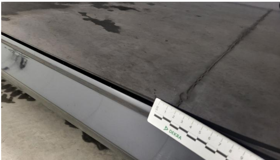
Photo 69. Drzwi przed L - Wgniecenie/odkształcenie 1
