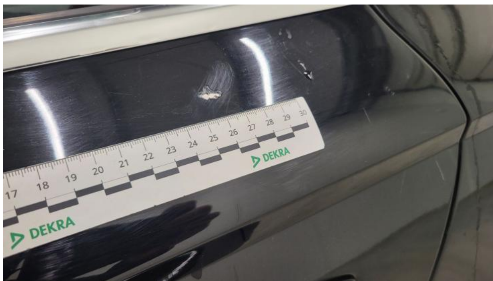
Photo 71. Drzwi tylne L - Rysa/odprysk 2
