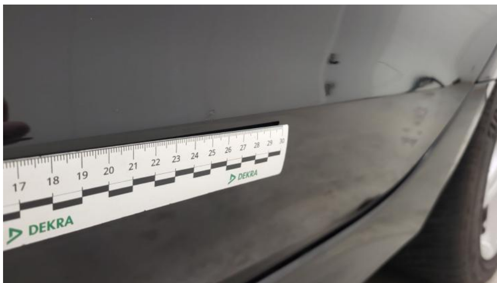
Photo 72. Drzwi tylne L() - Rysa/odprysk 3
