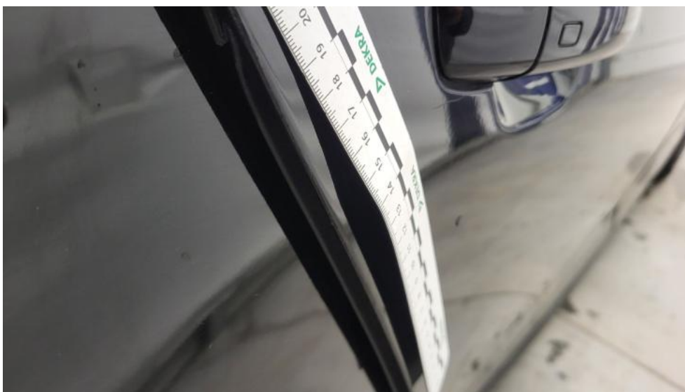
Photo 55. Drzwi tylne P - Rysa/odprysk 2
