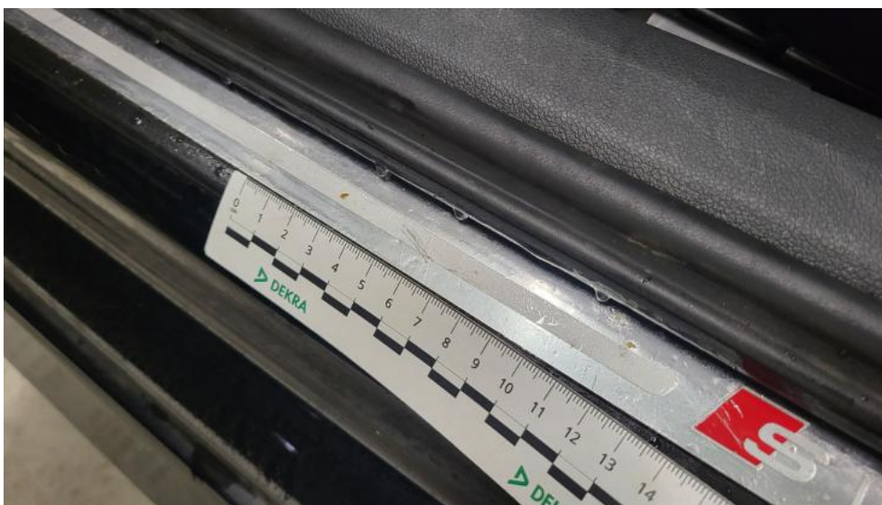
Photo 73. Próg L - Rysa/odprysk 1
