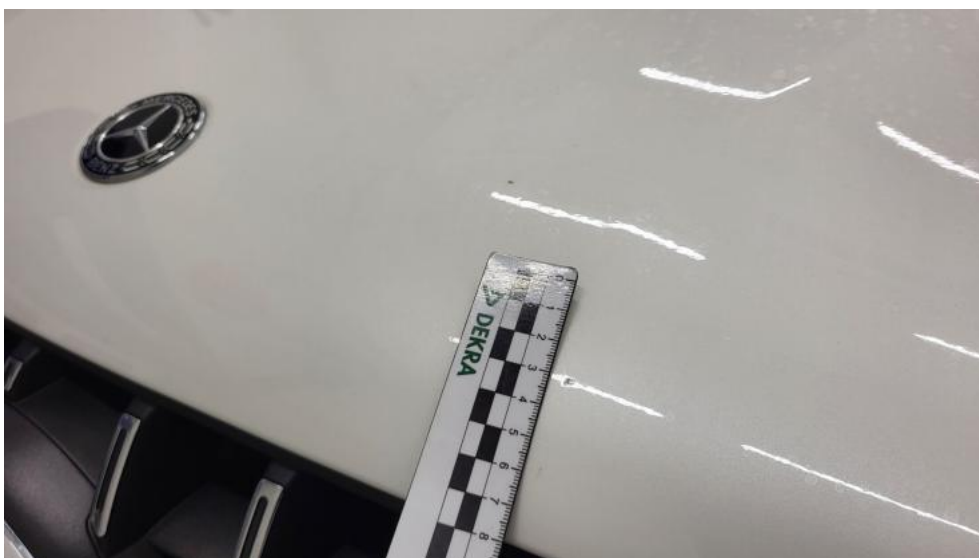
Fot. 46. Pokrywa komory silnika - Wgniecenie/odkształcenie 1
