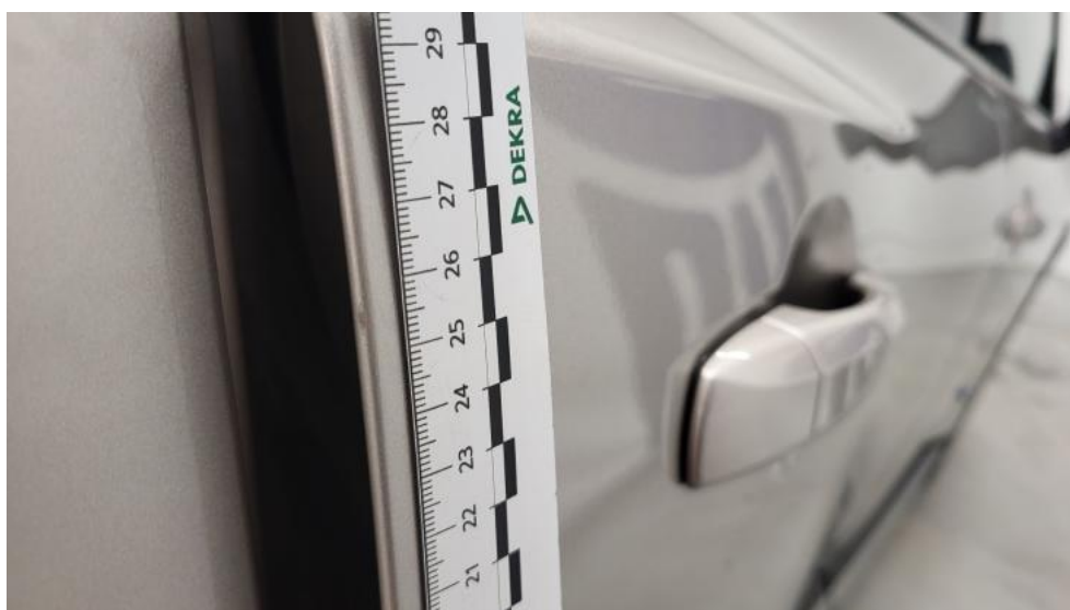
Fot. 46. Drzwi tylne P - Rysa/odprysk 1
