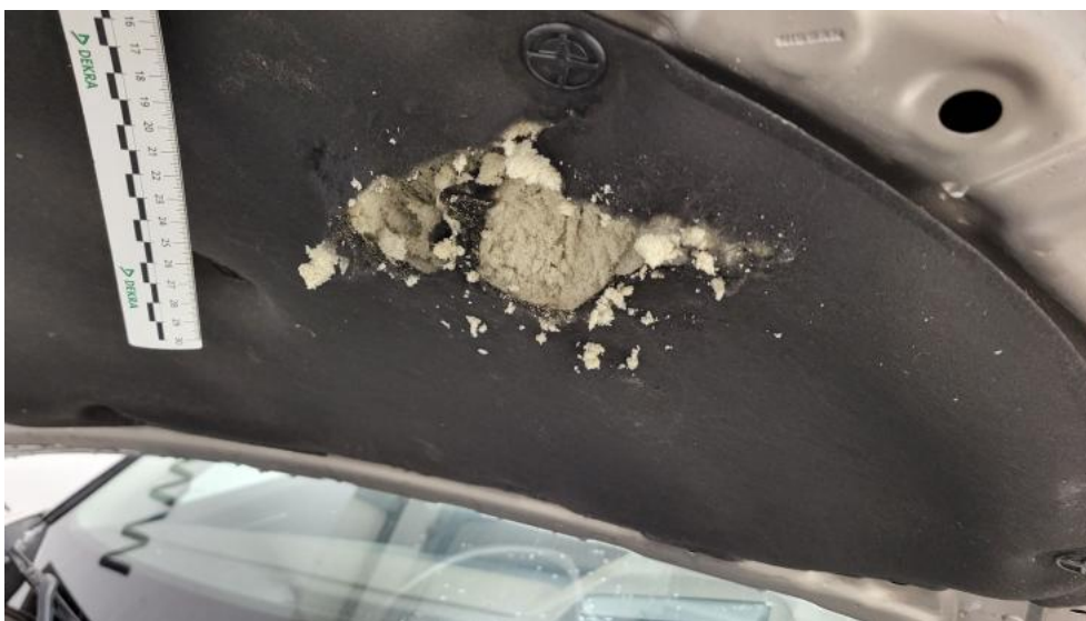
Fot. 41. Wykładzina pokrywy komory silnika - Pęknięcie/rozerwanie 1
