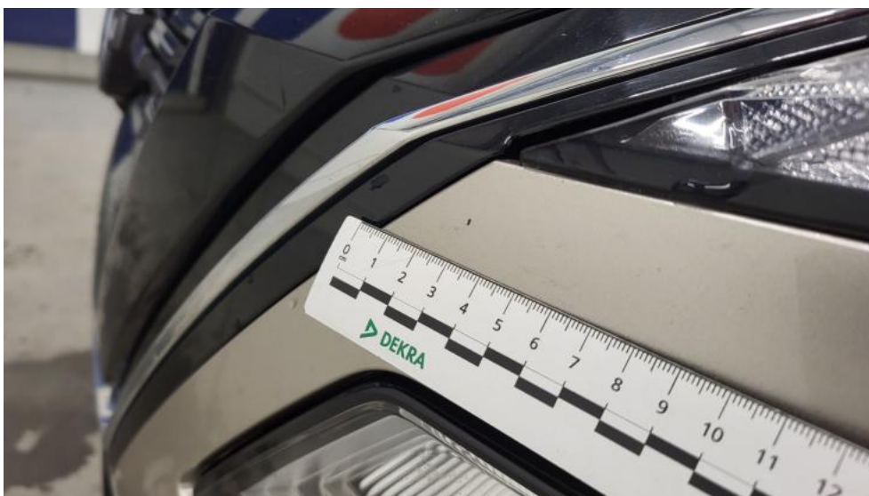
Fot. 42. Zderzak - Rysa/odprysk 1
