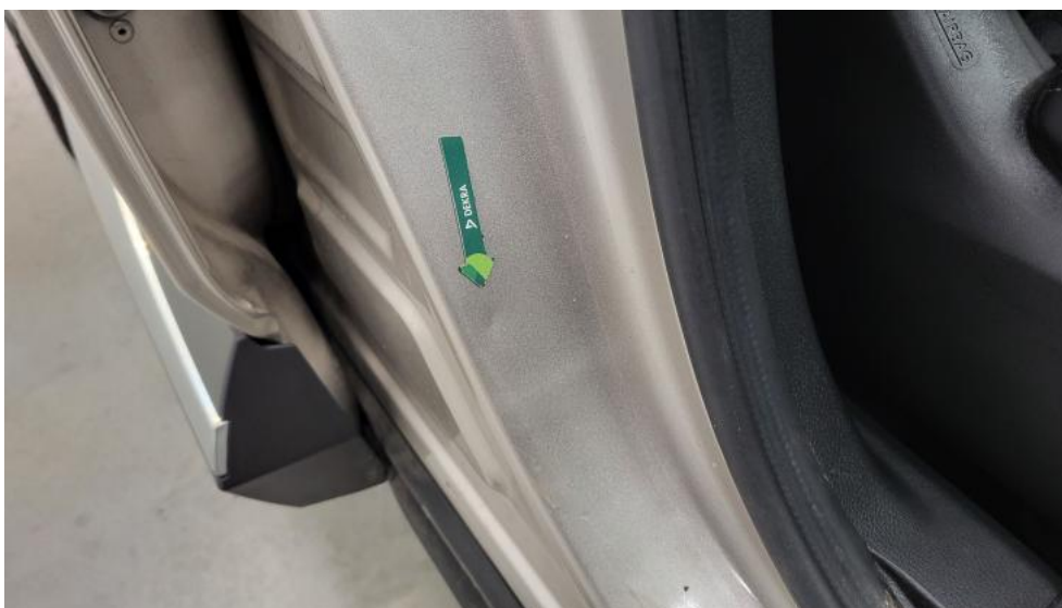
Fot. 47. Stupek środkowy P - Wgniecenie/odkształcenie 1
