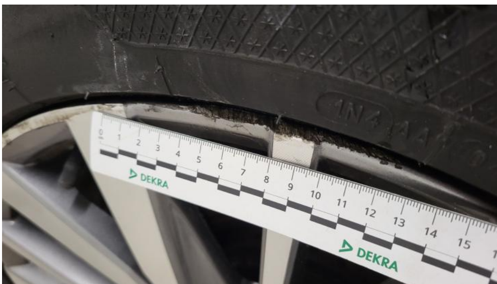
Fot. 57. Felga Aluminiowa przednia L - Rysa/odprysk 1
