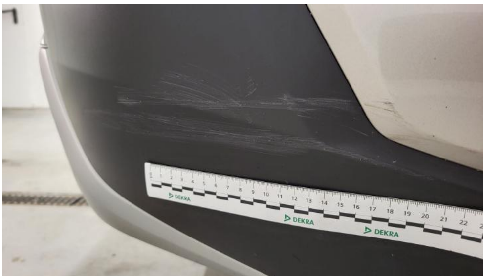
Fot. 51. Zderzak tylny - Rysa/odprysk 1
