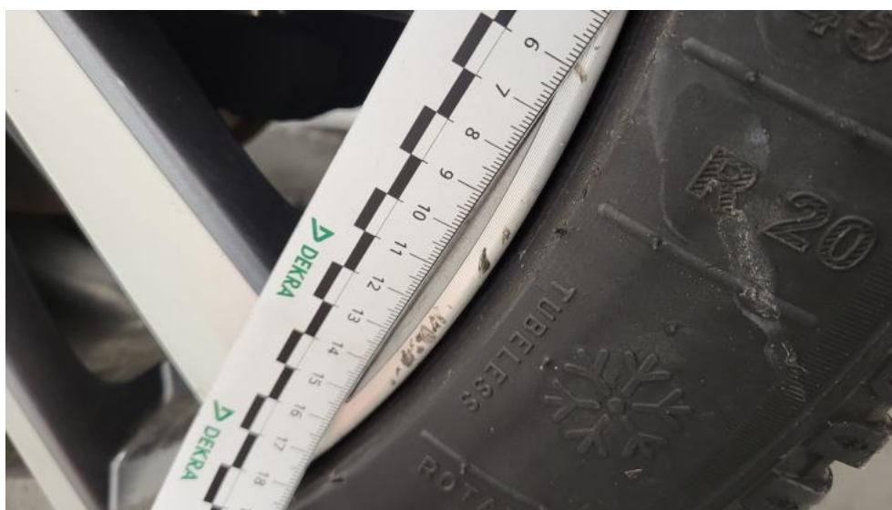
Fot. 44. Felga aluminiowa przednia P - Rysa/odprysk 1
