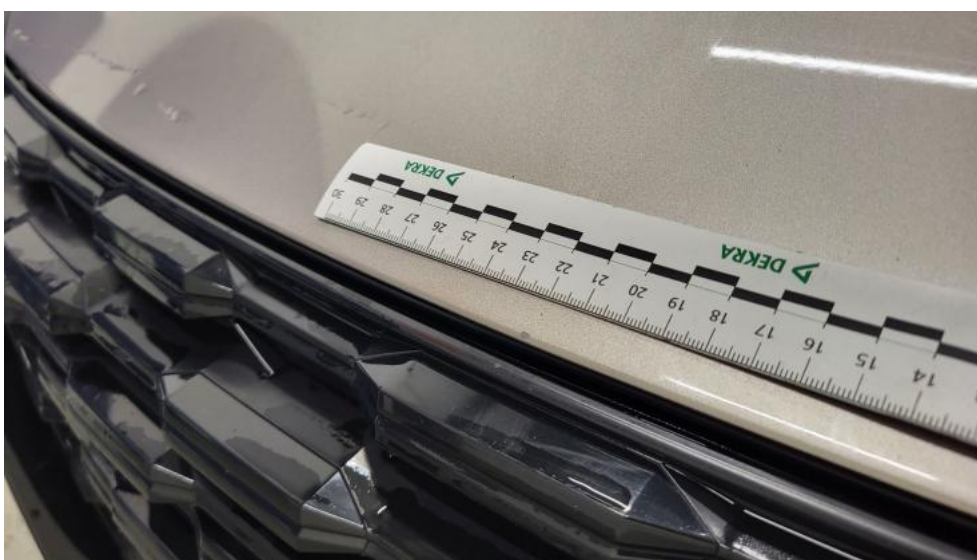
Fot. 40. Pokrywa komory silnika - Rysa/odprysk 1
