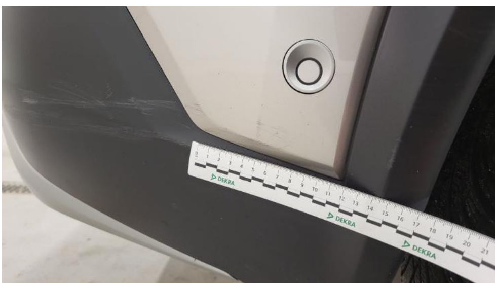
Fot. 52. Zderzak tylny cz P - Rysa/odprysk 1
