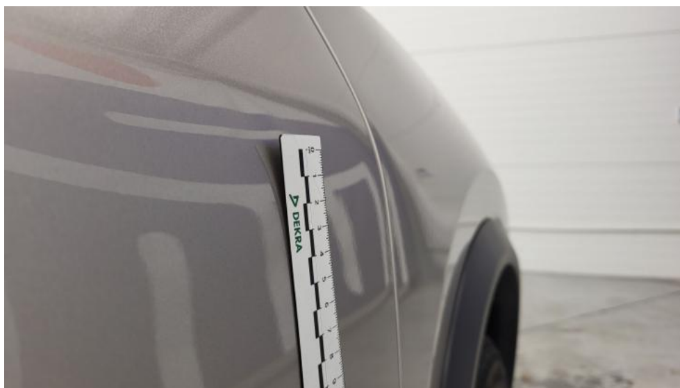
Fot. 45. Drzwi przednie P - Wgniecenie/odkształcenie 1
