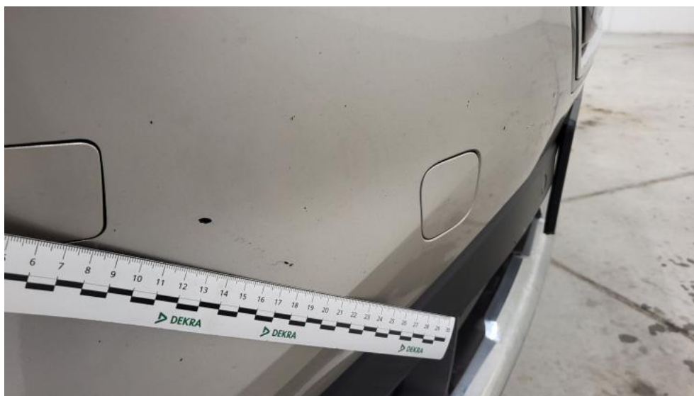
Fot. 43. Zderzak - Rysa/odprysk 2
