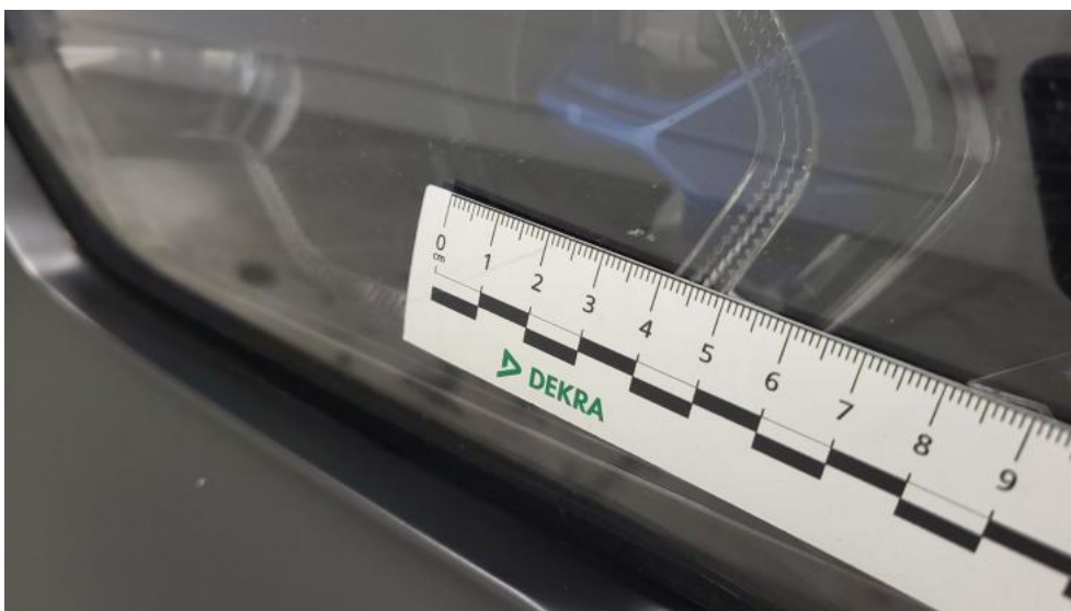
Photo 66. Reflektor L - Rysa/odprysk 1
