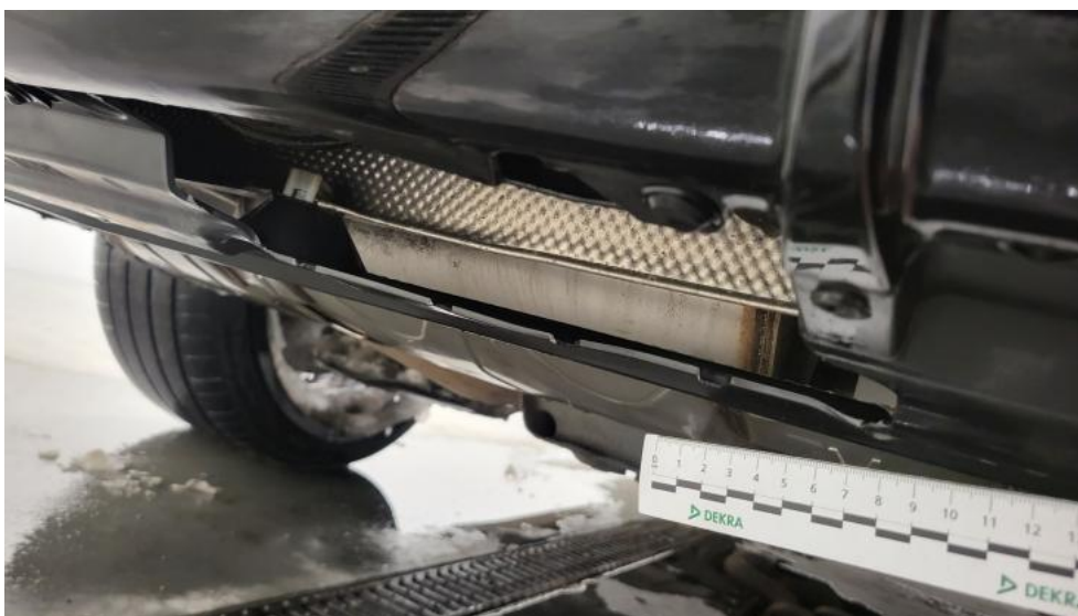
Photo 62. Spojler zderzaka tylnego - Pęknięcie/rozerwanie 1
