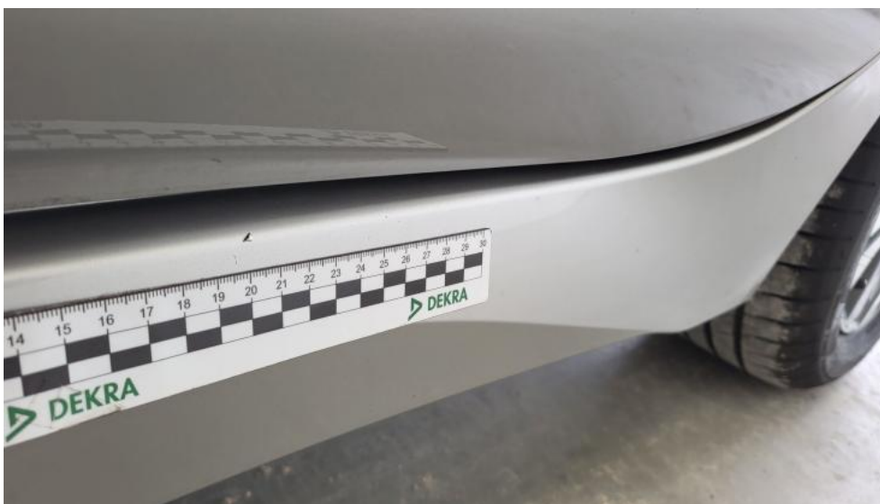
Fot. 67. Próg L - Rysa/odprysk 1
