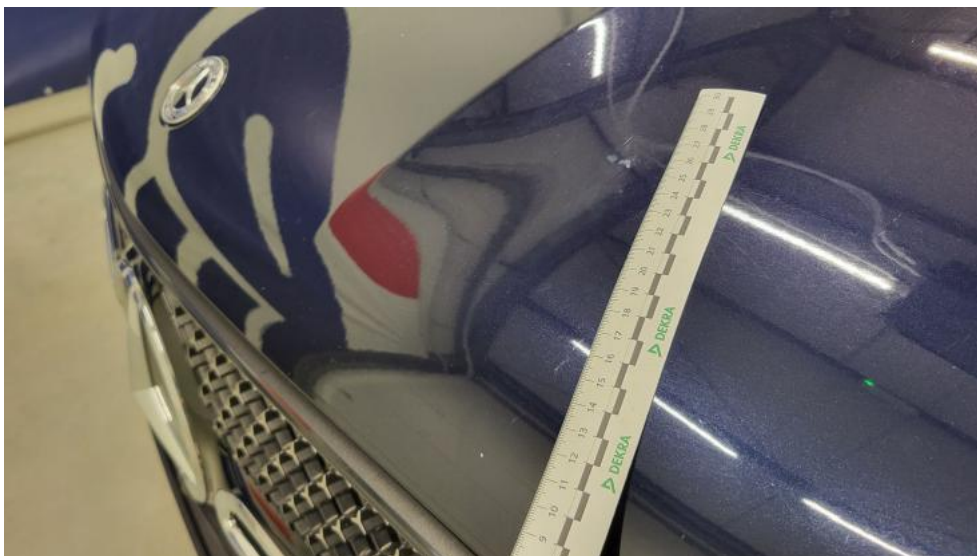
Fot. 42. Pokrywa komory silnika - Rysa/odprysk 1
