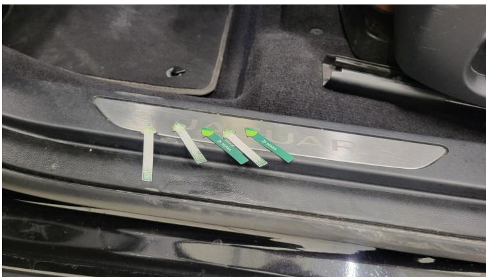
Photo 72. Listwy progowe lew. - Wgniecenie/odkształcenie 1
