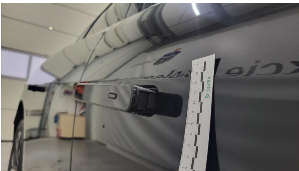
Photo 59. Drzwi przednie P - Wgniecenie/odkształcenie 2
