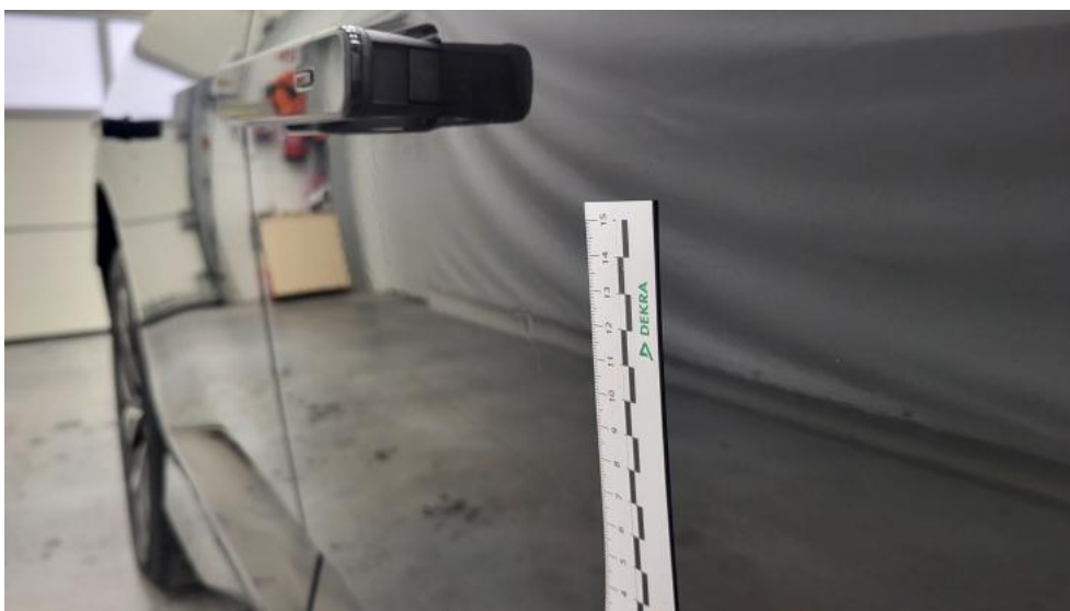
Photo 58. Drzwi przednie P - Wgniecenie/odkształcenie 1
