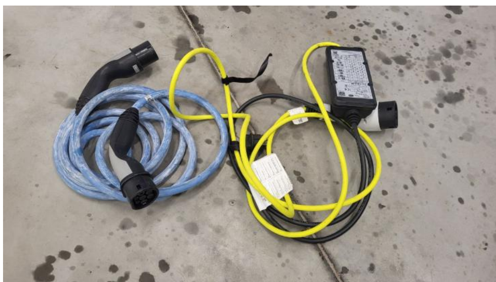
Photo 34. Przewód ładowania baterii trakcyjnej
