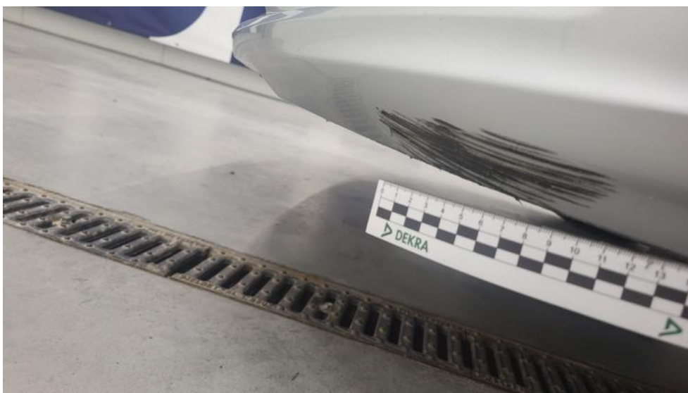
Fot. 38. Zderzak - Rysa/odprysk 1
