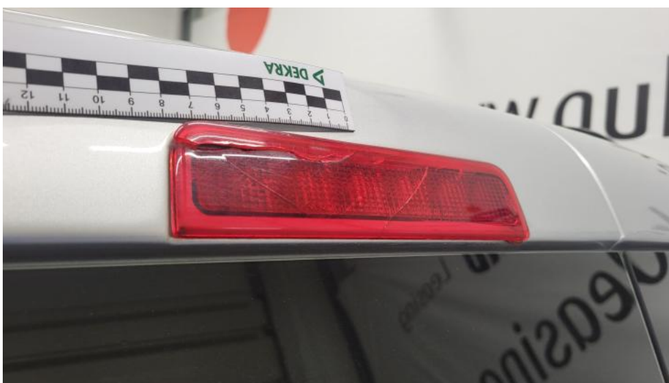
Fot. 52. Dodatkowa lampa stopu - Pęknięcie/rozerwanie 1
