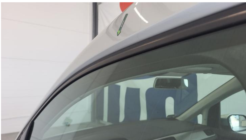
Fot. 66. Słupek przedni L - Wgniecenie/odkształcenie 1
