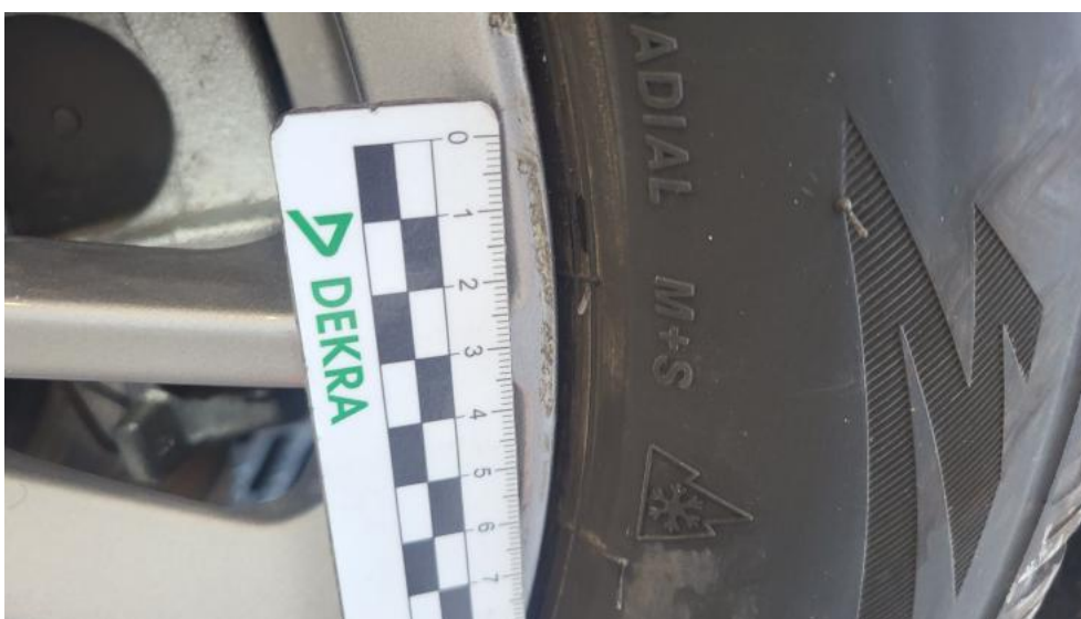
Fot. 42. Felga aluminiowa tylna L - Rysa/odprysk 1
