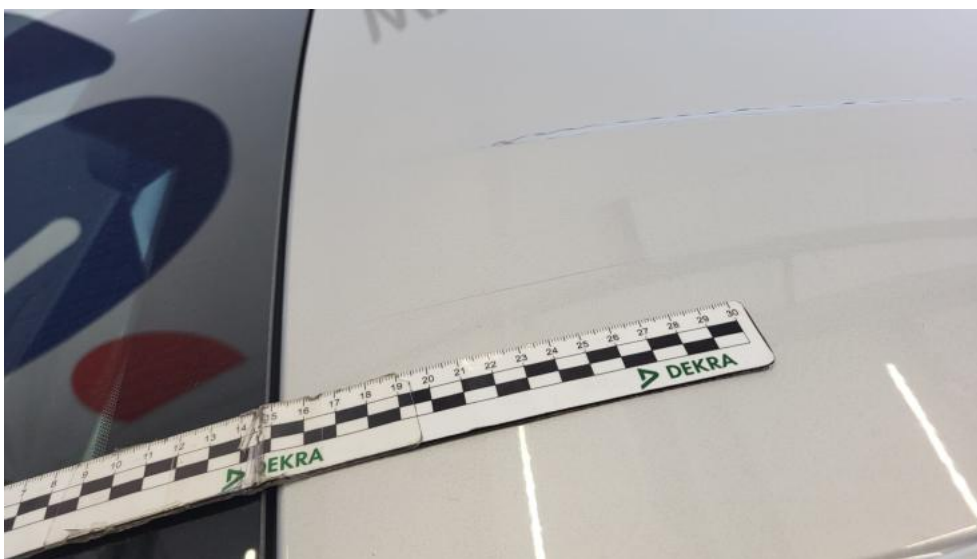
Fot. 41. Dach - Rysa/odprysk 2
