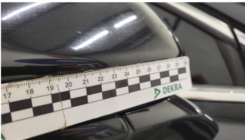
Photo 44. Lusterko zew P - Rysa/odprysk 1
