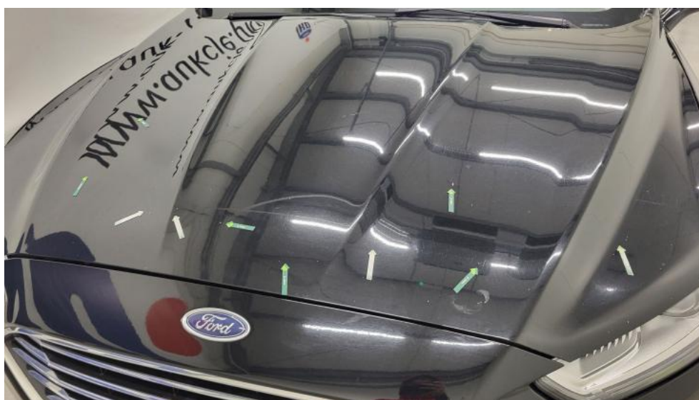
Photo 36. Pokrywa komory silnika - Rysa/odprysk 1
