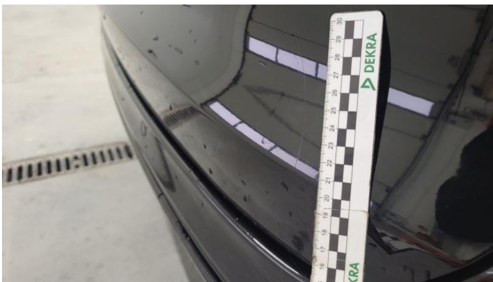
Photo 51. Pokrywy bagażnika - Rysa/odprysk 1
