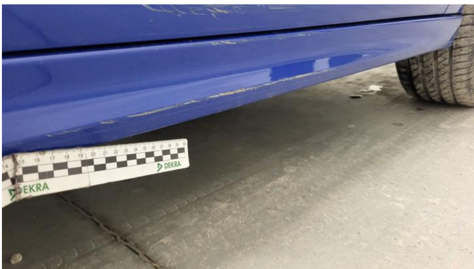
Fot. 52. Próg P - Rysa/odprysk 2
