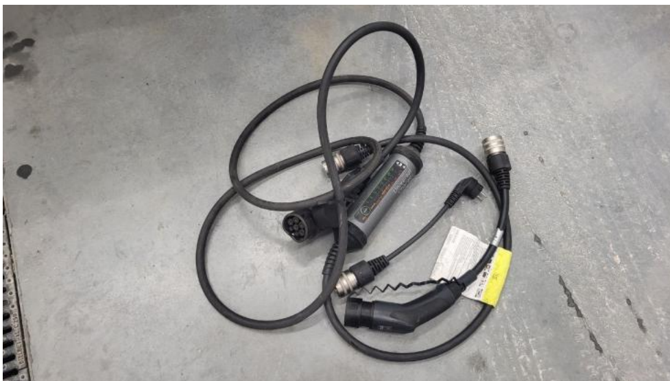
Fot. 30. Przewód ładowania baterii trakcyjnej
