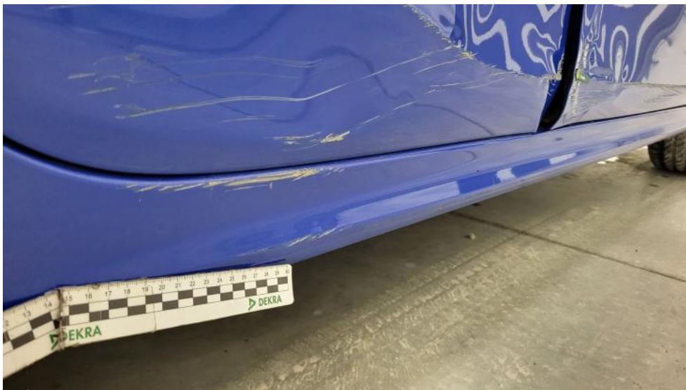
Fot. 51. Próg P - Rysa/odprysk 1
