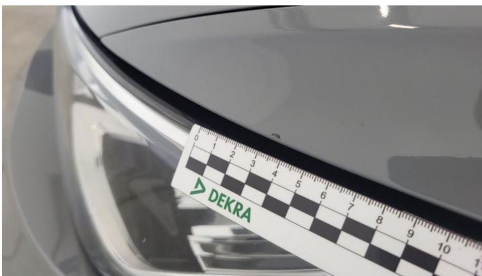
Fot. 58. Błotnik przedni L - Rysa/odprysk 1
