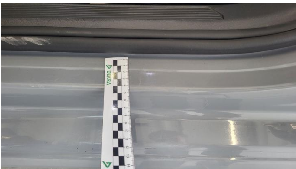
Fot. 57. Próg L - Rysa/odprysk 1
