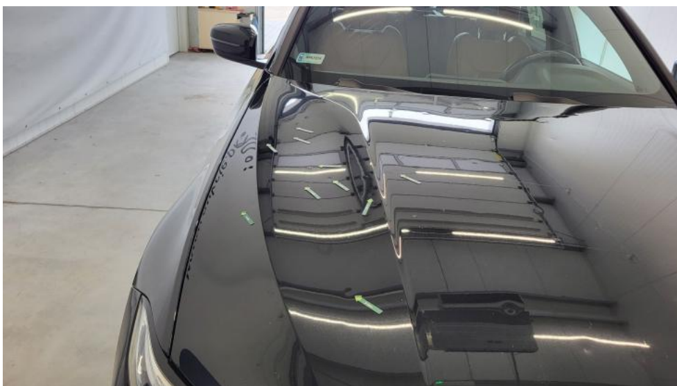
Fot. 42. Pokrywa komory silnika - Wgniecenie/odkształcenie 1
