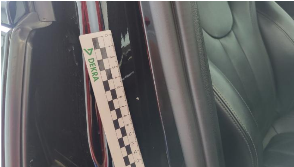
Fot. 51. Słupek środkowy P - Rysa/odprysk 1
