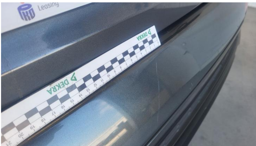
Fot. 56. Zderzak tylny - Rysa/odprysk 2
