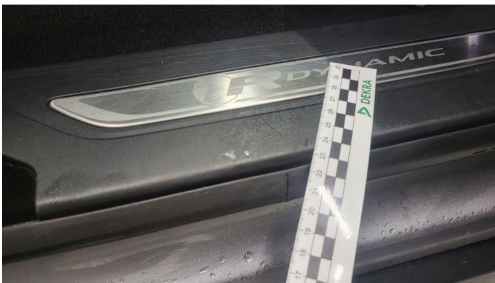
Photo 63. Próg P - Rysa/odprysk 1
