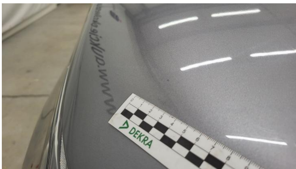
Photo 48. Pokrywa komory silnika() - Rysa/odprysk 3
