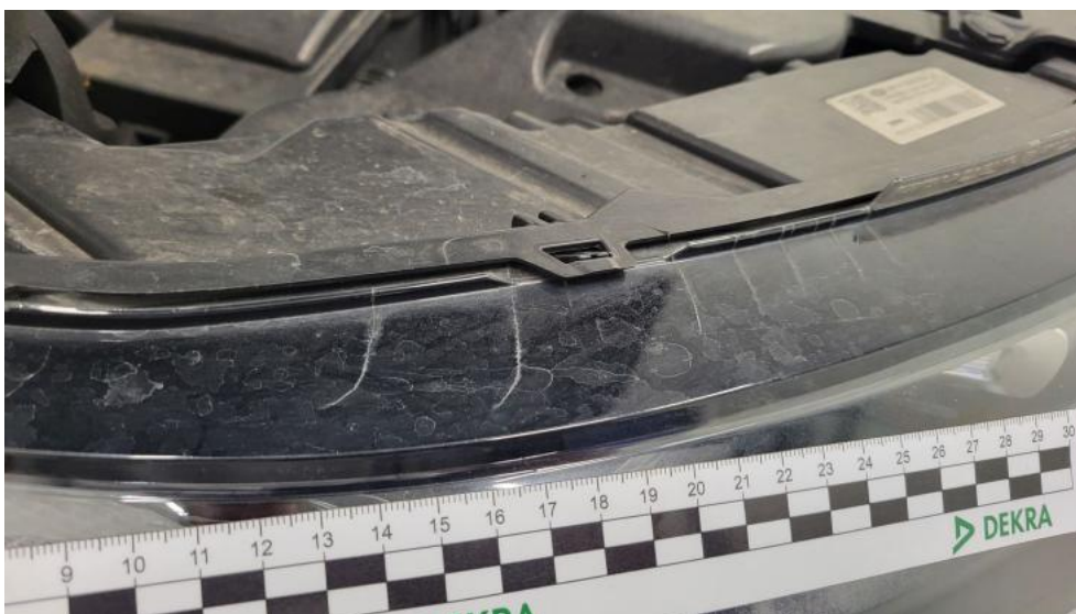
Photo 60. Reflektor P() - Pęknięcie/rozerwanie 3
