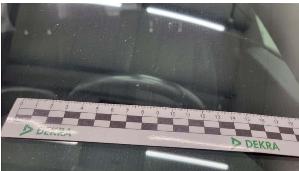
Photo 49. Szyba czołowa ogrzewana - Rysa/odprysk 1
