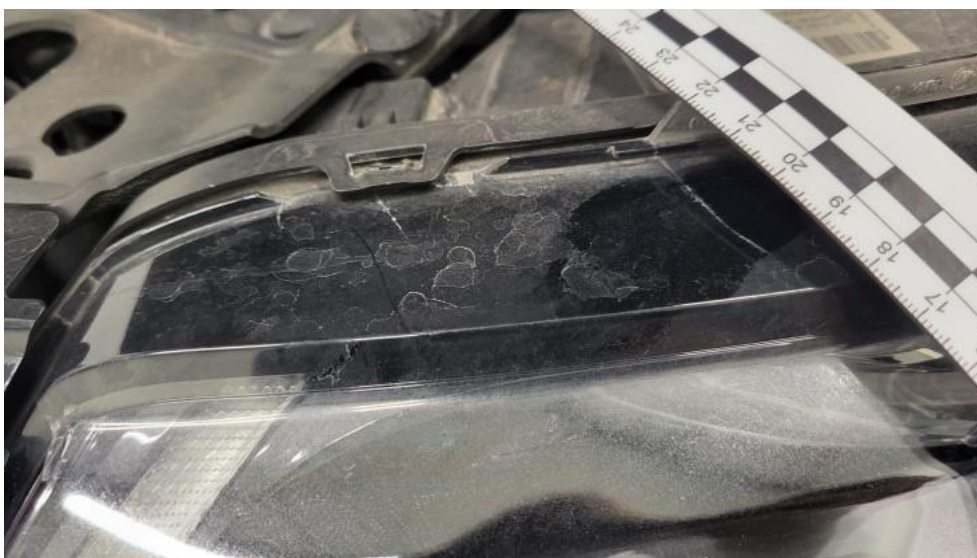
Photo 78. Reflektor L - Pęknięcie/rozerwanie 2
