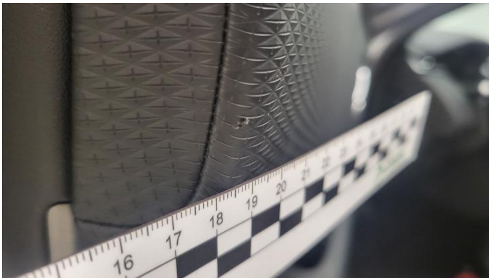
Photo 85. Tapicerka drzwi przednich L - Rysa/odprysk 1
