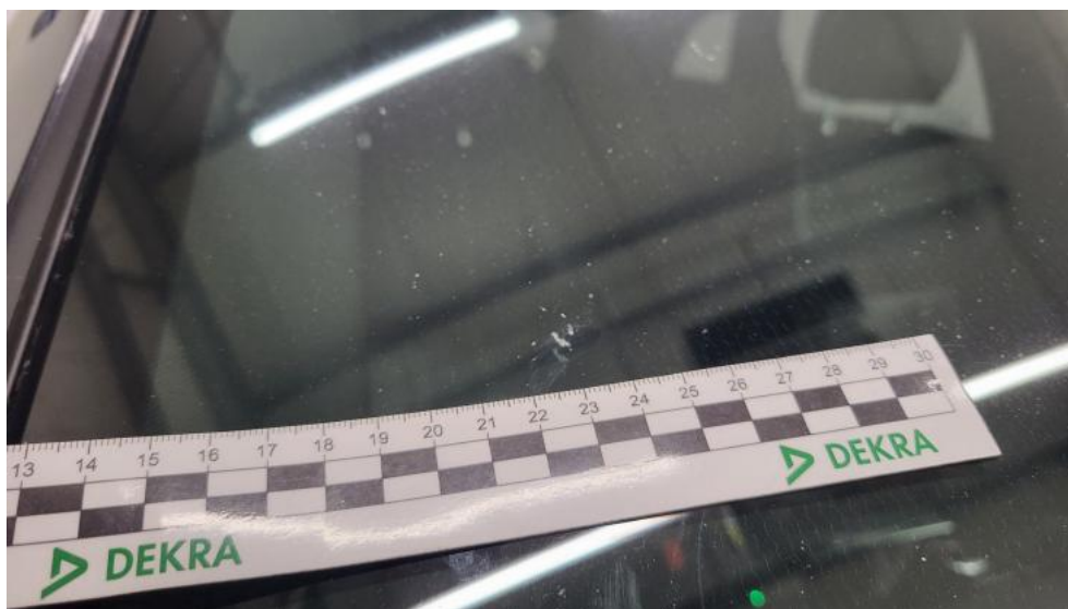
Photo 51. Szyba czołowa ogrzewana() - Rysa/odprysk 3
