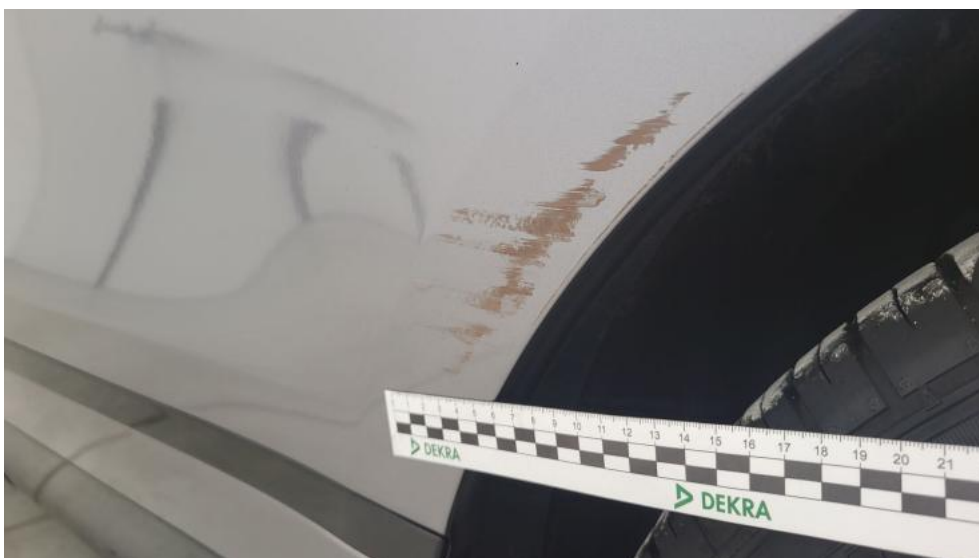
Photo 74. Drzwi tylne L - Rysa/odprysk 1
