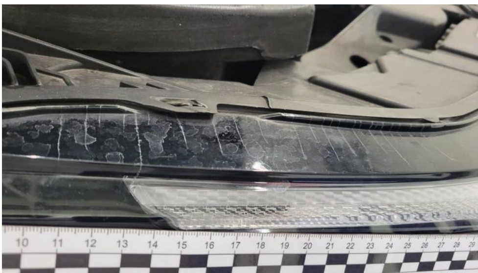
Photo 59. Reflektor P - Pęknięcie/rozerwanie 2
