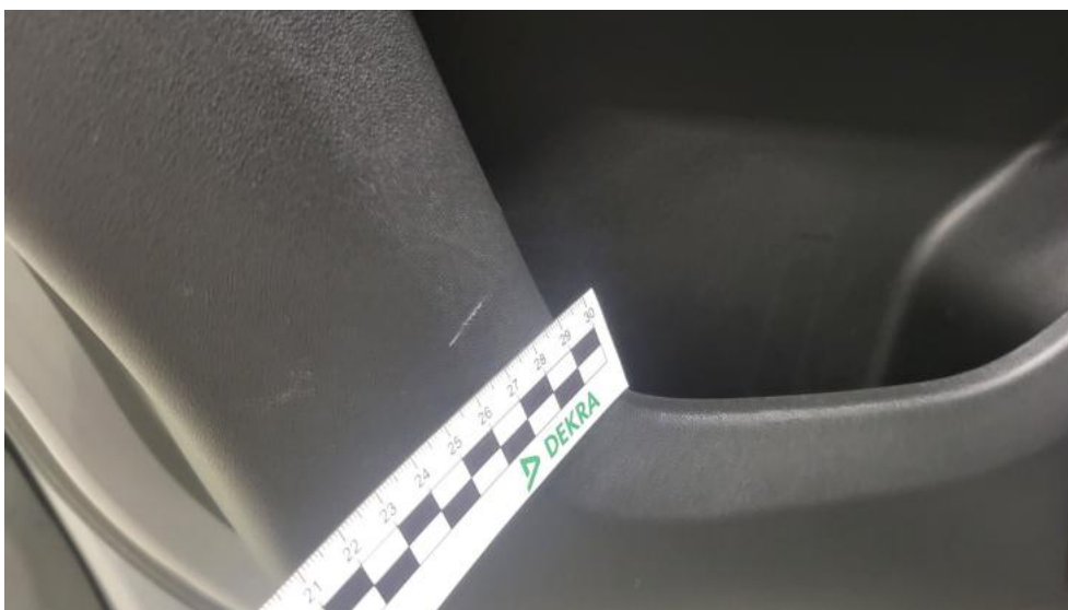
Photo 86. Tapicerka drzwi tylnych L - Rysa/odprysk 1
