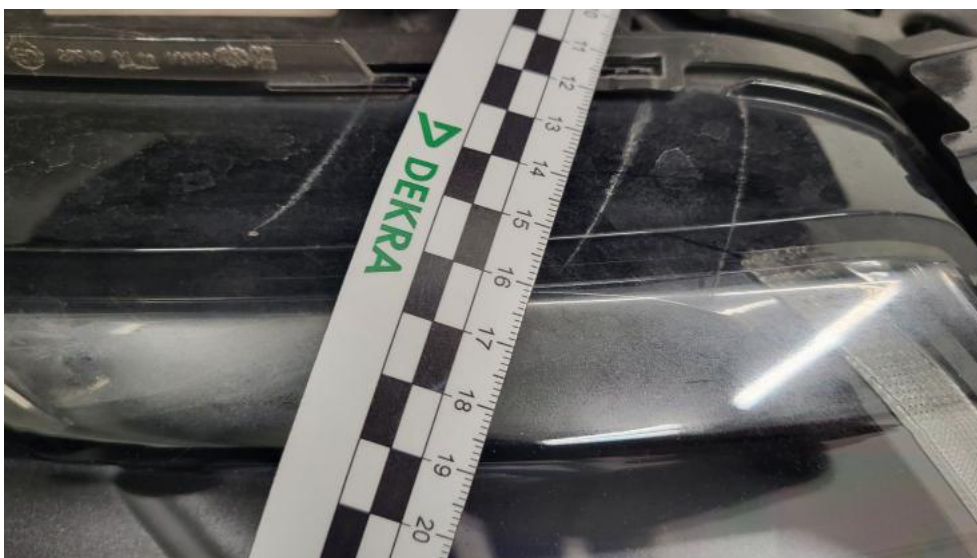
Photo 58. Reflektor P - Pęknięcie/rozerwanie 1
