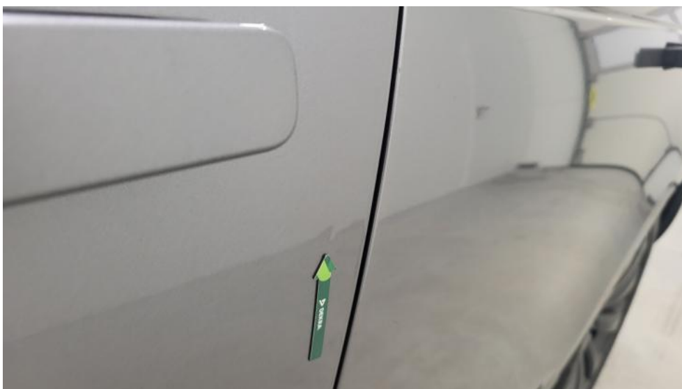
Photo 73. Drzwi przed L - Wgniecenie/odkształcenie 1
