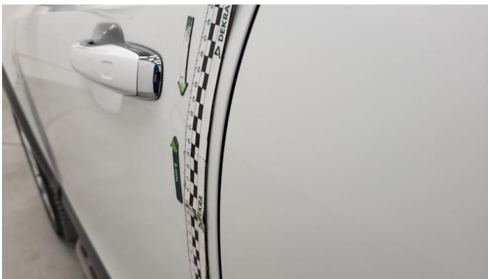
Fot. 73. Drzwi przed L - Wgniecenie/odkształcenie 1
