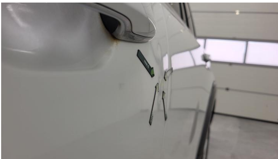
Fot. 75. Drzwi przed L() - Wgniecenie/odkształcenie 3
