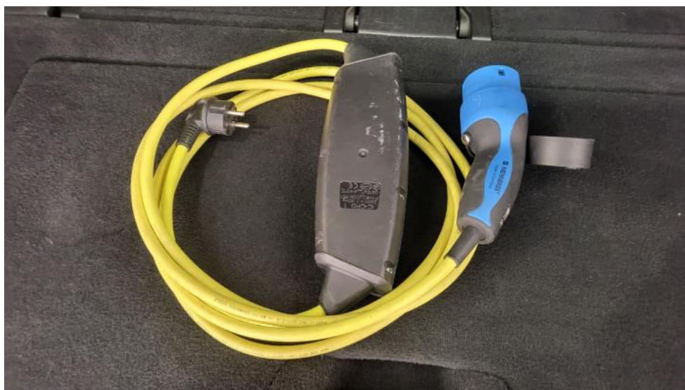
Fot. 34. Przewód ładowania baterii trakcyjnej
