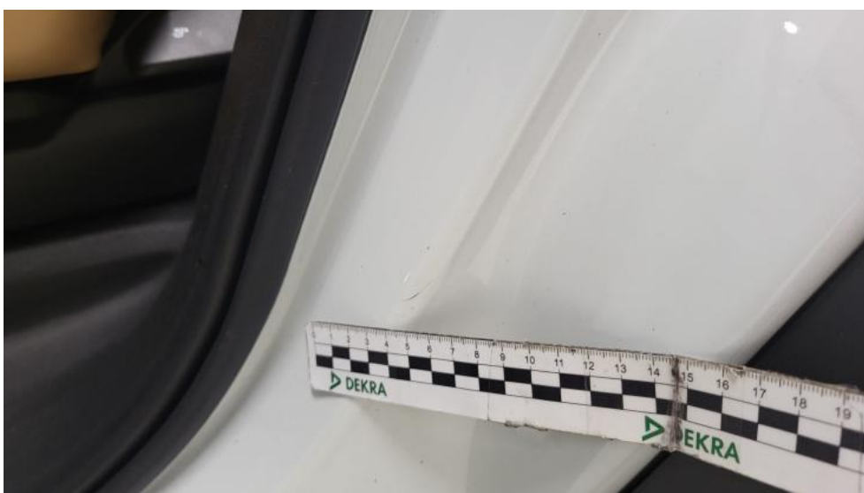
Fot. 70. Błotnik tylny L / Ściana boczna L - Rysa/odprysk 2
