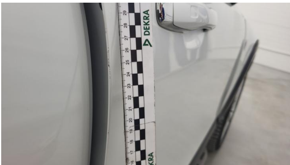
Fot. 56. Drzwi przednie P - Rysa/odprysk 1
