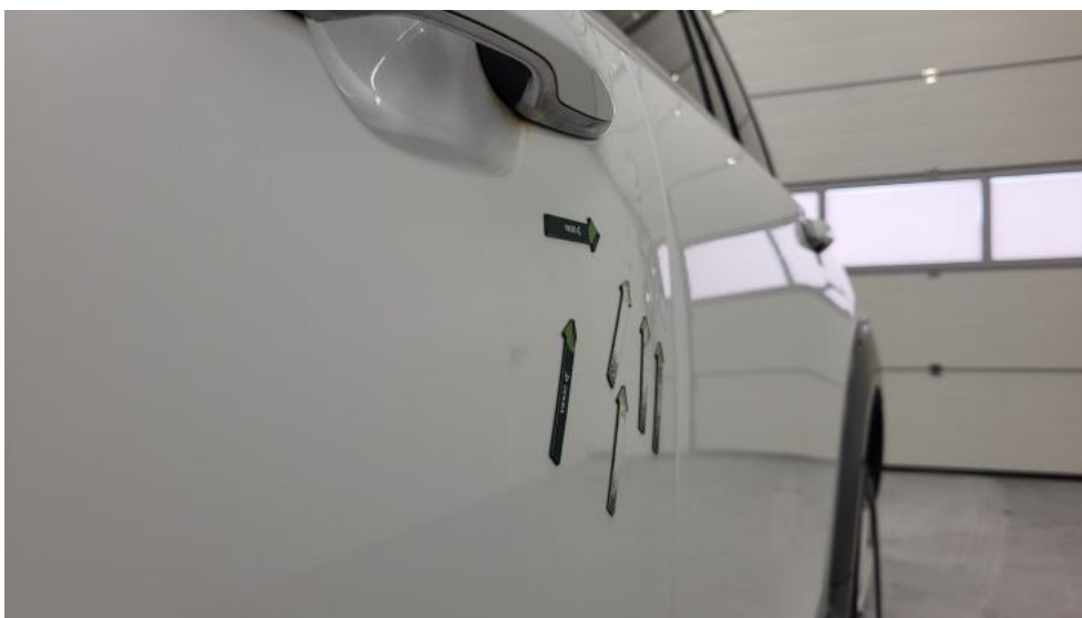
Fot. 74. Drzwi przed L - Wgniecenie/odkształcenie 2
