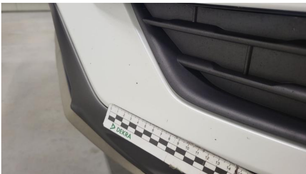
Fot. 54. Zderzak - Rysa/odprysk 1
