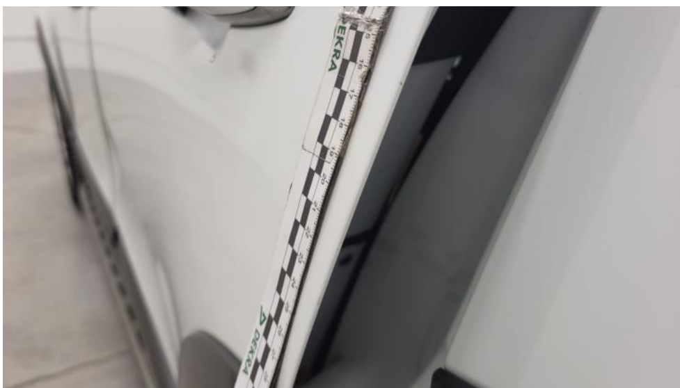
Fot. 76. Drzwi tylne L - Rysa/odprysk 1
