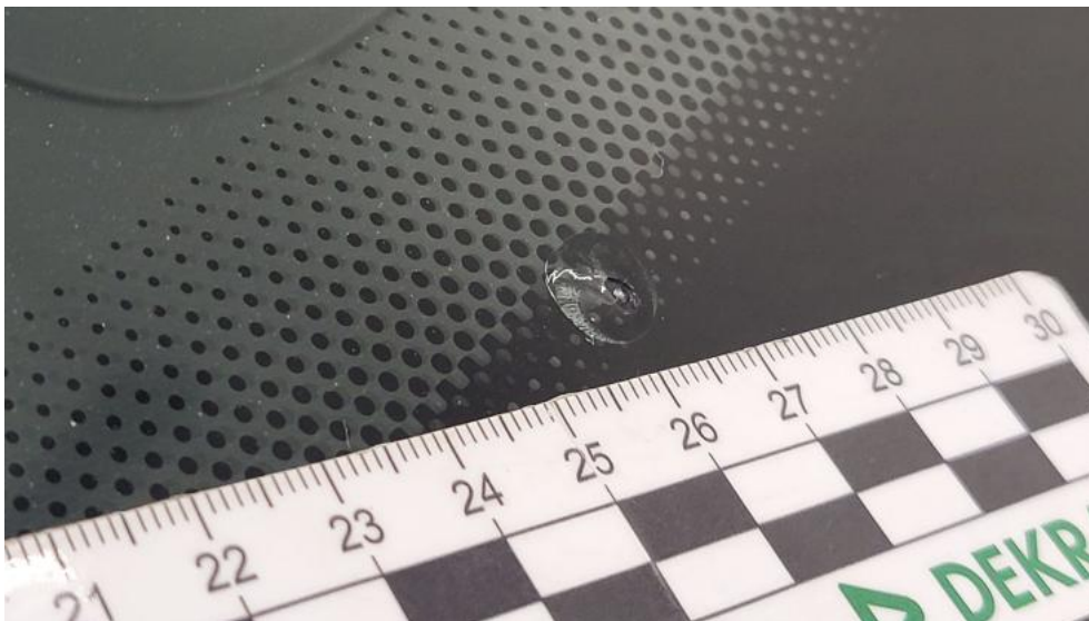
Fot. 53. Szyba czołowa - Pęknięcie/rozerwanie 2
