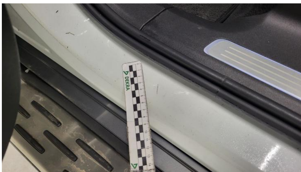
Fot. 78. Próg L - Rysa/odprysk 1
