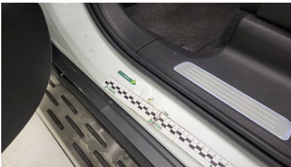
Fot. 79. Próg L - Wgniecenie/odkształcenie 1
