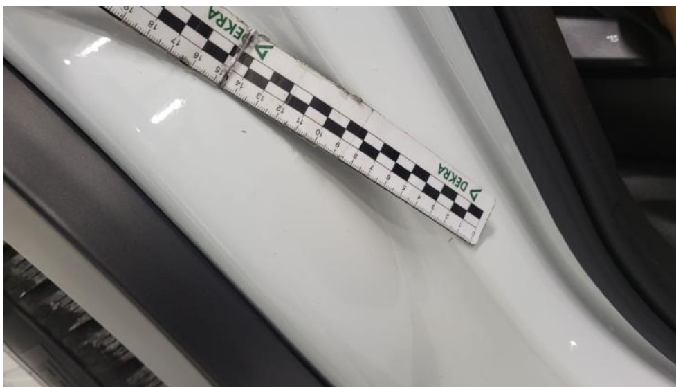
Fot. 59. Błotnik tylny P / Ściana boczna P - Rysa/odprysk 1
