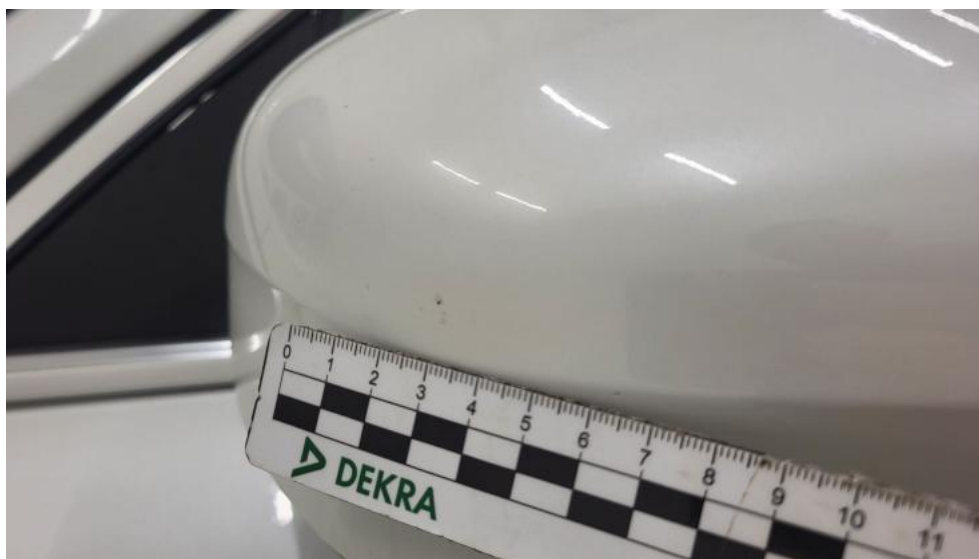
Fot. 77. Lusterko zew L - Rysa/odprysk 1
