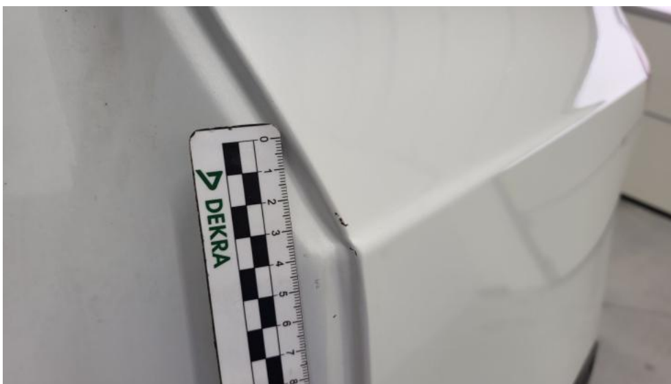
Fot. 69. Błotnik tylny L / Ściana boczna L - Rysa/odprysk 1
