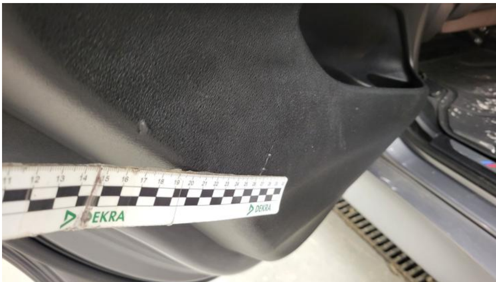
Fot. 83. Tapicerka drzwi tylnych L - Wgniecenie/odkształcenie 1
