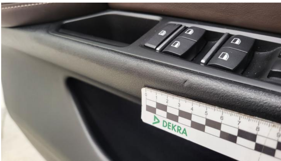
Fot. 81. Tapicerka drzwi przednich L - Wgniecenie/odkształcenie 1
