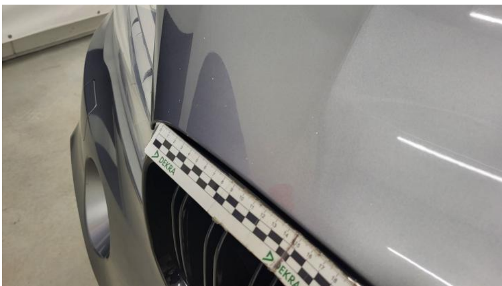
Fot. 42. Pokrywa komory silnika - Rysa/odprysk 2
