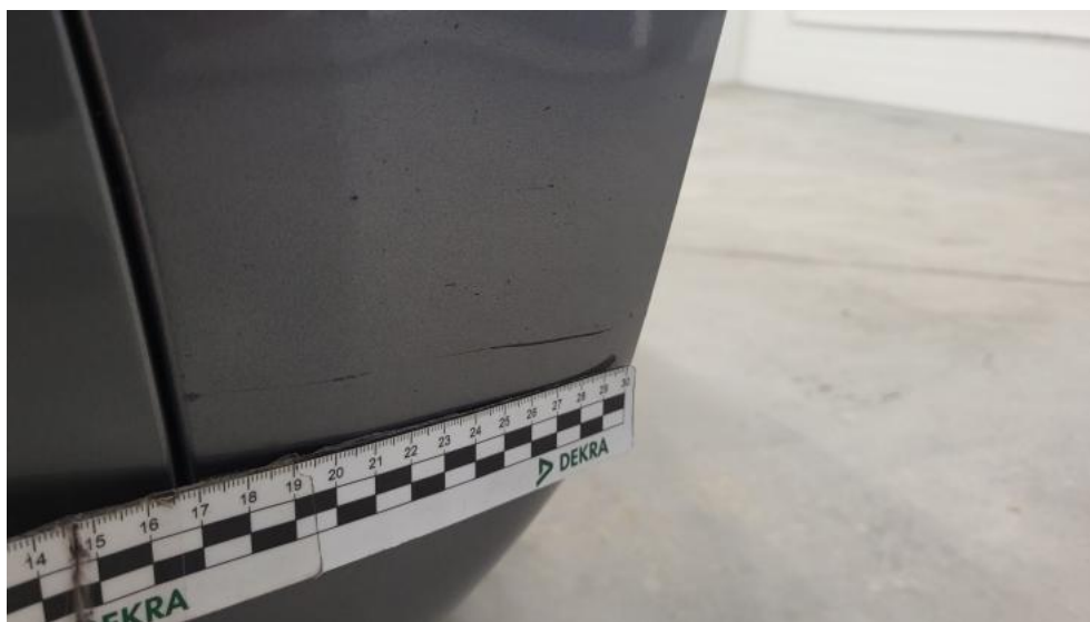
Fot. 49. Zderzak() - Rysa/odprysk 3
