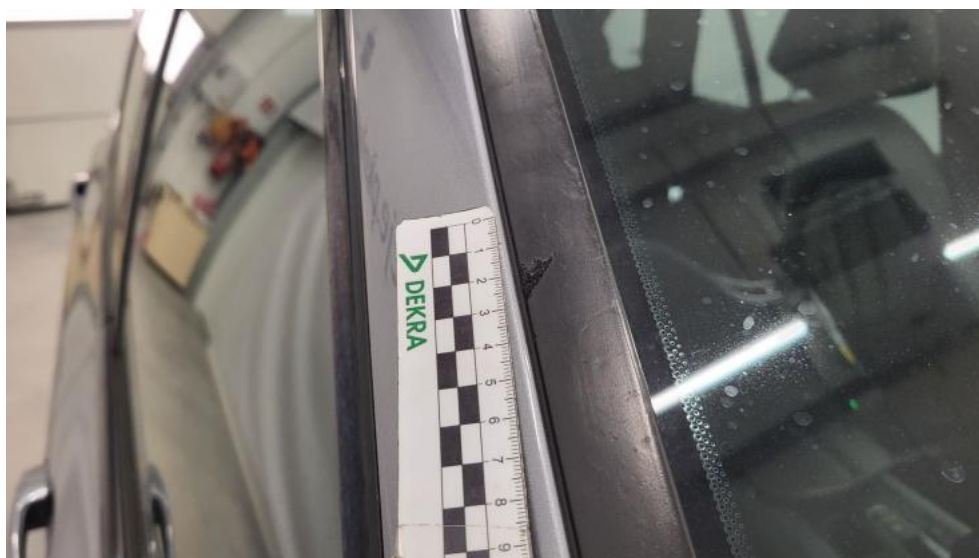
Fot. 46. Uszczelka/listwa szyby czołowej - Rysa/odprysk 1
