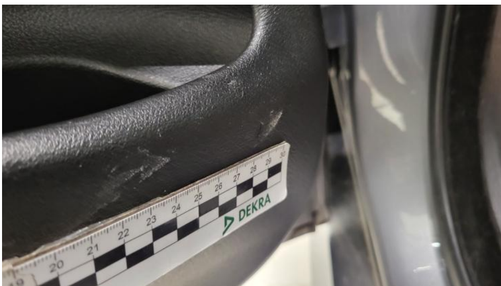
Fot. 84. Tapicerka drzwi tylnych L - Wgniecenie/odkształcenie 2
