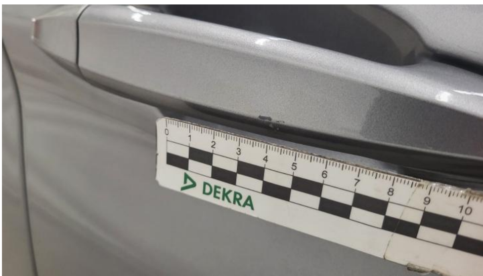
Fot. 55. Klamka drzwi prz P - Rysa/odprysk 1
