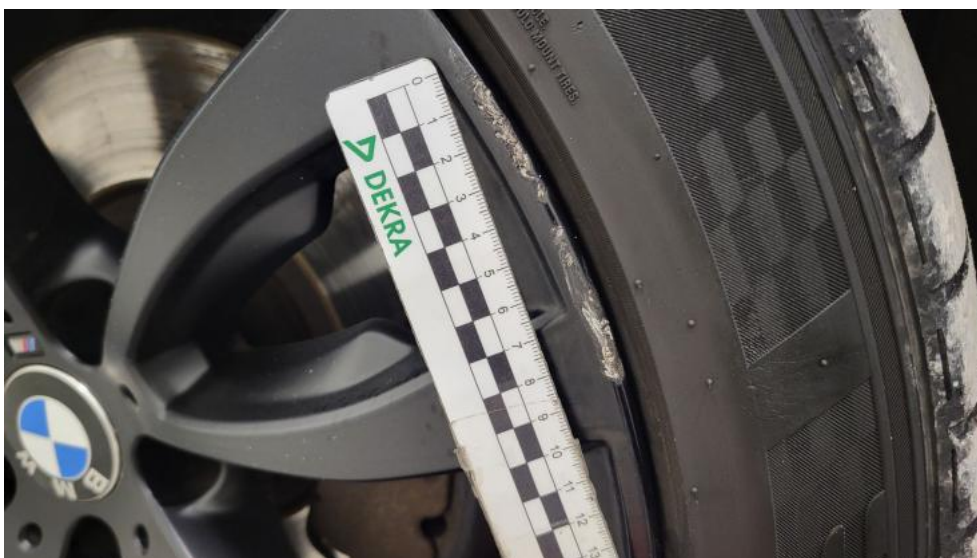
Fot. 74. Felga przednia L - Rysa/odprysk 1
