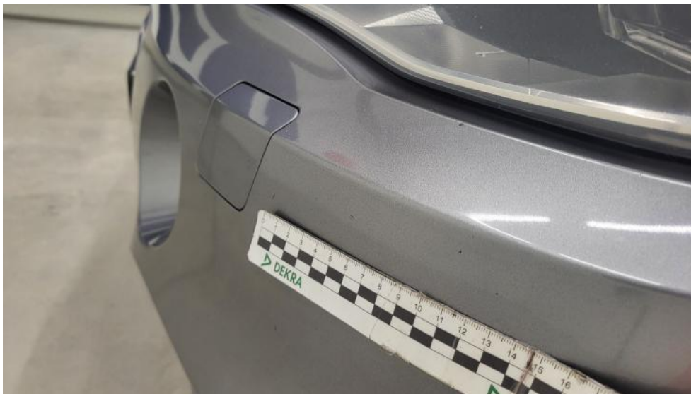
Fot. 47. Zderzak - Rysa/odprysk 1
