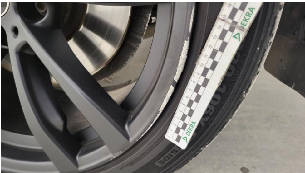
Fot. 51. Felga aluminiowa przednia P - Rysa/odprysk 2
