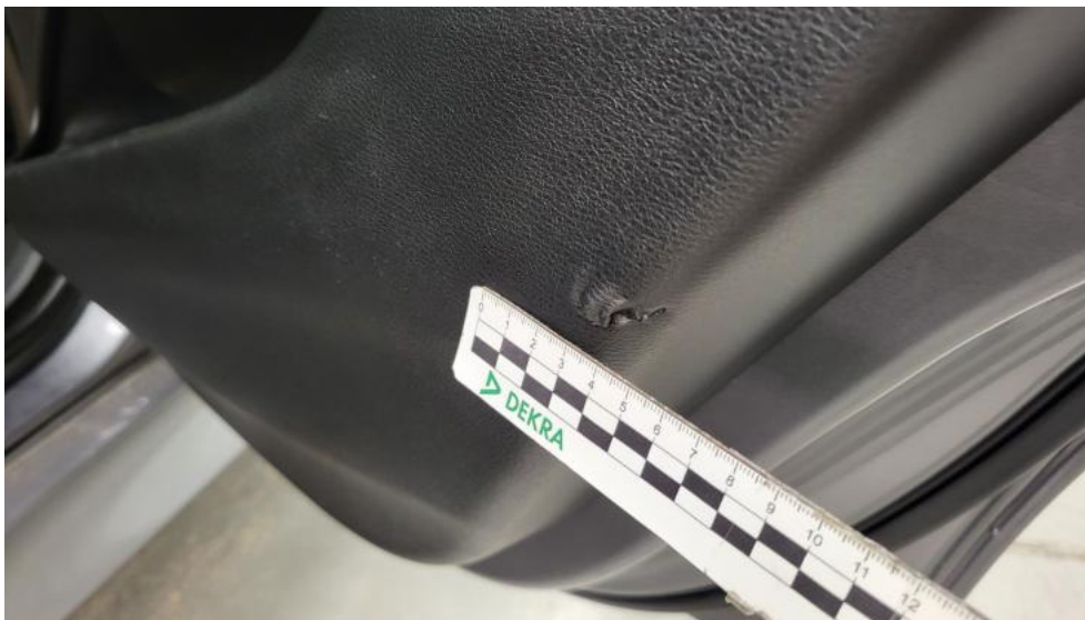
Fot. 85. Tapicerka drzwi tylnych P - Wgniecenie/odkształcenie 1
