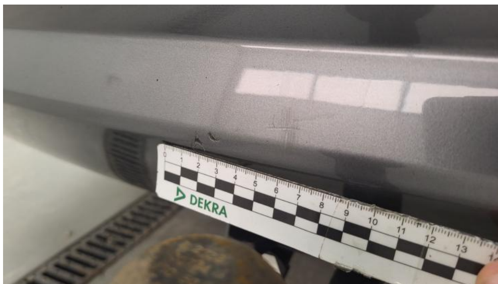
Fot. 61. Zderzak tylny - Rysa/odprysk 1
