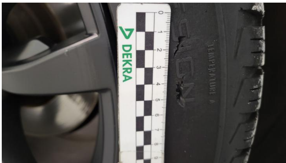
Fot. 58. Opona tylna P - Pęknięcie/rozerwanie 1
