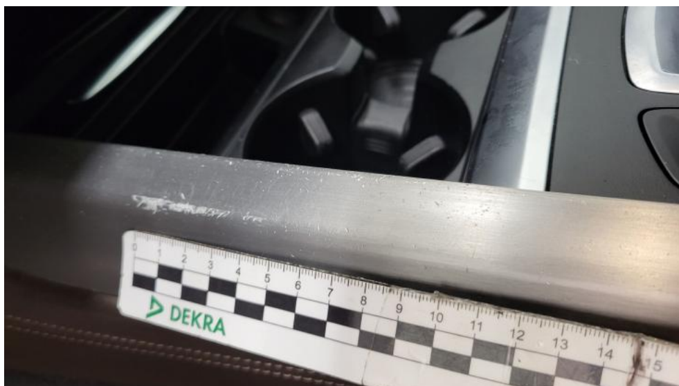
Fot. 77. Konsola środkowa - Rysa/odprysk 1
