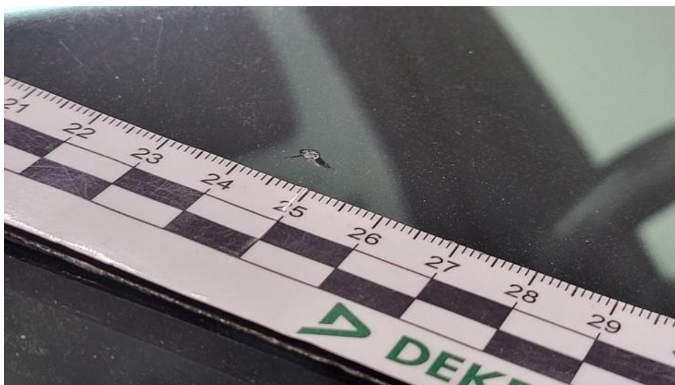
Fot. 45. Szyba czołowa - Pęknięcie/rozerwanie 2
