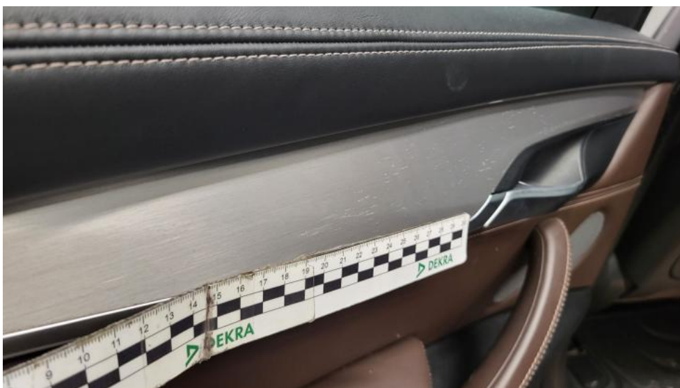
Fot. 82. Tapicerka drzwi tylnych L - Rysa/odprysk 1
