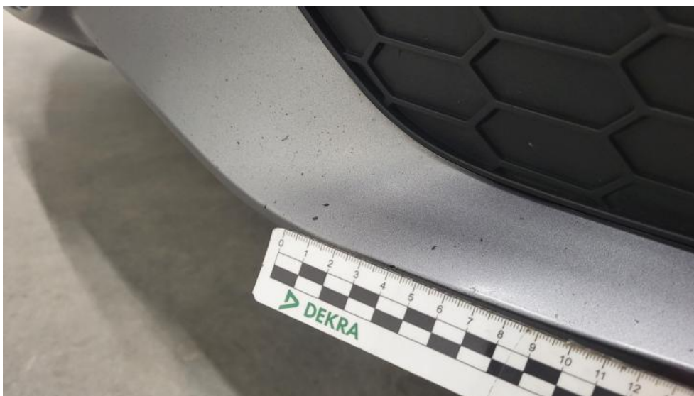
Fot. 48. Zderzak - Rysa/odprysk 2
