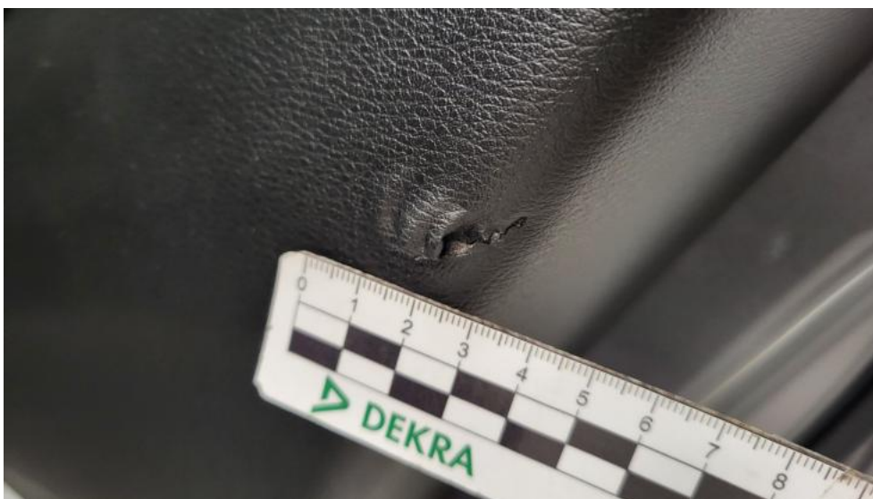
Fot. 86. Tapicerka drzwi tylnych P - Pęknięcie/rozerwanie 1
