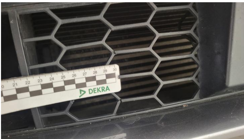
Fot. 40. Kratka zderzaka prz. - Pęknięcie/rozerwanie 1
