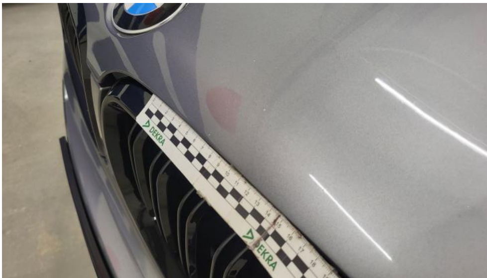
Fot. 41. Pokrywa komory silnika - Rysa/odprysk 1
