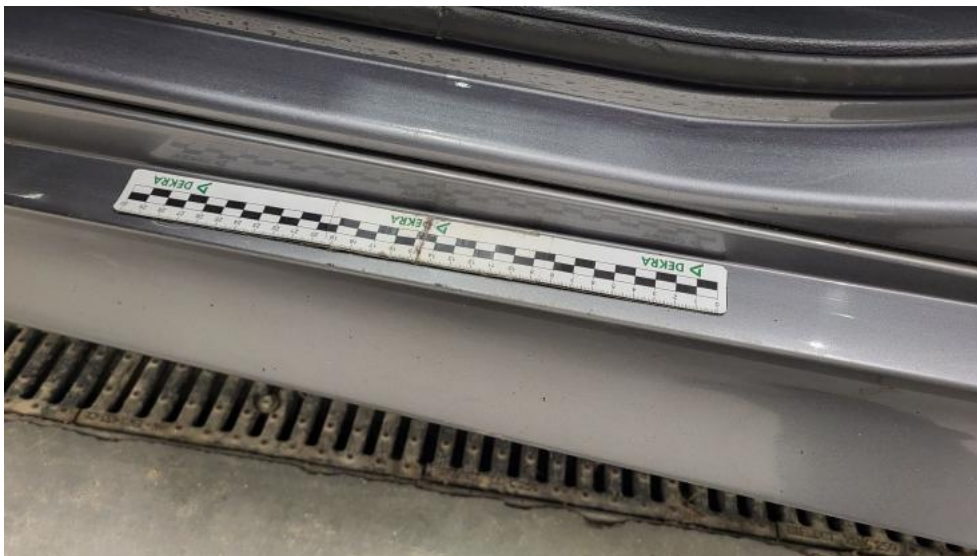
Fot. 71. Próg L - Rysa/odprysk 1
