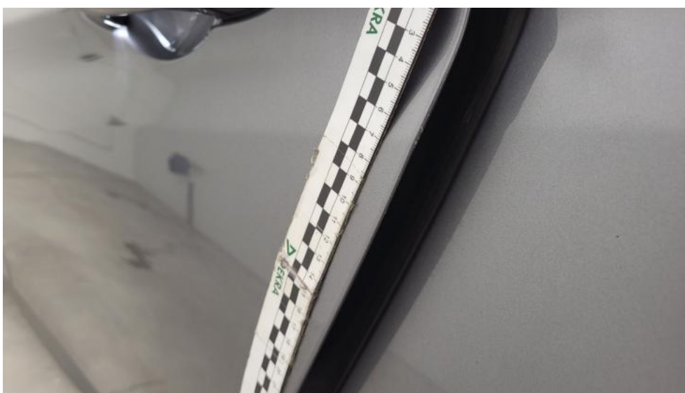
Fot. 70. Drzwi tylne L - Rysa/odprysk 1
