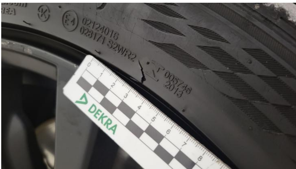
Fot. 52. Opona przednia P - Pęknięcie/rozerwanie 1
