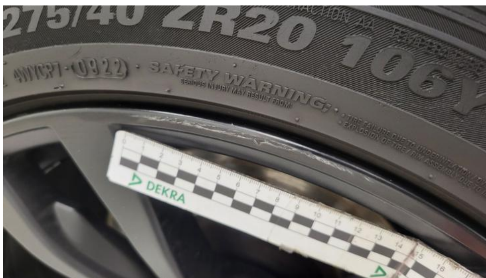
Fot. 75. Felga przednia L - Rysa/odprysk 2
