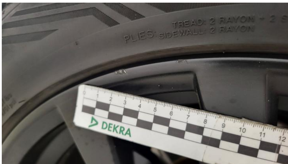
Fot. 57. Felga aluminiowa tylna P - Rysa/odprysk 1
