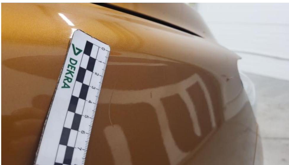
Fot. 64. Błotnik przedni P - Rysa/odprysk 2
