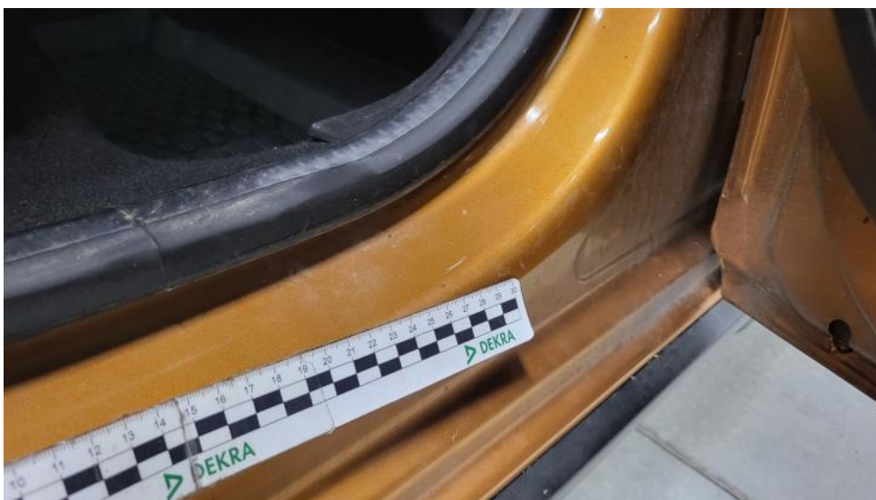
Fot. 76. Próg P - Rysa/odprysk 2
