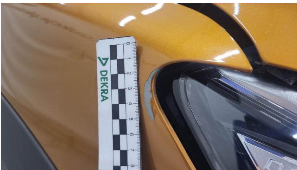
Fot. 63. Błotnik przedni P - Rysa/odprysk 1
