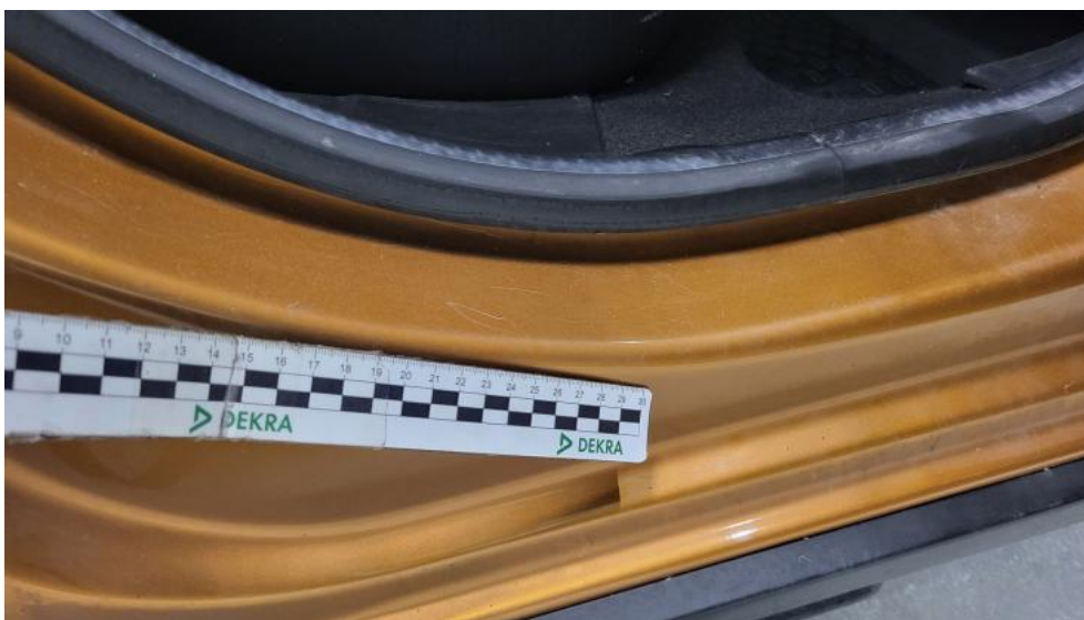
Fot. 75. Próg P - Rysa/odprysk 1
