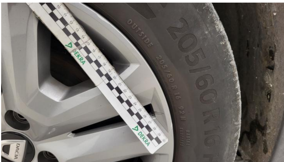
Fot. 106. Kołpak przedni L - Rysa/odprysk 1
