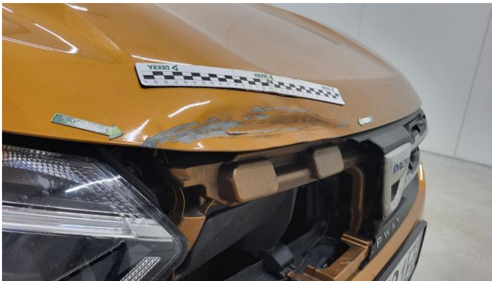
Fot. 49. Pokrywa komory silnika - Wgniecenie/odkształcenie 1
