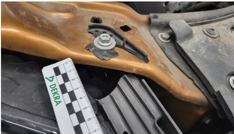
Fot. 71. Reflektor P - Pęknięcie/rozerwanie 2
