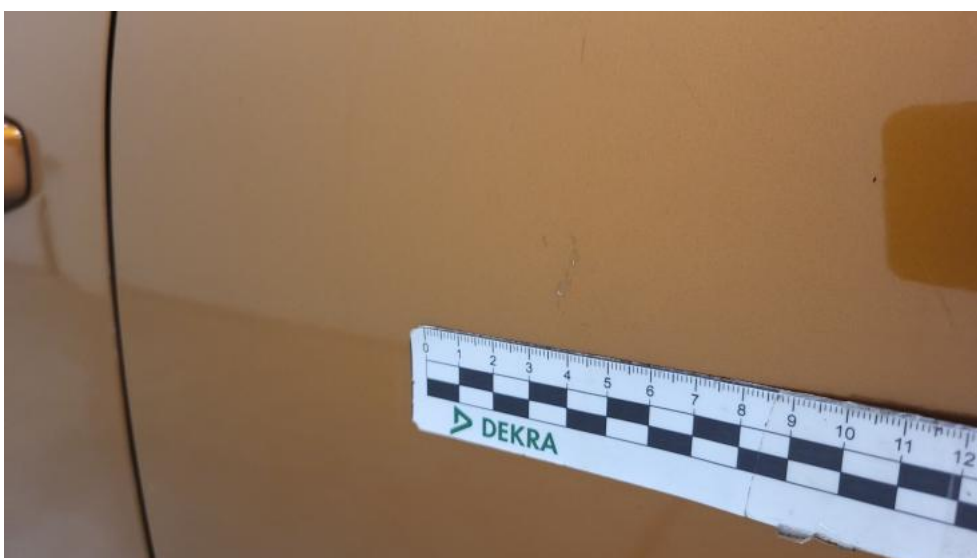
Fot. 104. Drzwi tylne L() - Rysa/odprysk 3
