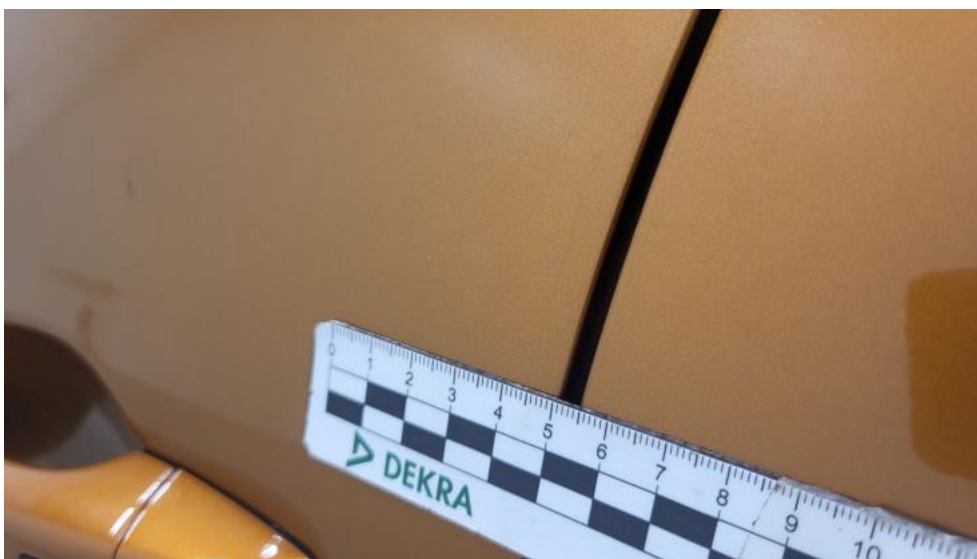
Fot. 99. Drzwi przed L - Rysa/odprysk 2
