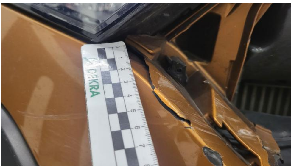
Fot. 60. Zderzak() - Pęknięcie/rozerwanie 3
