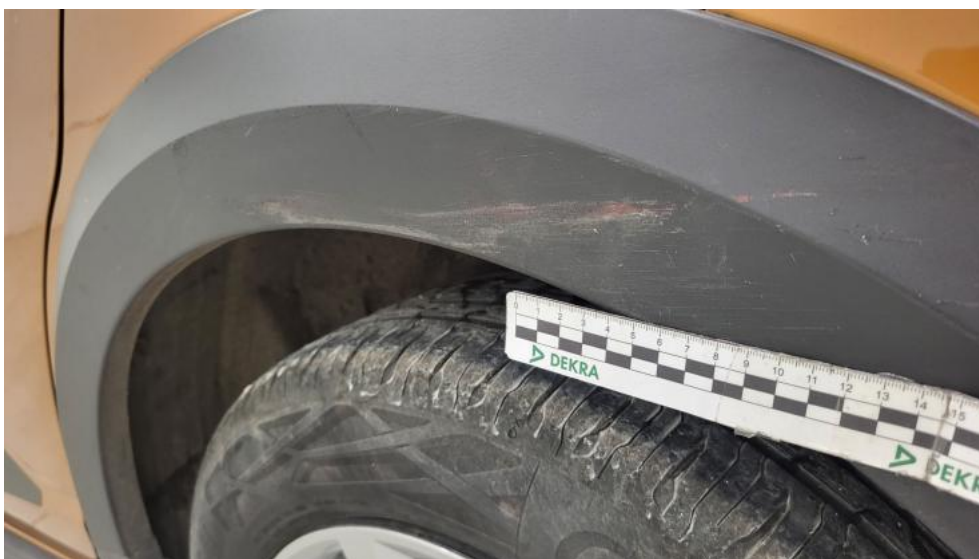
Fot. 97. Listwa krawędzi błotnika tył L - Rysa/odprysk 2
