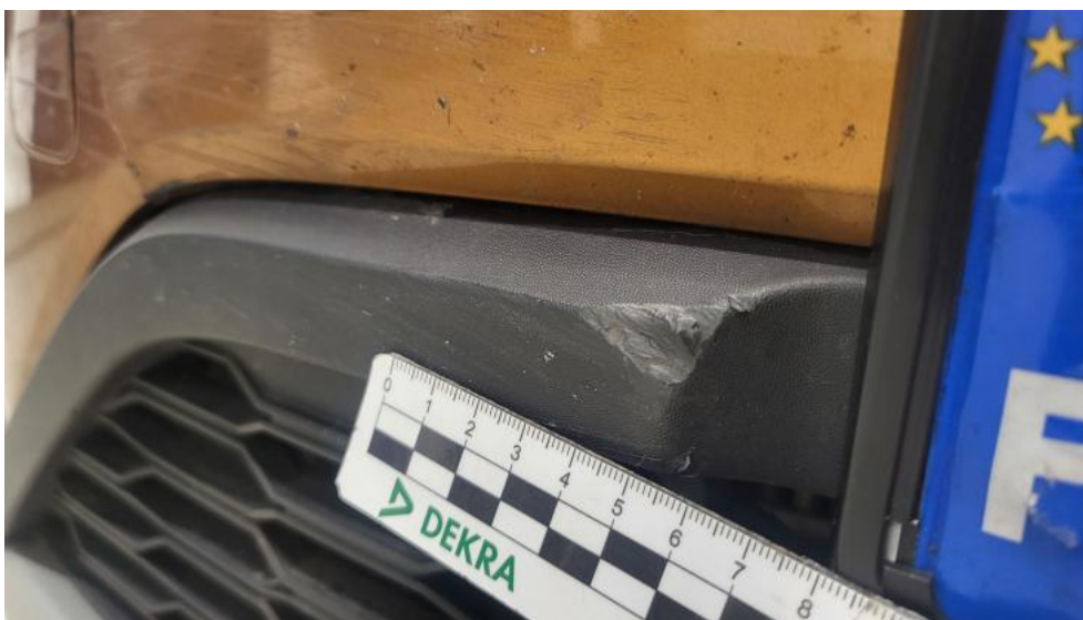
Fot. 61. Zderzak przedni cz dolna - Rysa/odprysk 1
