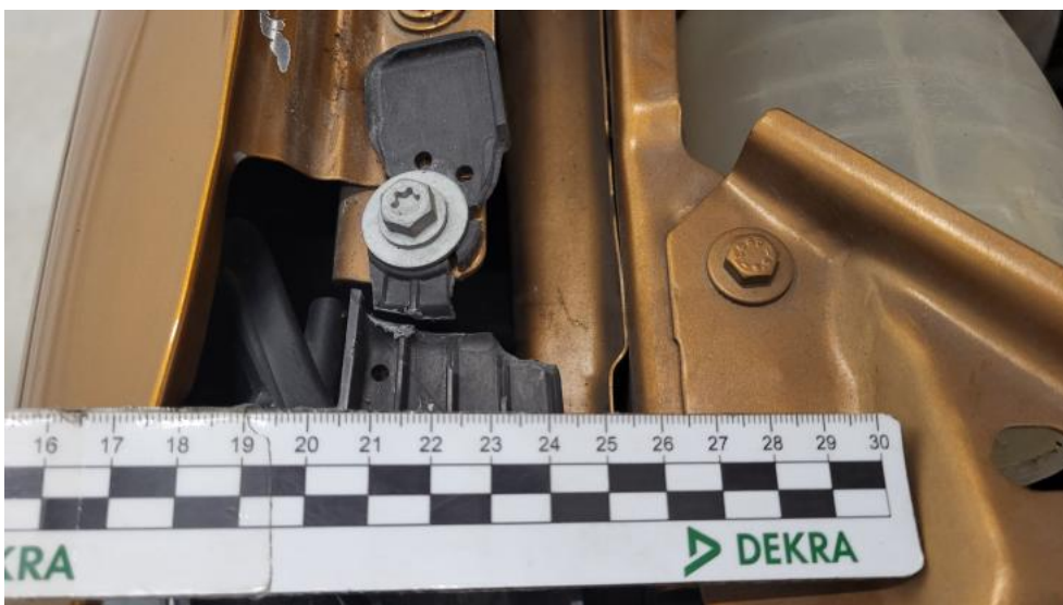
Fot. 70. Reflektor P - Pęknięcie/rozerwanie 1
