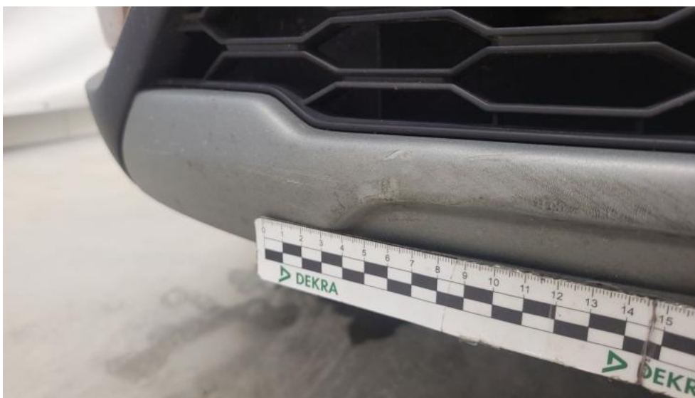
Fot. 53. Spoiler zderzaka przedniego - Rysa/odprysk 2
