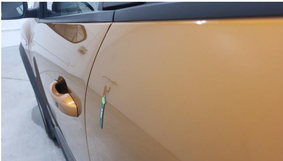
Fot. 105. Drzwi tylne L - Wgniecenie/odkształcenie 1
