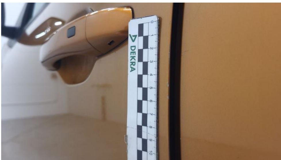
Fot. 100. Drzwi przed L() - Rysa/odprysk 3
