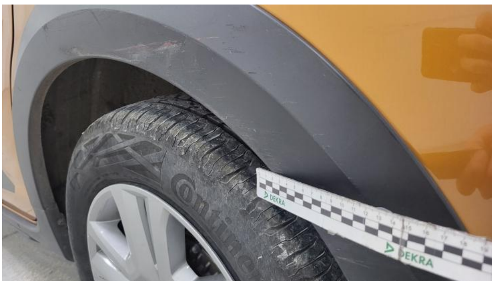
Fot. 96. Listwa krawędzi błotnika tyl L - Rysa/odprysk 1
