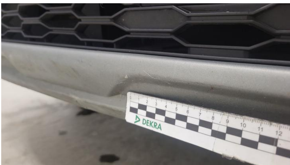
Fot. 52. Spoiler zderzaka przedniego - Rysa/odprysk 1
