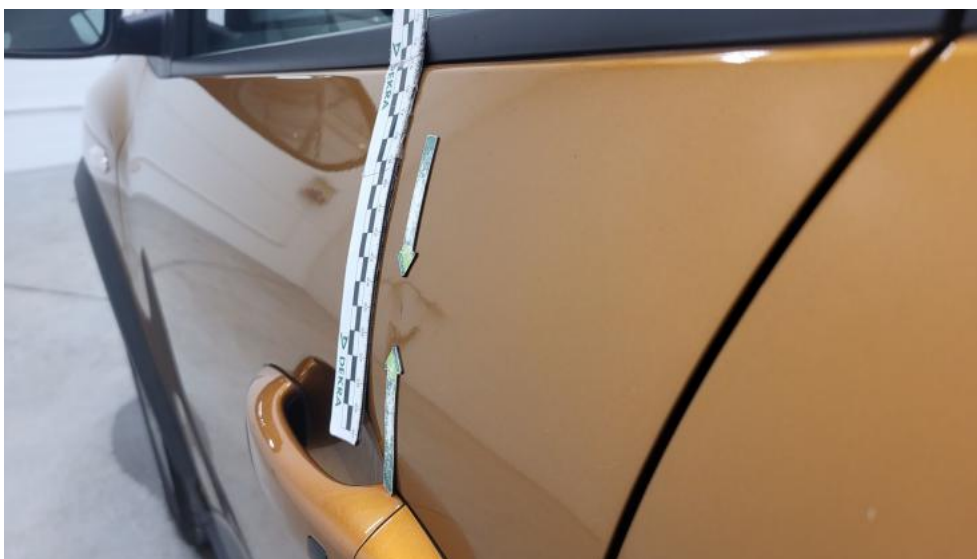
Fot. 101. Drzwi przed L - Wgniecenie/odkształcenie 1
