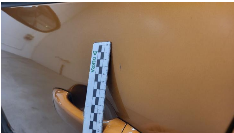
Fot. 98. Drzwi przed L - Rysa/odprysk 1
