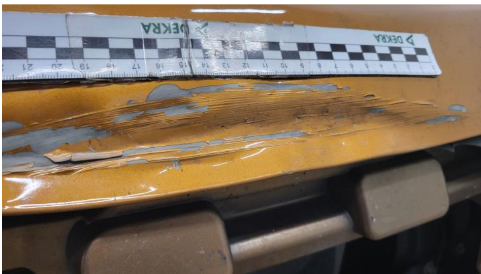
Fot. 50. Pokrywa komory silnika - Pęknięcie/rozerwanie 1
