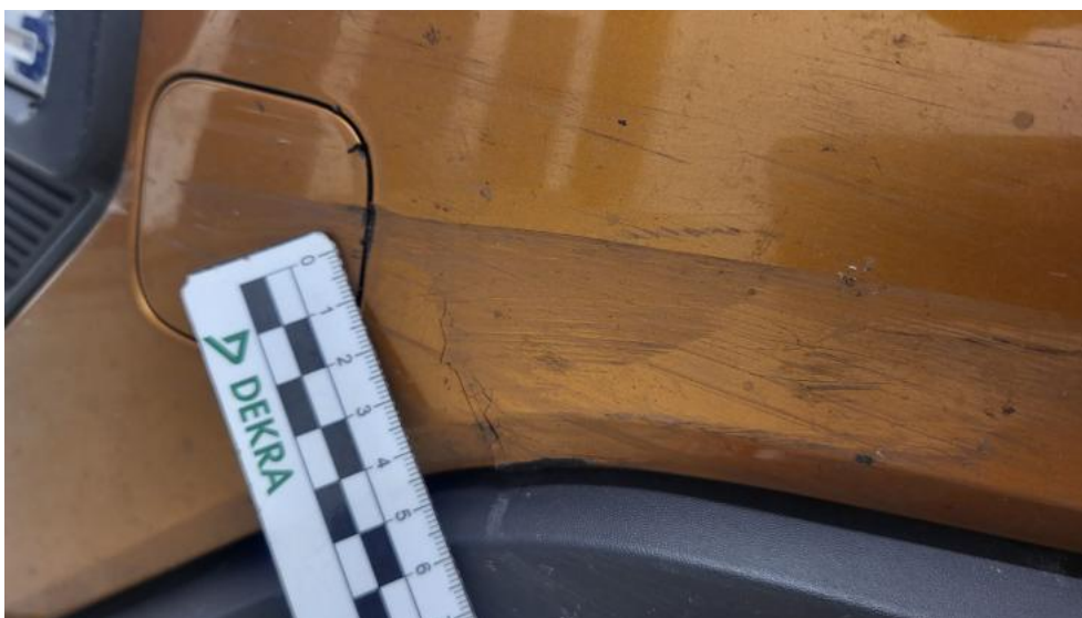
Fot. 58. Zderzak - Pęknięcie/rozerwanie 1
