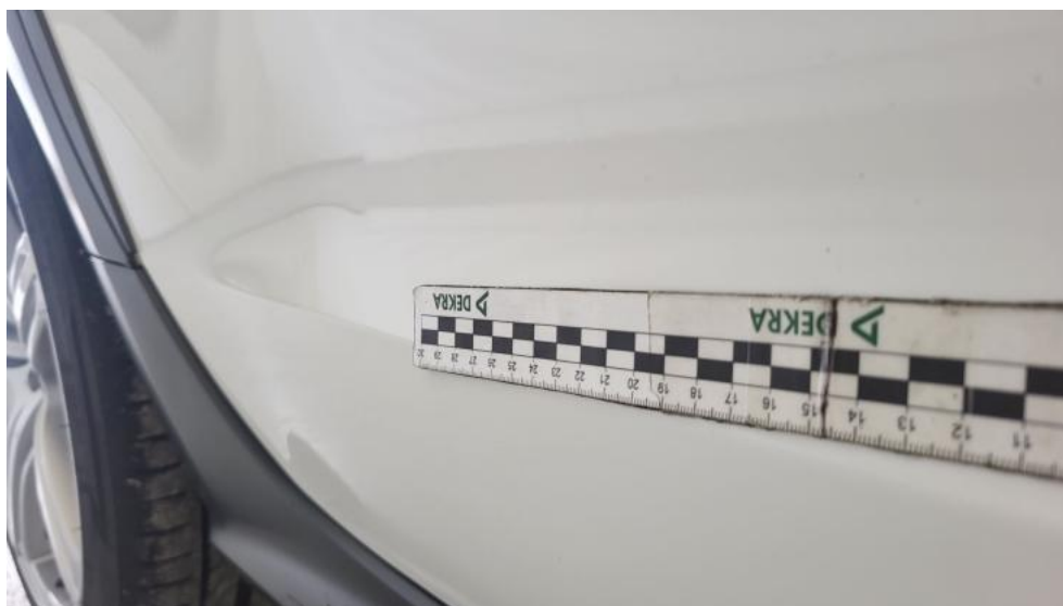
Fot. 58. Drzwi tylne P - Wgniecenie/odkształcenie 1
