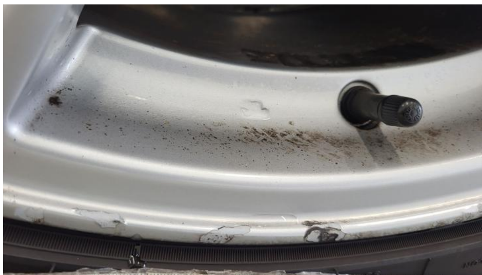
Fot. 76. Felga Aluminiowa przednia L - Rysa/odprysk 2
