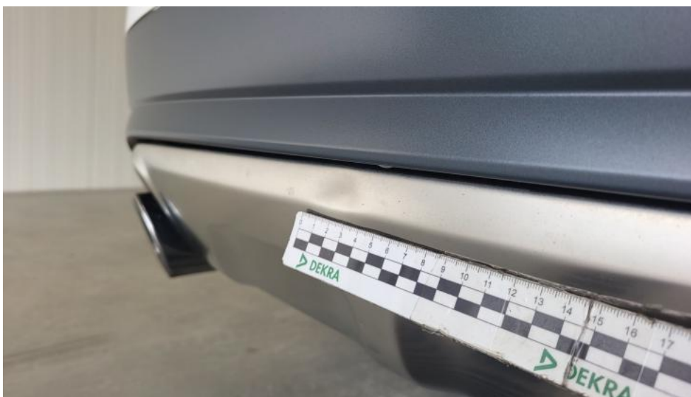
Fot. 63. Zderzak tylny - Wgniecenie/odkształcenie 1
