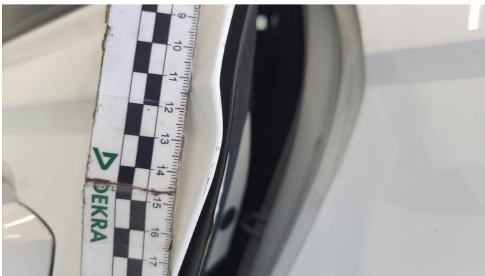
Fot. 68. Drzwi tylne L - Rysa/odprysk 1
