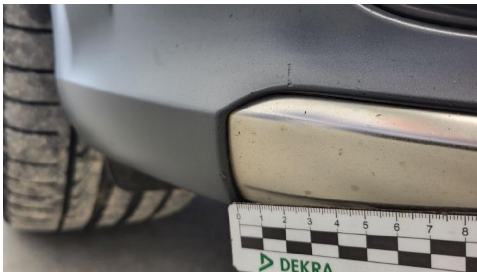
Fot. 47. Spoiler zderzaka przedniego - Rysa/odprysk 2
