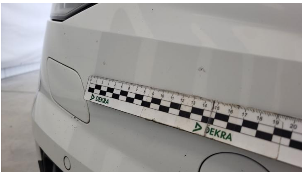
Fot. 53. Zderzak - Rysa/odprysk 2
