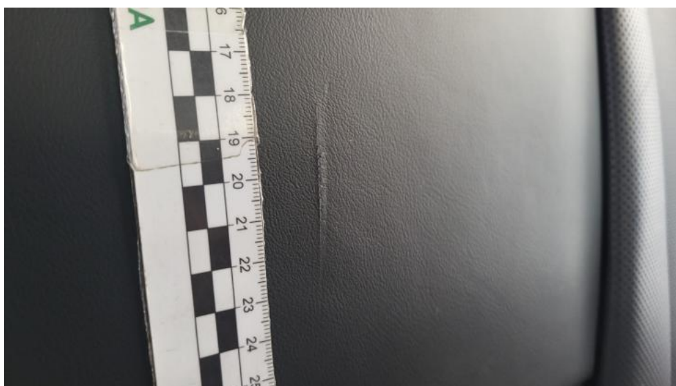
Fot. 80. Kanapa tyl. - Rysa/odprysk 1
