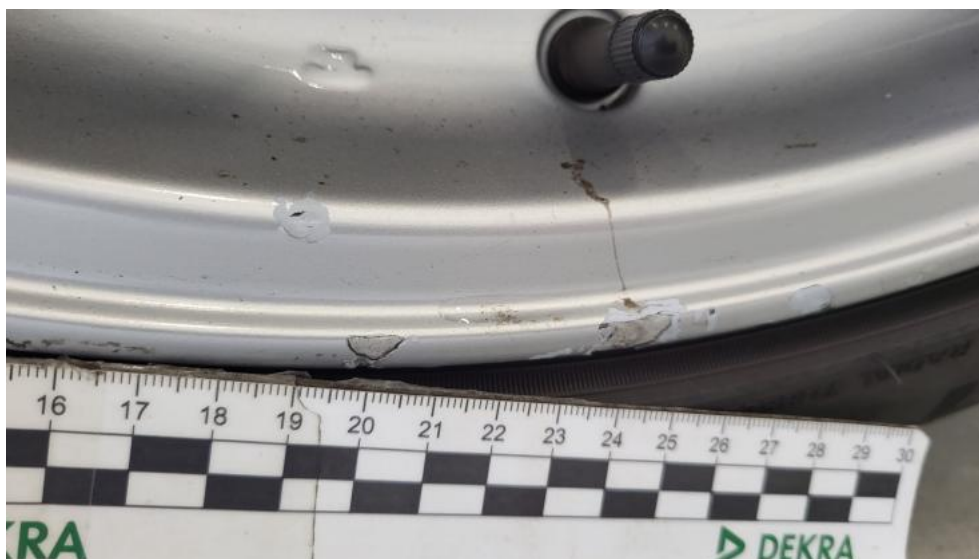
Fot. 61. Felga aluminiowa tylna P - Rysa/odprysk 2
