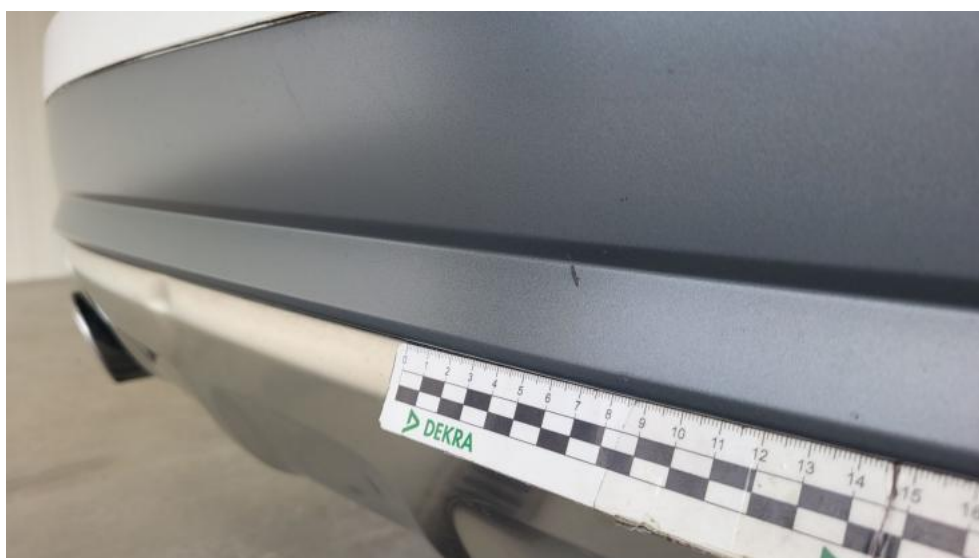
Fot. 62. Zderzak tylny - Rysa/odprysk 1
