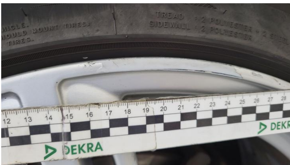
Fot. 60. Felga aluminiowa tylna P - Rysa/odprysk 1
