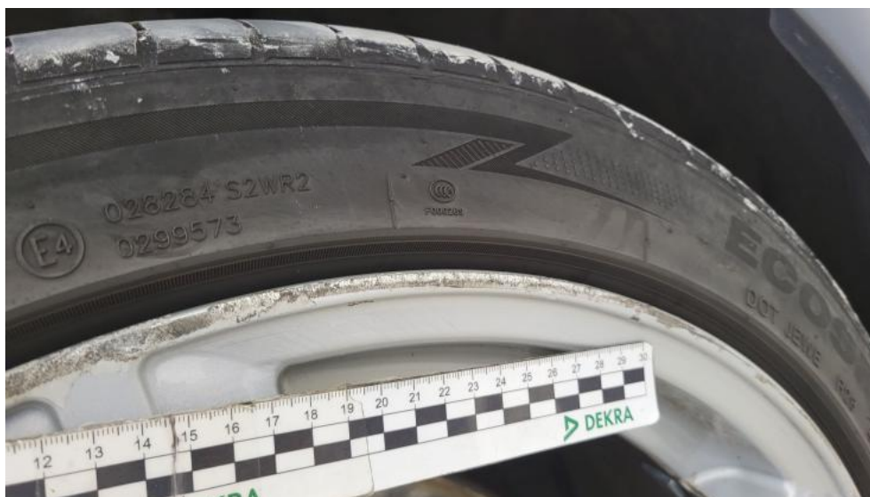
Fot. 57. Felga aluminiowa przednia P - Rysa/odprysk 2
