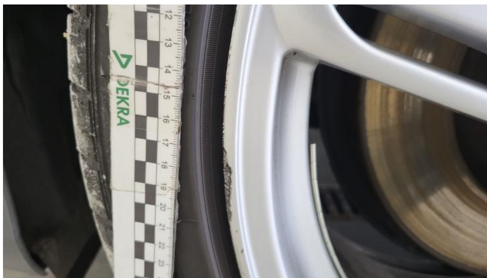
Fot. 75. Felga Aluminiowa przednia L - Rysa/odprysk 1
