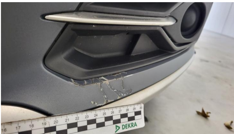
Fot. 46. Spoiler zderzaka przedniego - Rysa/odprysk 1
