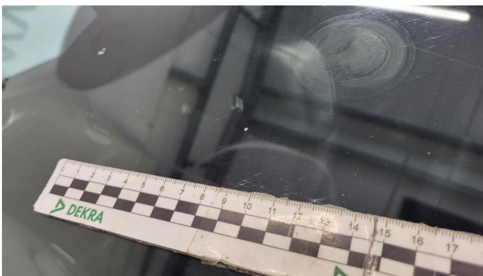
Fot. 50. Szyba czołowa - Rysa/odprysk 2
