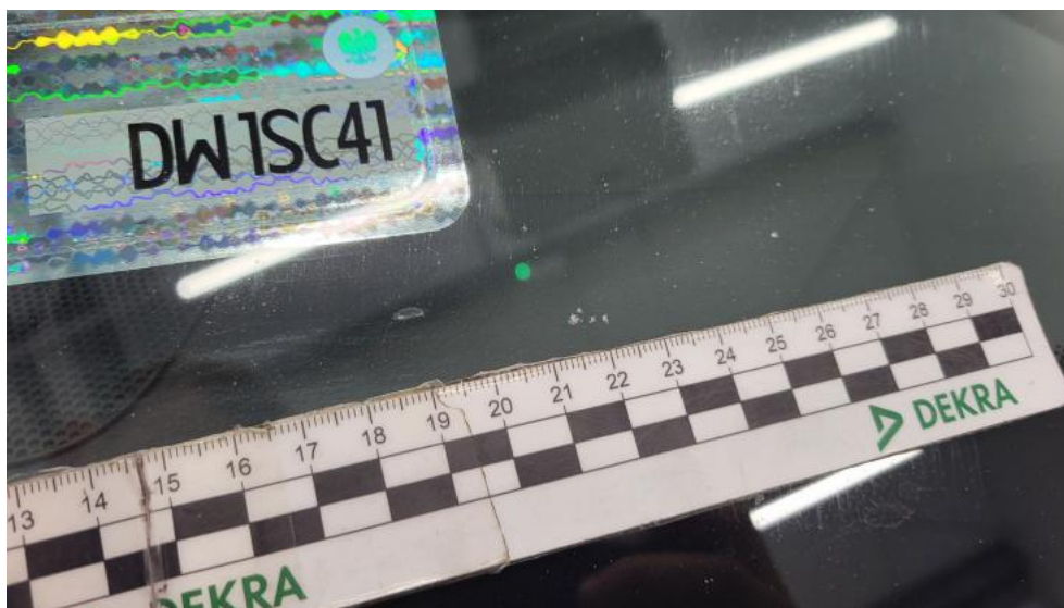
Fot. 51. Szyba czołowa() - Rysa/odprysk 3
