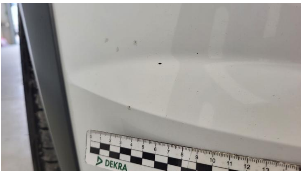
Fot. 54. Zderzak() - Rysa/odprysk 3
