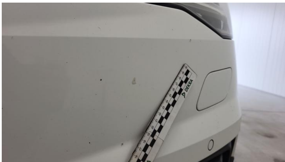
Fot. 52. Zderzak - Rysa/odprysk 1
