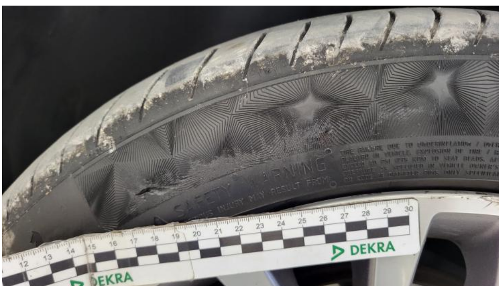
Fot. 86. Opona przednia L - Pęknięcie/rozerwanie 2
