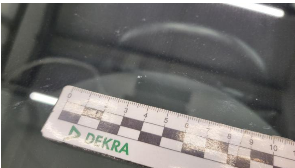
Fot. 48. Szyba czołowa ogrzewana - Rysa/odprysk 1
