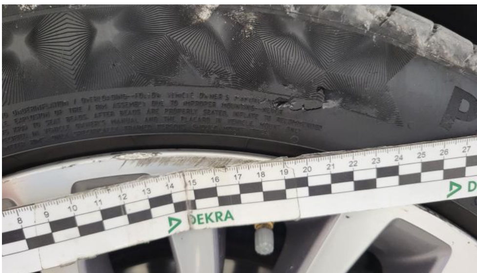
Fot. 85. Opona przednia L - Pęknięcie/rozerwanie 1
