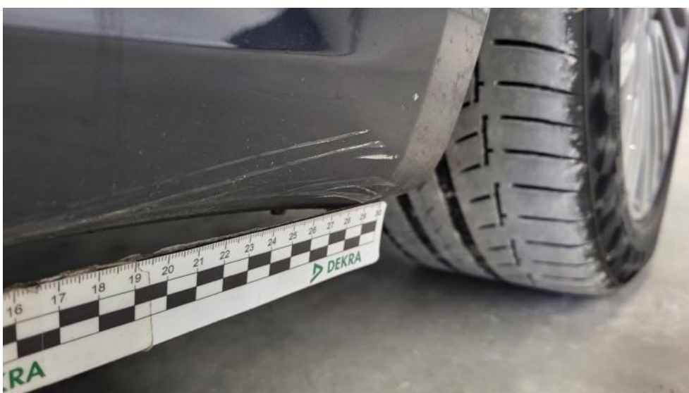
Fot. 58. Próg P - Rysa/odprysk 2
