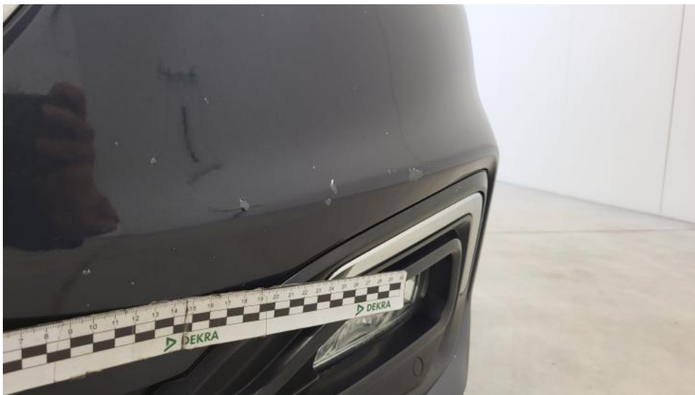
Fot. 49. Zderzak - Rysa/odprysk 1
