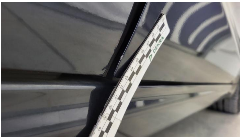
Fot. 55. Drzwi przednie P - Rysa/odprysk 2
