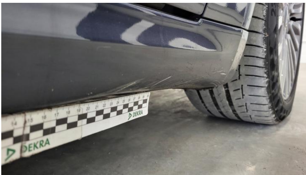
Fot. 57. Próg P - Rysa/odprysk 1
