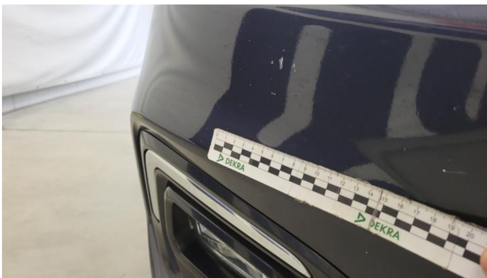
Fot. 50. Zderzak - Rysa/odprysk 2
