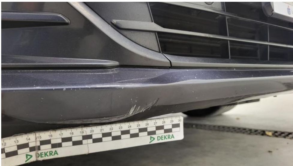
Fot. 51. Zderzak() - Rysa/odprysk 3
