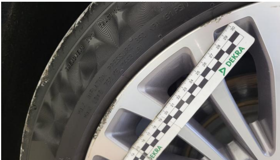
Fot. 71. Felga aluminiowa tylna L - Rysa/odprysk 1
