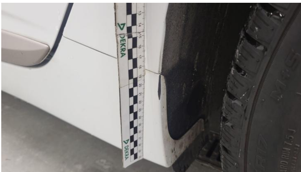
Fot. 51. Próg L - Rysa/odprysk 1
