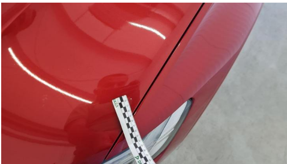
Fot. 40. Pokrywa komory silnika - Rysa/odprysk 2
