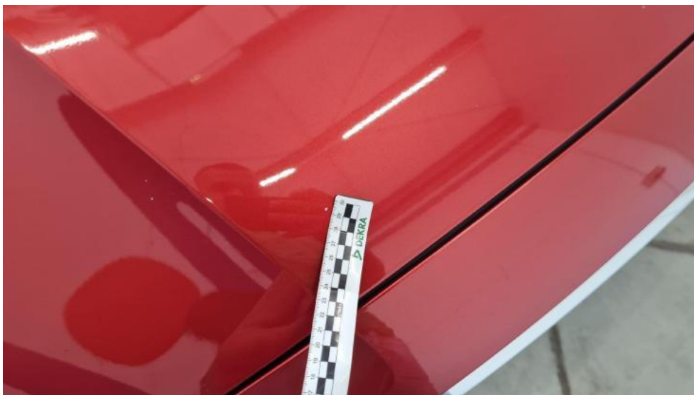
Fot. 39. Pokrywa komory silnika - Rysa/odprysk 1
