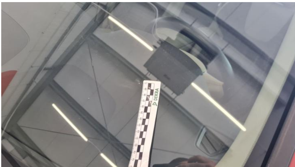
Fot. 41. Szyba czołowa - Rysa/odprysk 1
