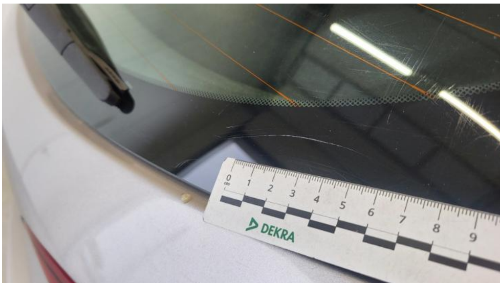
Fot. 63. Szyba tylna - Rysa/odprysk 1
