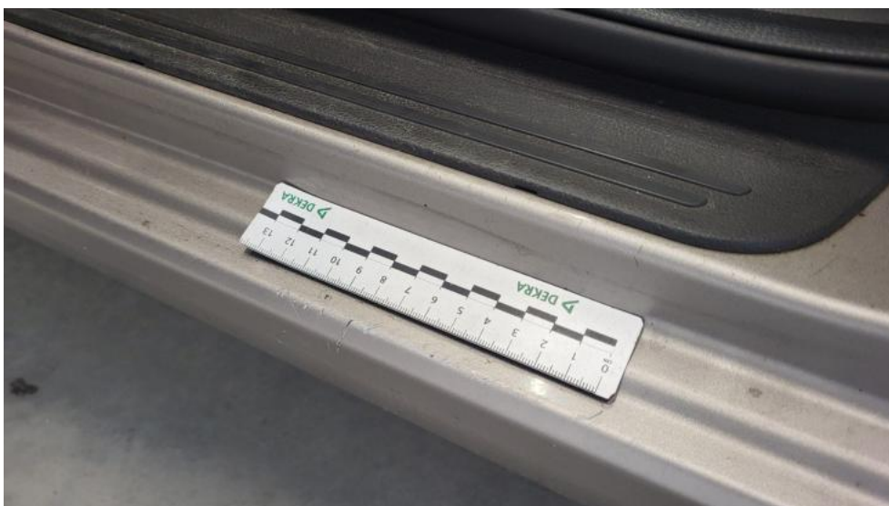
Fot. 76. Próg L - Rysa/odprysk 1
