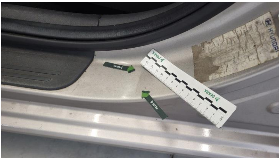
Fot. 77. Próg L - Wgniecenie/odkształcenie 1
