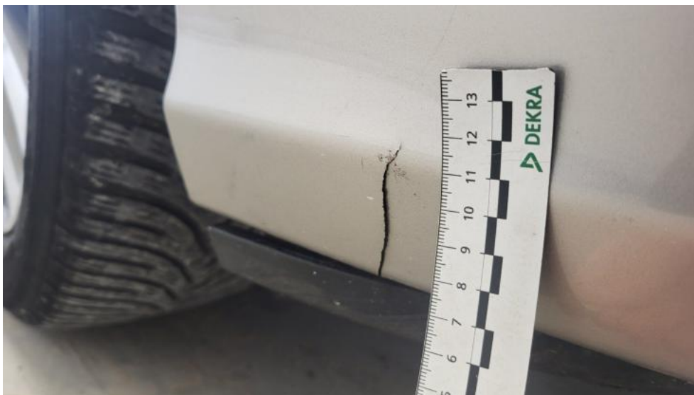
Fot. 49. Zderzak - Pęknięcie/rozerwanie 2
