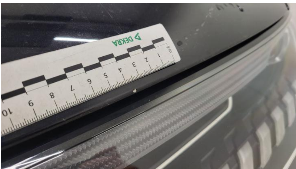
Photo 44. Pokrywa komory silnika - Rysa/odprysk 1
