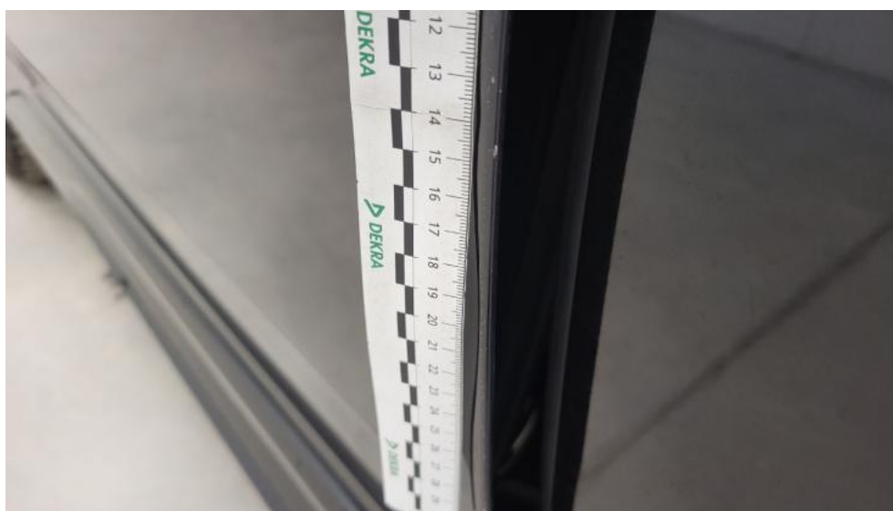
Photo 54. Drzwi przed L - Rysa/odprysk 1
