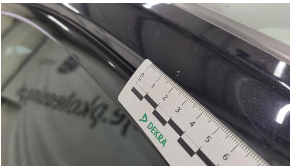
Photo 51. Stupek przedni P - Rysa/odprysk 1
