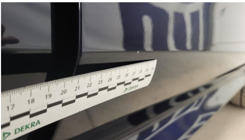
Photo 44. Drzwi przednie P - Rysa/odprysk 1
