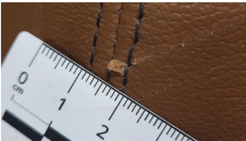
Photo 61. Fotel prz. lew. - Pęknięcie/rozerwanie 1
