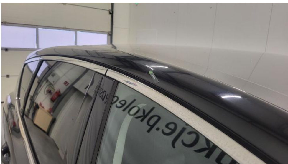
Fot. 60. Słupek przedni P - Wgniecenie/odkształcenie 1
