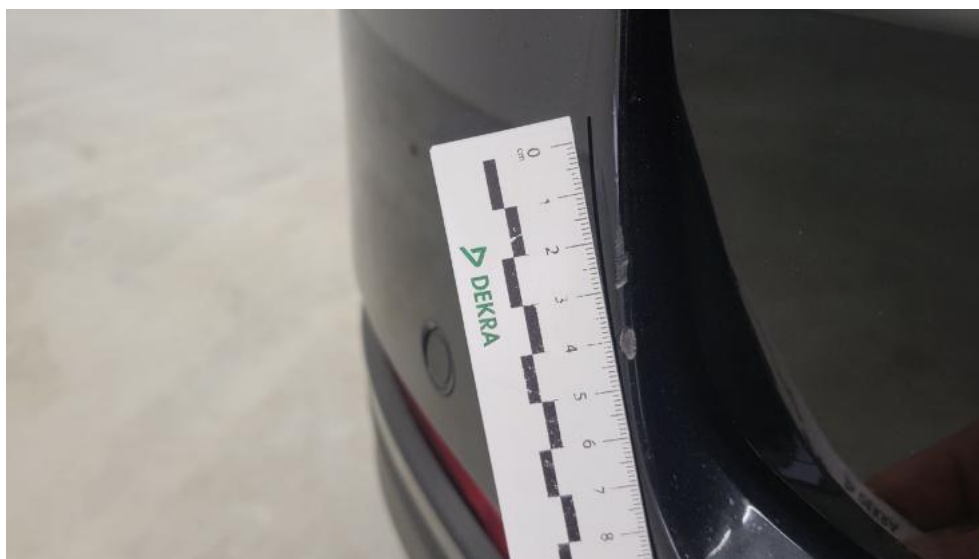
Fot. 73. Zderzak tylny() - Rysa/odprysk 3
