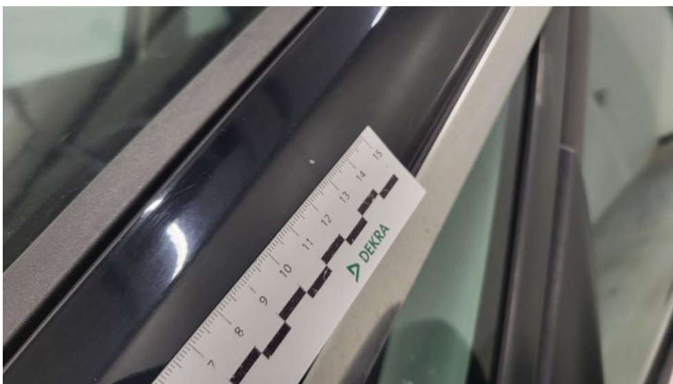
Fot. 84. Słupek przedni L - Rysa/odprysk 1
