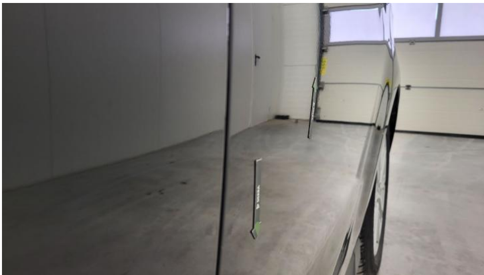
Fot. 81. Drzwi tylne L - Wgniecenie/odkształcenie 1
