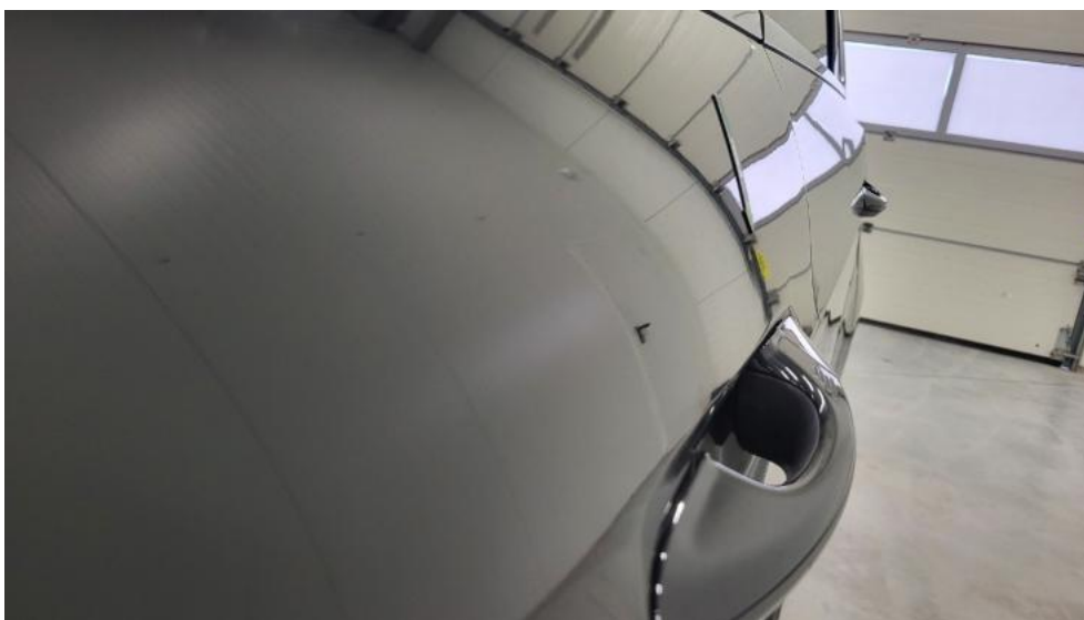
Fot. 79. Drzwi przed L - Wgniecenie/odkształcenie 1
