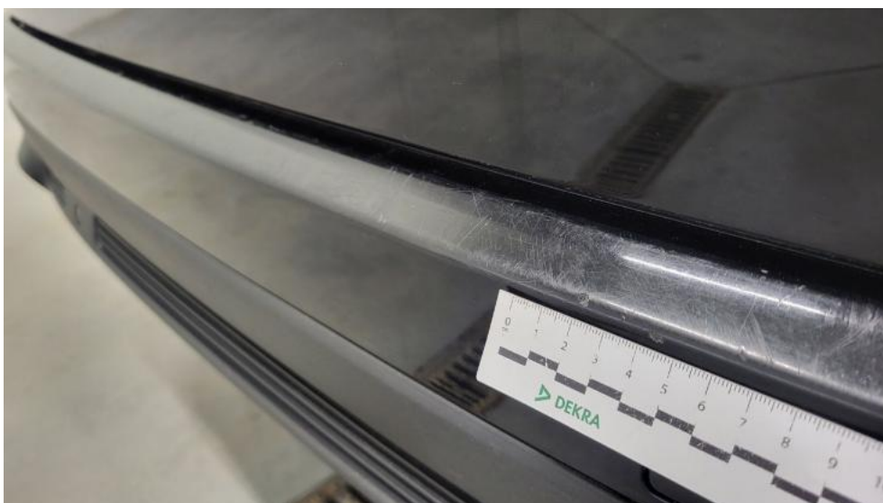
Fot. 72. Zderzak tylny - Rysa/odprysk 2
