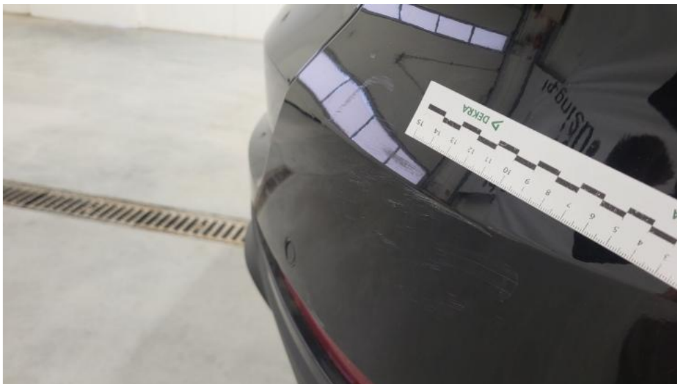
Fot. 71. Zderzak tylny - Rysa/odprysk 1
