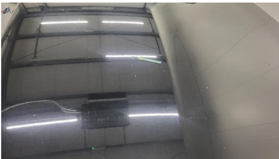
Fot. 42. Pokrywa komory silnika - Wgniecenie/odkształcenie 1
