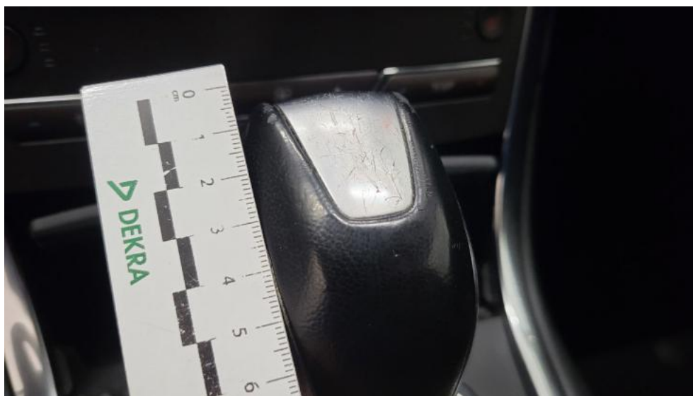
Fot. 87. Gałka dźwigni zmiany biegów - Rysa/odprysk 1
