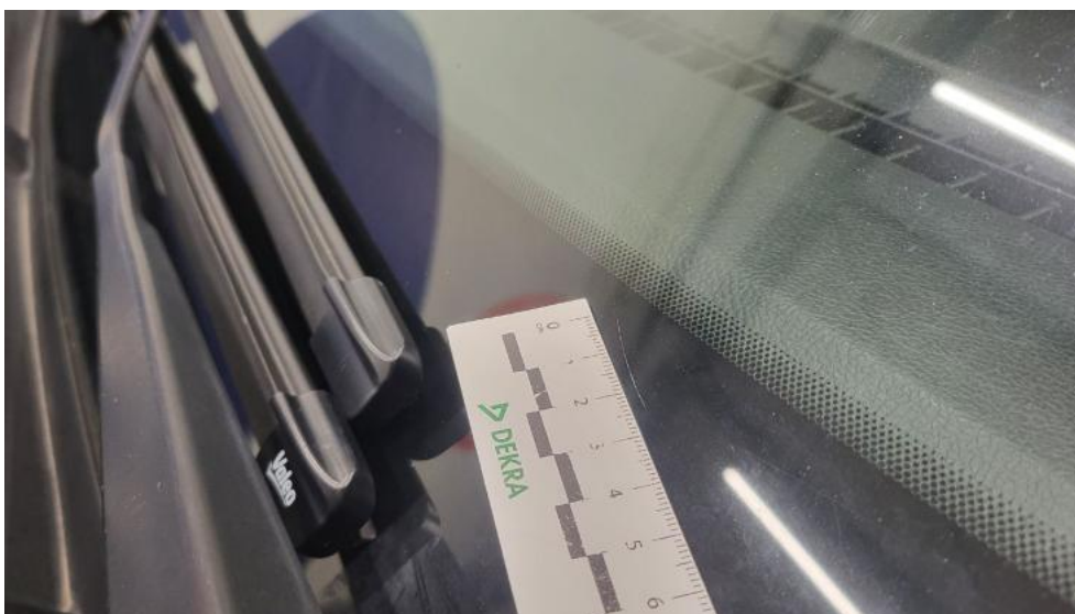
Fot. 44. Szyba czołowa - Rysa/odprysk 1
