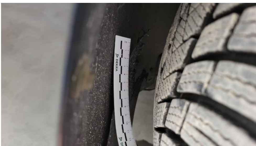
Fot. 86. Nadkole przednie L - Pęknięcie/rozerwanie 1
