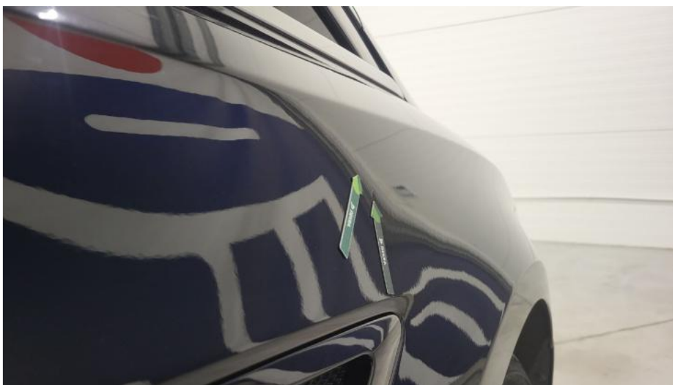
Fot. 49. Błotnik przedni P - Wgniecenie/odkształcenie 1
