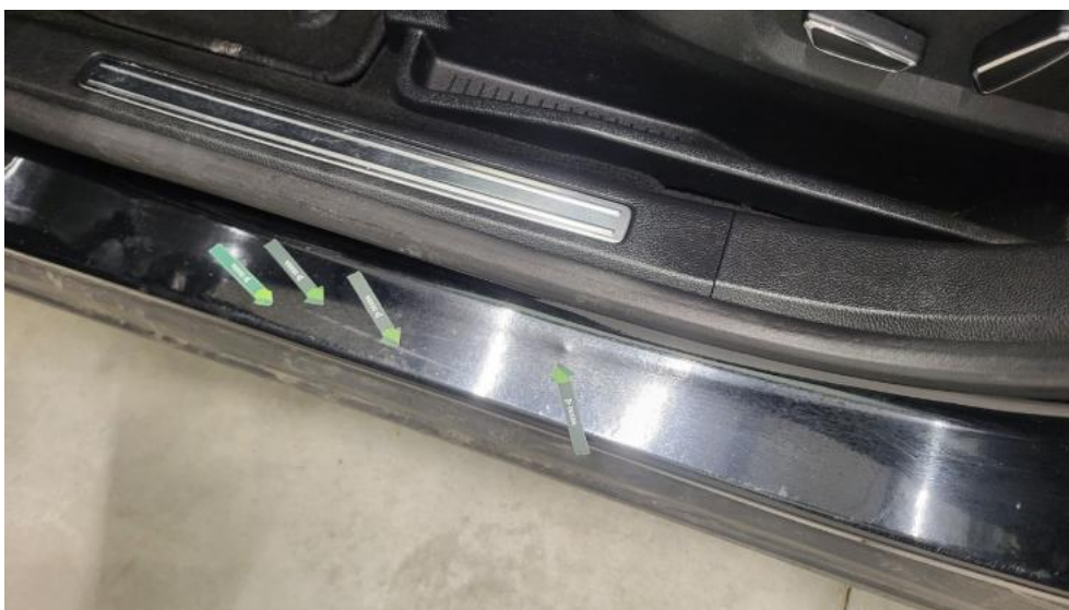
Fot. 83. Próg L - Wgniecenie/odkształcenie 1
