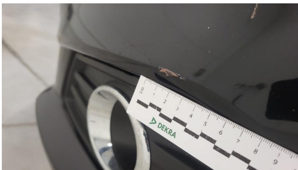
Fot. 46. Zderzak - Rysa/odprysk 1
