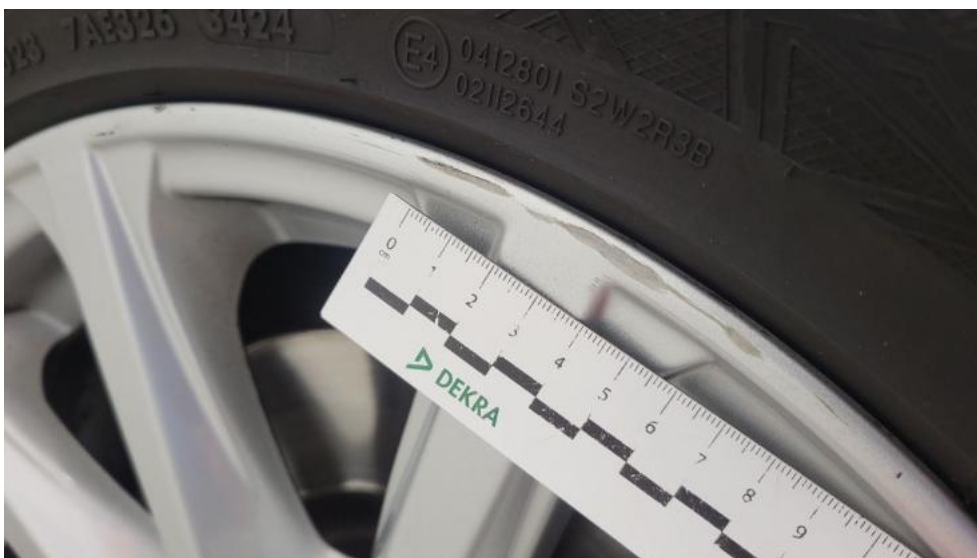
Fot. 50. Felga aluminiowa przednia P - Rysa/odprysk 1
