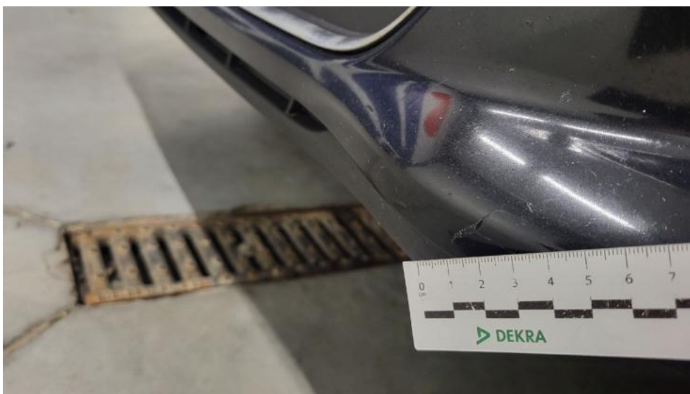
Fot. 47. Zderzak - Rysa/odprysk 2
