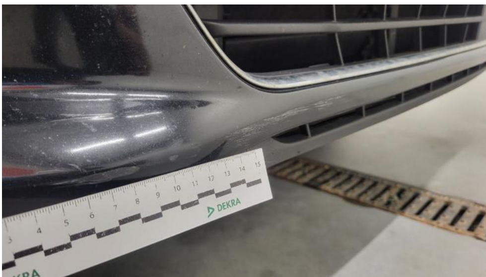
Fot. 48. Zderzak() - Rysa/odprysk 3
