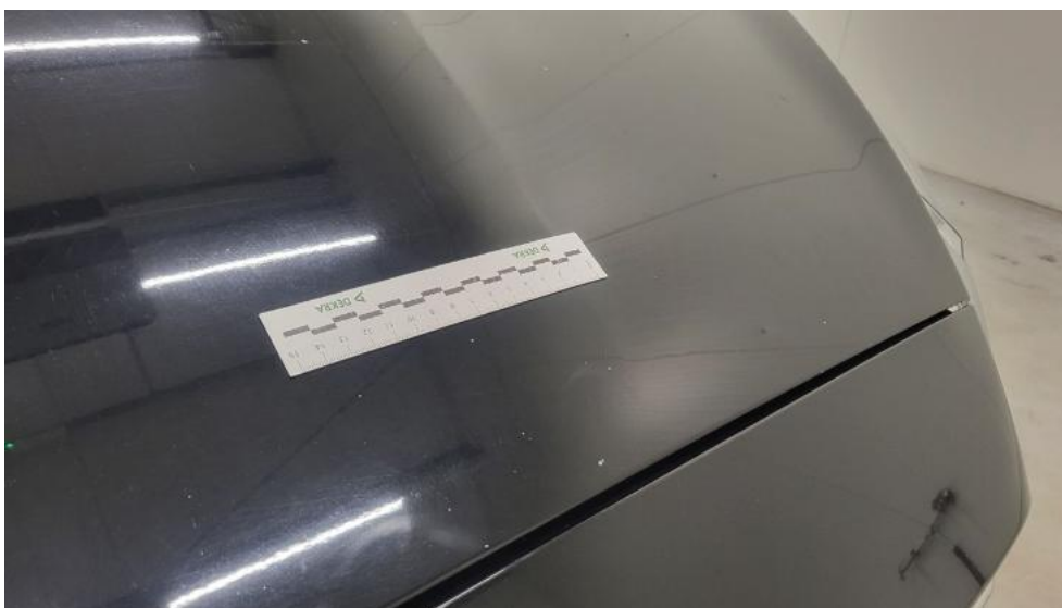
Fot. 41. Pokrywa komory silnika - Rysa/odprysk 2
