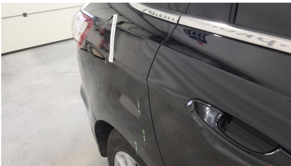
Fot. 62. Błotnik tylny P / Ściana boczna P - Wgniecenie/odkształcenie 1
