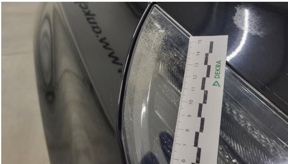
Fot. 51. Reflektor P - Rysa/odprysk 1
