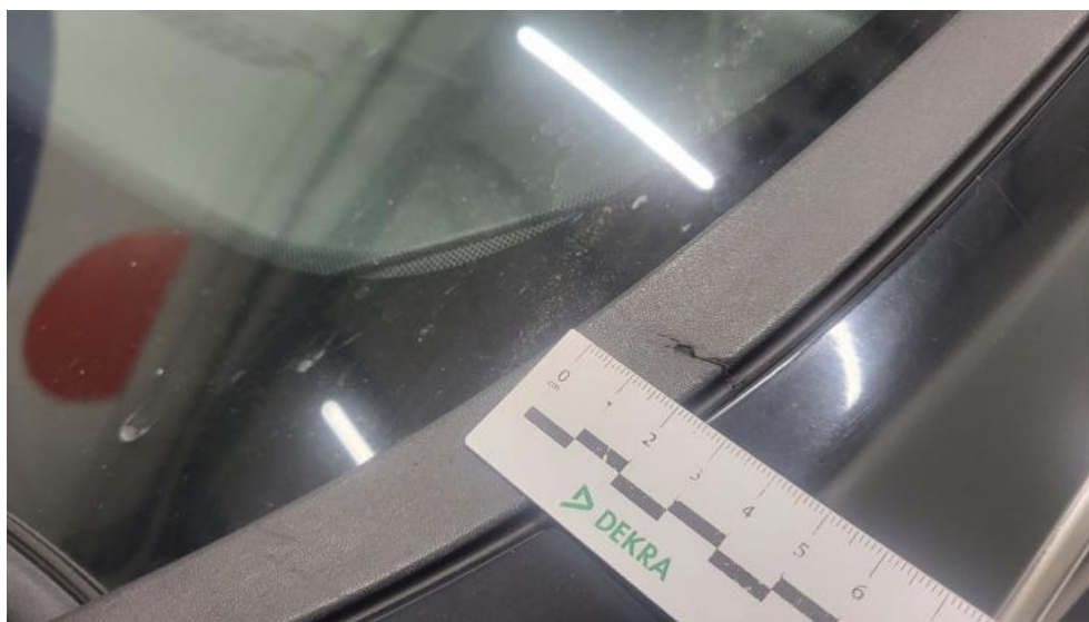
Fot. 45. Uszczelka/listwa szyby czołowej - Rysa/odprysk 1
