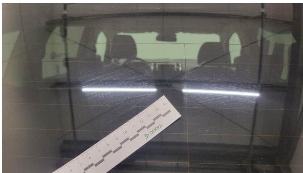
Fot. 70. Szyba tylna - Rysa/odprysk 1
