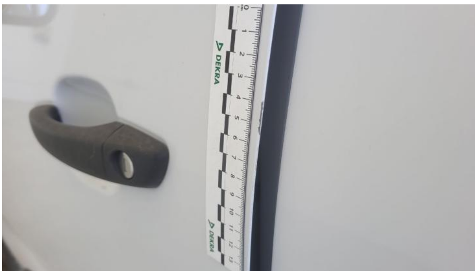
Photo 50. Drzwi przed L - Rysa/odprysk 1
