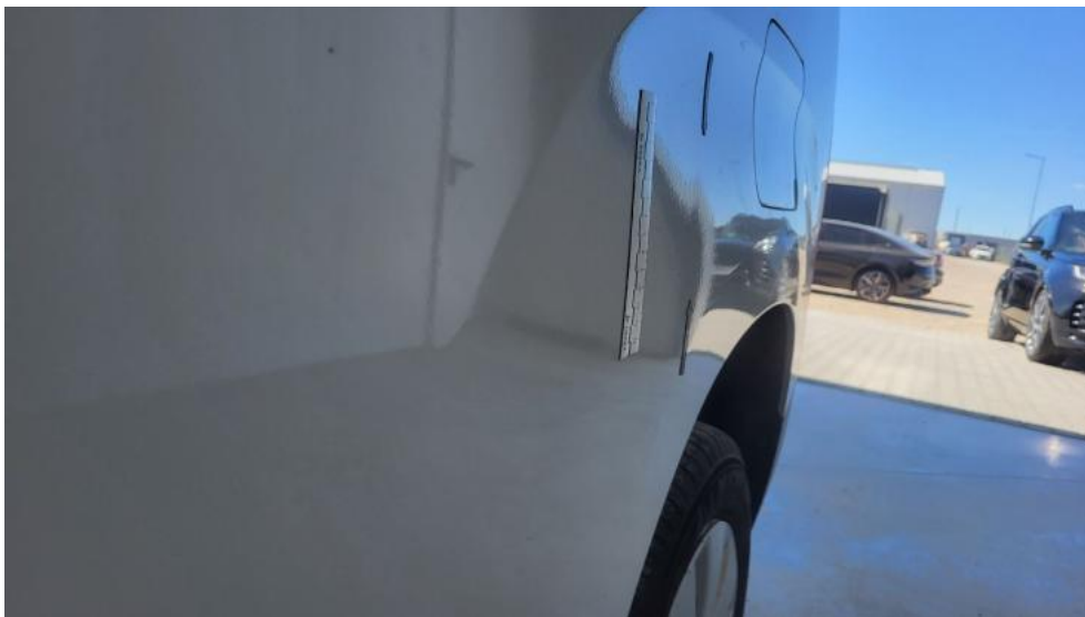
Photo 49. Błotnik tylny L / Ściana boczna L - Wgniecenie/odkształcenie 2
