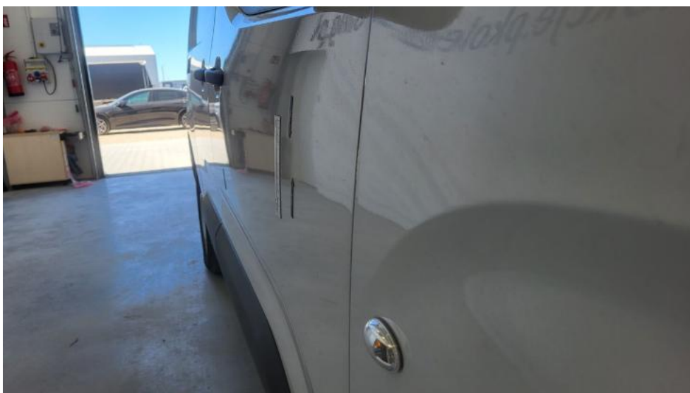
Photo 44. Drzwi przednie P - Wgniecenie/odkształcenie 1
