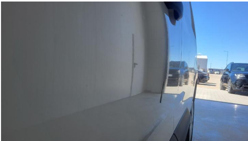
Photo 51. Drzwi przed L - Wgniecenie/odkształcenie 1
