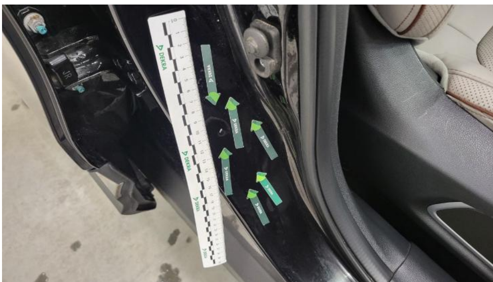
Photo 57. Słupek środkowy P - Wgniecenie/odkształcenie 1
