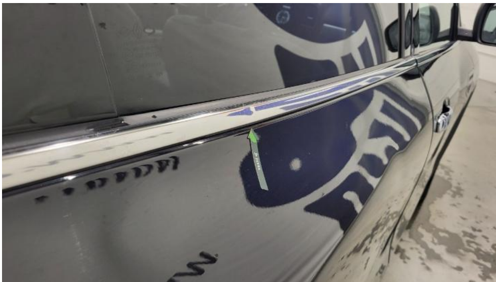
Photo 55. Listwa drzwi tylnych P - Wgniecenie/odkształcenie 1
