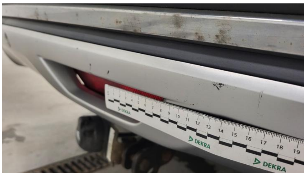
Photo 66. Spojler zderzaka tylnego - Rysa/odprysk 1
