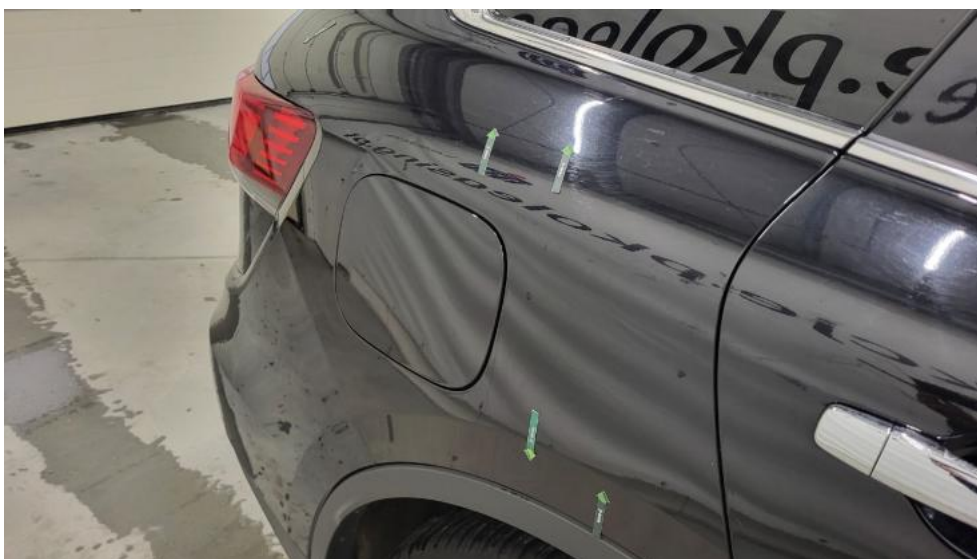
Photo 59. Błotnik tylny P / Ściana boczna P - Wgniecenie/odkształcenie 1
