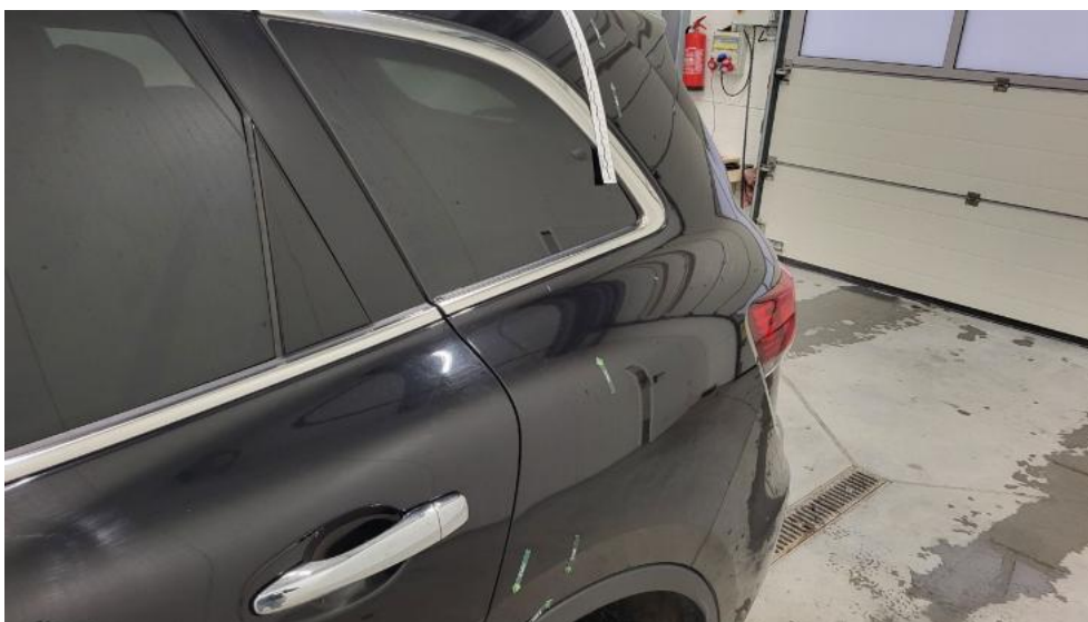
Photo 73. Błotnik tylny L / Ściana boczna L - Wgniecenie/odkształcenie 1
