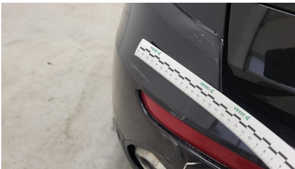
Photo 67. Zderzak tylny - Rysa/odprysk 1
