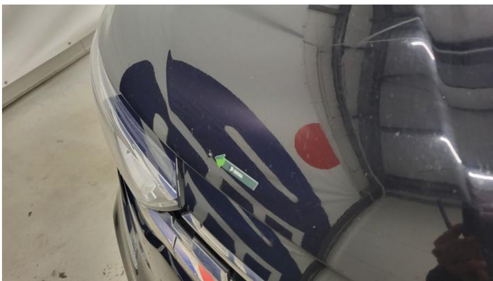
Photo 46. Pokrywa komory silnika - Wgniecenie/odkształcenie 1
