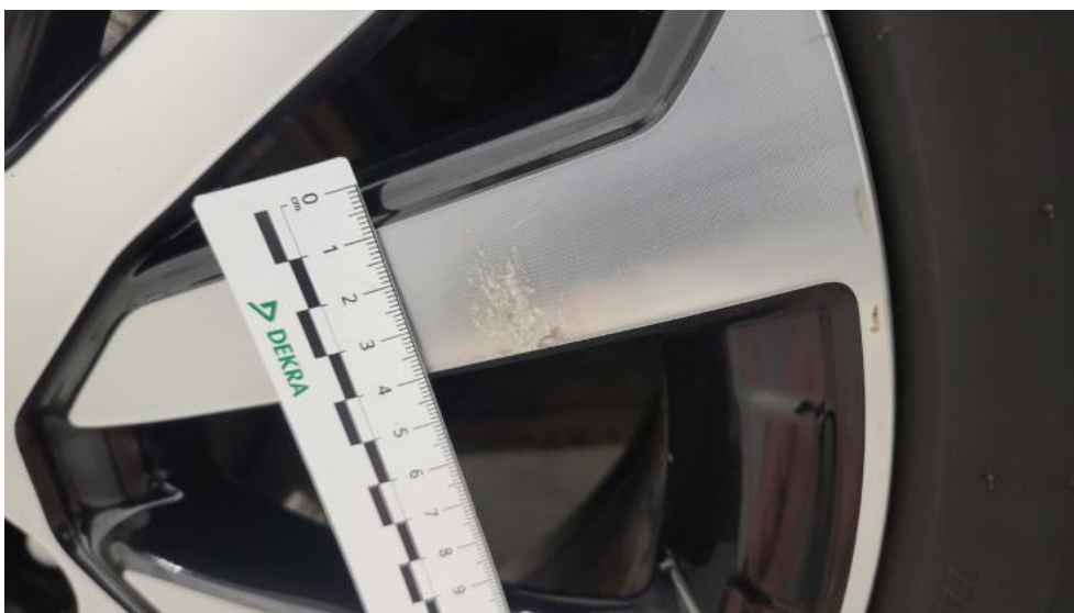
Photo 60. Felga aluminiowa tylna P - Rysa/odprysk 1
