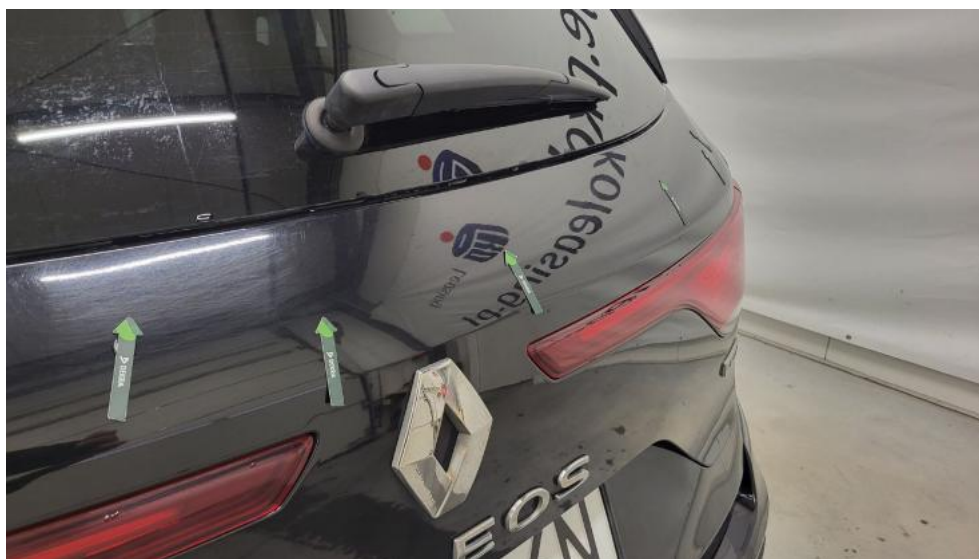
Photo 65. Pokrywy bagażnika - Wgniecenie/odkształcenie 1
