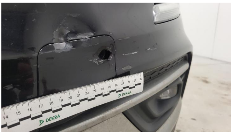
Photo 48. Zaślepka prz haka hol. - Pęknięcie/rozerwanie 1
