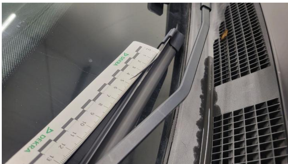
Photo 44. Pióro wycieraczki szyby prz P - Pęknięcie/rozerwanie 1
