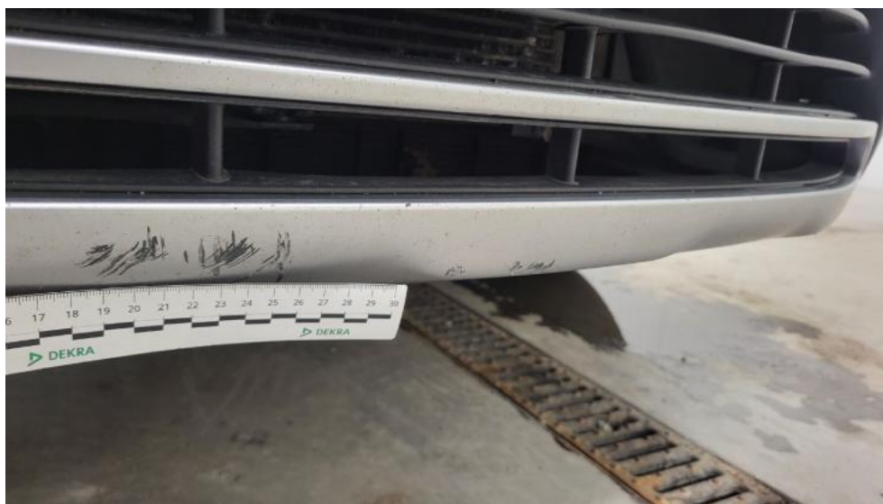
Photo 47. Spoiler zderzaka przedniego - Rysa/odprysk 1
