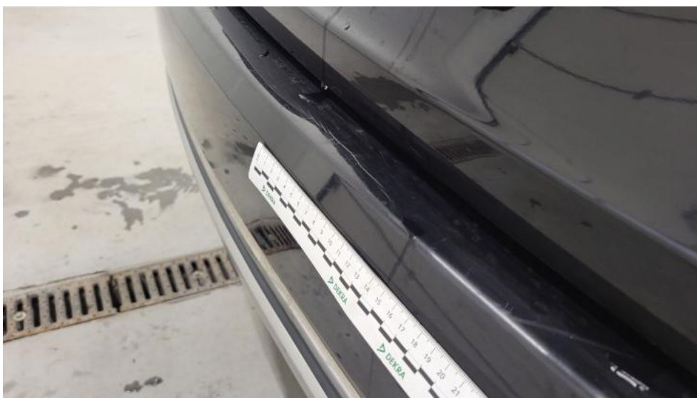
Photo 68. Zderzak tylny - Wgniecenie/odkształcenie 1
