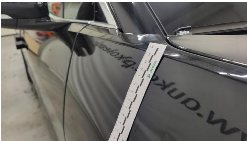
Fot. 56. Błotnik przedni P - Wgniecenie/odkształcenie 2
