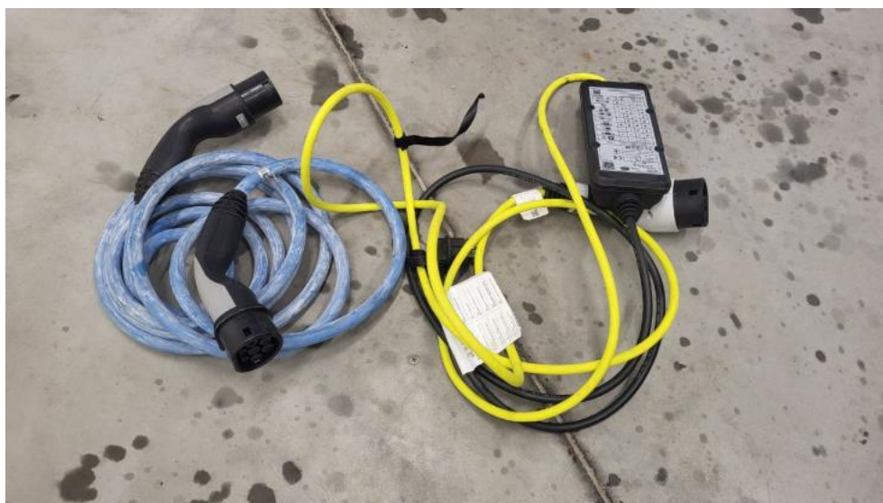
Fot. 34. Przewód ładowania baterii trakcyjnej
