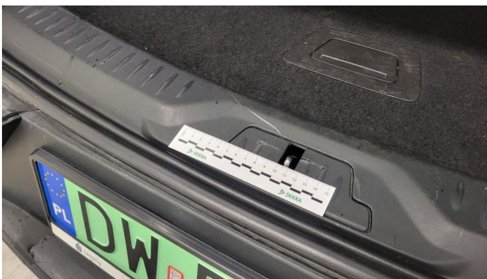
Fot. 64. Nakładka pokrywy tylnej - Rysa/odprysk 1
