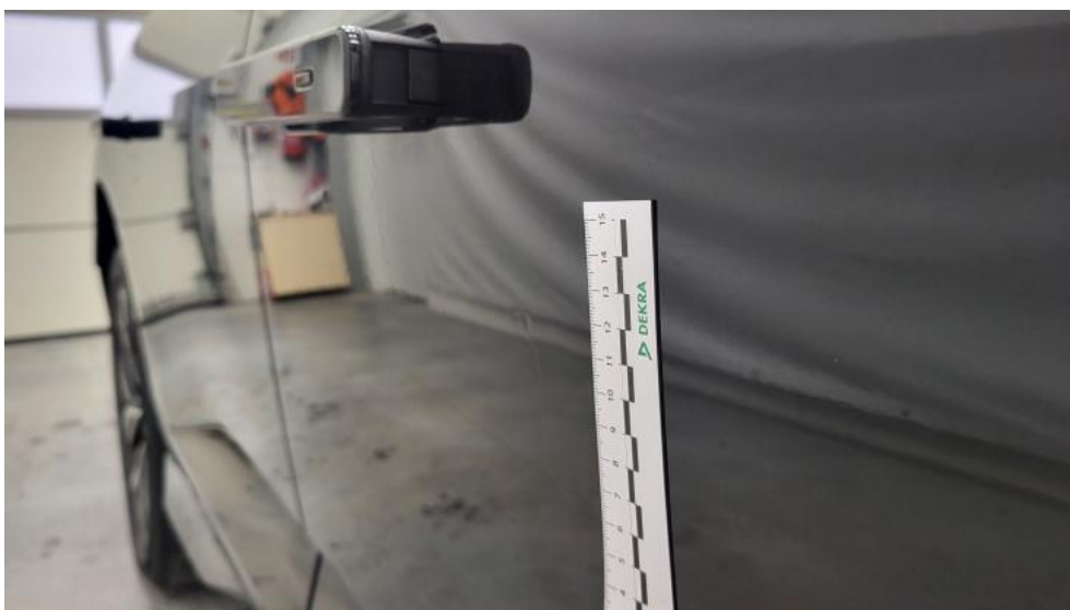
Fot. 58. Drzwi przednie P - Wgniecenie/odkształcenie 1
