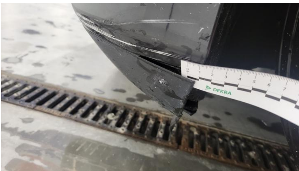
Fot. 53. Zderzak przedni cz dolna - Inne 1
