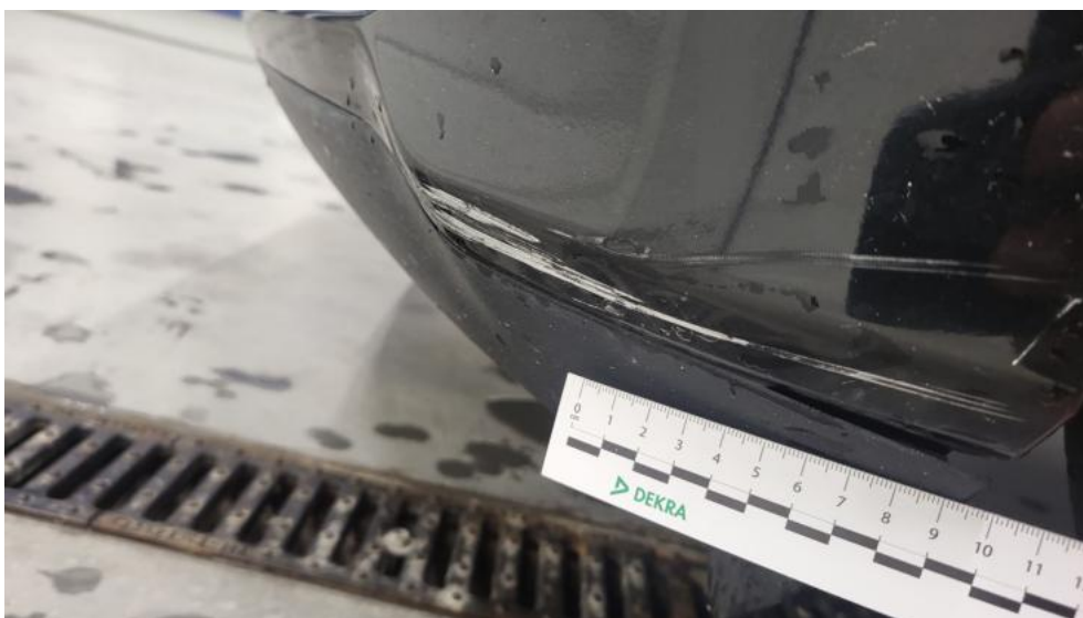
Fot. 49. Zderzak - Rysa/odprysk 1
