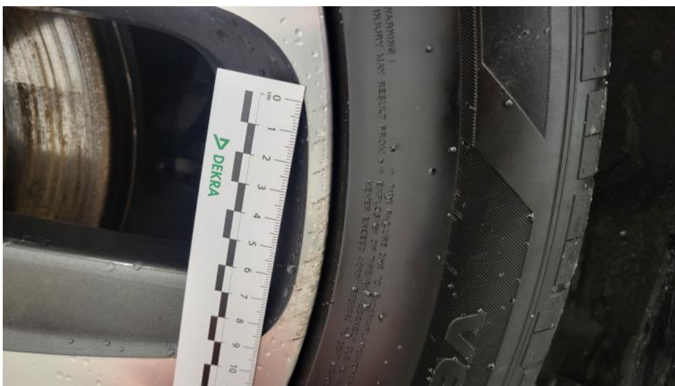
Fot. 63. Felga aluminiowa tylna P - Rysa/odprysk 1
