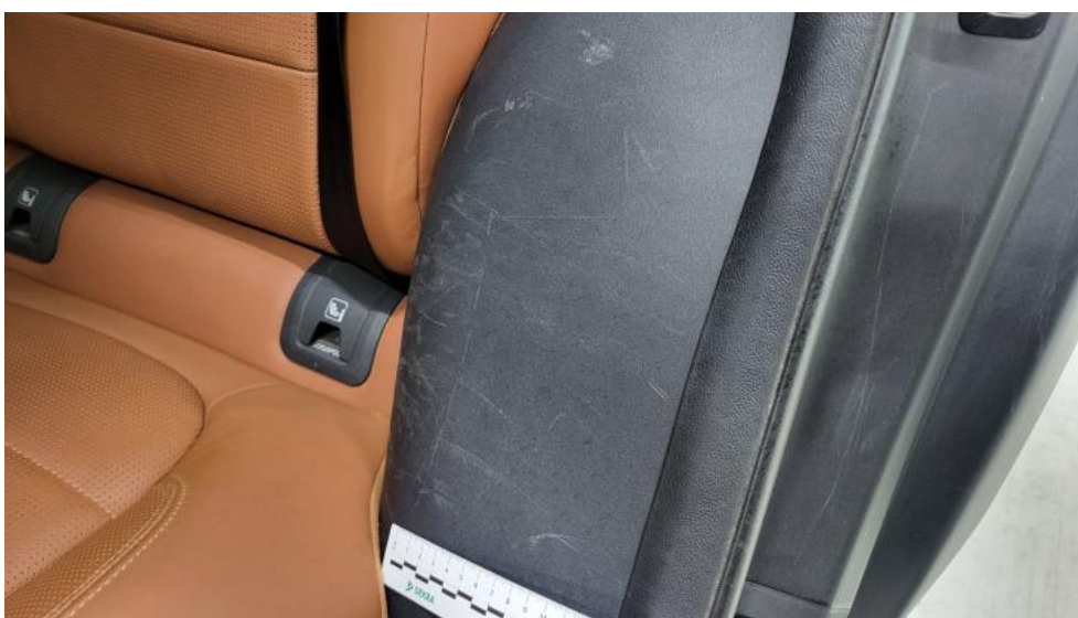
Fot. 70. Wykładzina(y) słupka tylnego L - Rysa/odprysk 1
