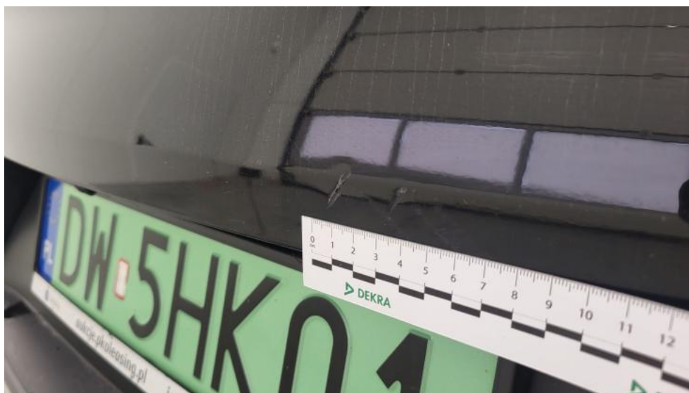
Fot. 65. Pokrywy bagażnika - Wgniecenie/odkształcenie 1
