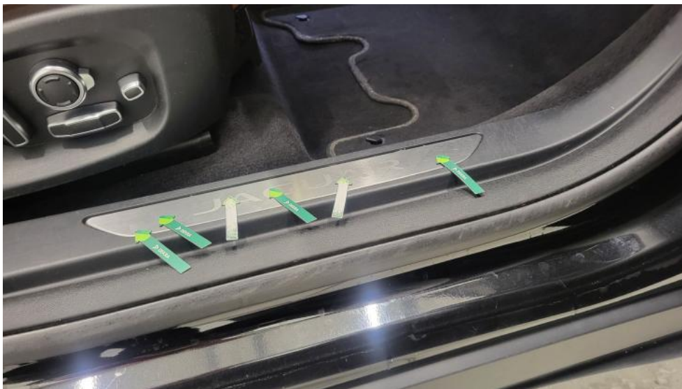
Fot. 73. Listwy progowe praw. - Wgniecenie/odkształcenie 1
