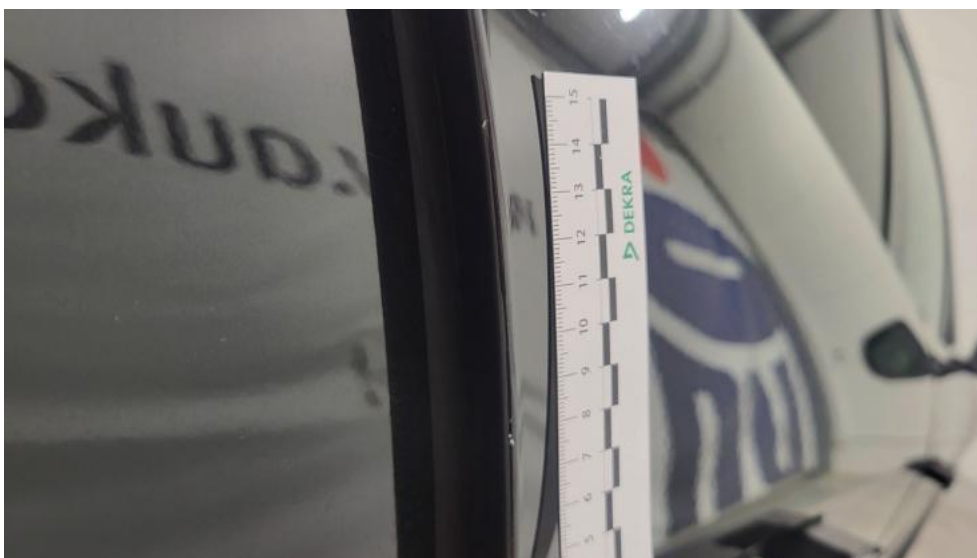
Fot. 60. Drzwi tylne P - Rysa/odprysk 1
