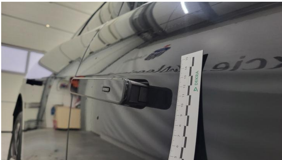
Fot. 59. Drzwi przednie P - Wgniecenie/odkształcenie 2
