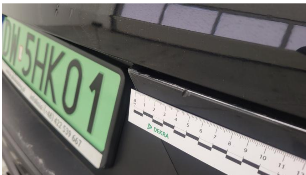
Fot. 66. Zderzak tylny - Rysa/odprysk 1
