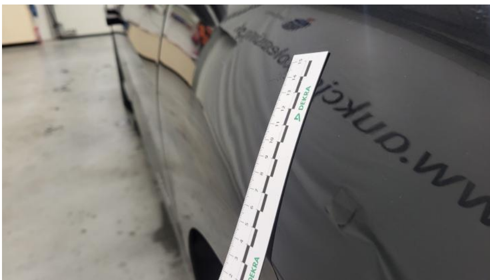
Fot. 55. Błotnik przedni P - Wgniecenie/odkształcenie 1
