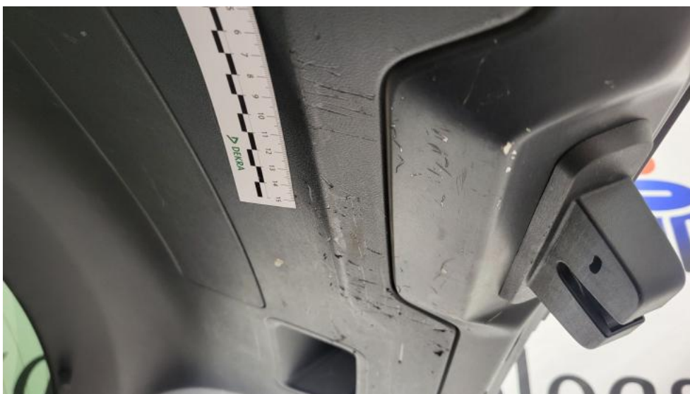
Fot. 74. Wykładzina pokrywy tylnej - Rysa/odprysk 1
