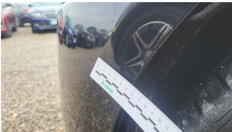
Fot. 50. Zderzak - Wgniecenie/odkształcenie 1
