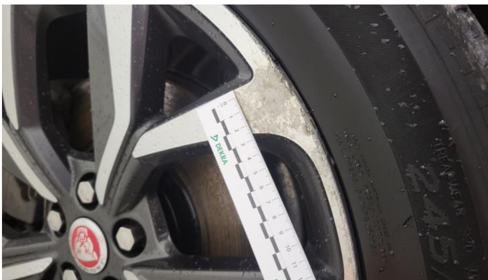
Fot. 57. Felga aluminiowa przednia P - Rysa/odprysk 1
