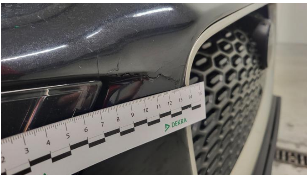
Fot. 52. Zderzak - Pęknięcie/rozerwanie 2
