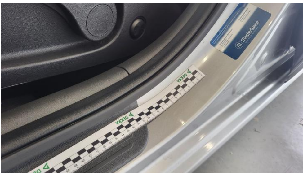
Fot. 53. Próg L - Rysa/odprysk 1
