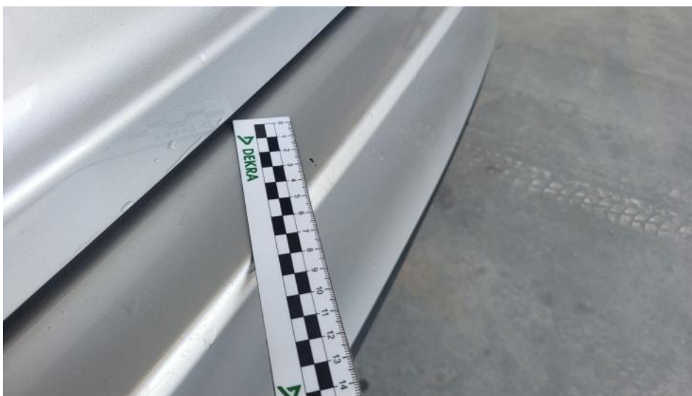
Fot. 57. Zderzak tylny - Rysa/odprysk 1
