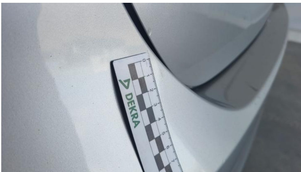
Fot. 58. Zderzak tylny - Wgniecenie/odkształcenie 1
