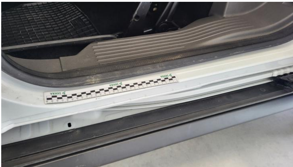
Fot. 53. Próg L - Rysa/odprysk 1
