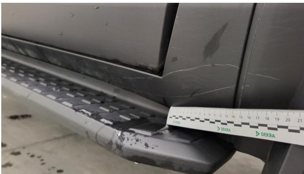
Fot. 51. Próg P - Rysa/odprysk 1
