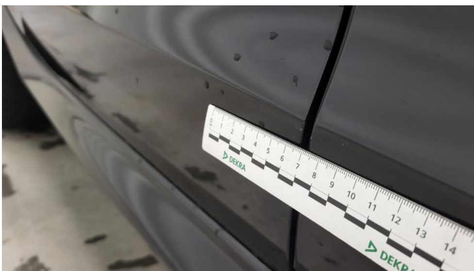
Fot. 54. Drzwi tylne P - Rysa/odprysk 1
