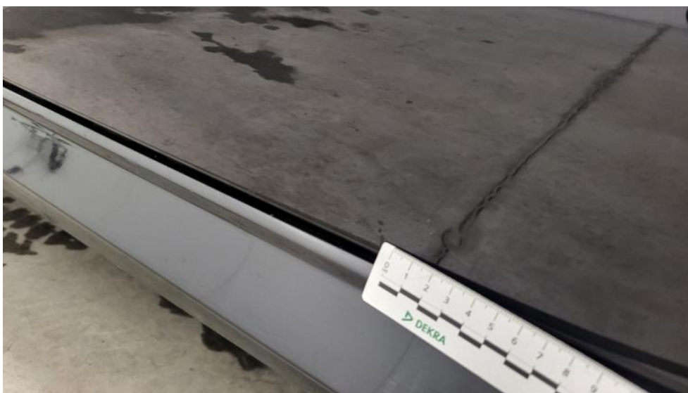
Fot. 69. Drzwi przed L - Wgniecenie/odkształcenie 1
