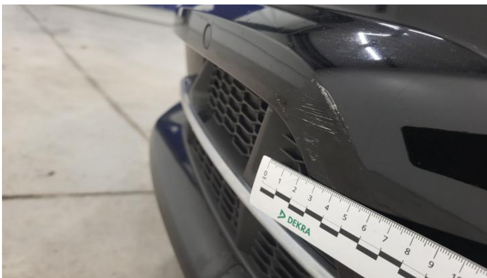
Fot. 44. Zderzak - Rysa/odprysk 1
