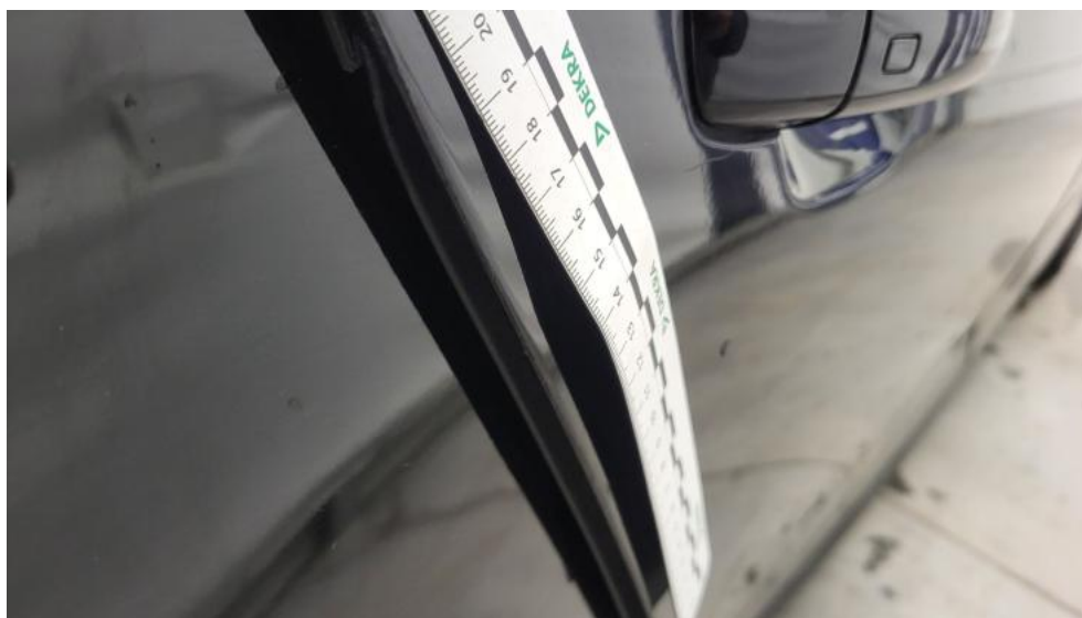
Fot. 55. Drzwi tylne P - Rysa/odprysk 2
