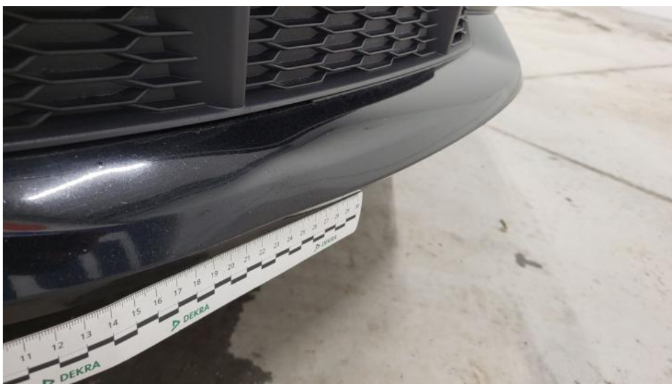
Fot. 46. Zderzak - Wgniecenie/odkształcenie 2
