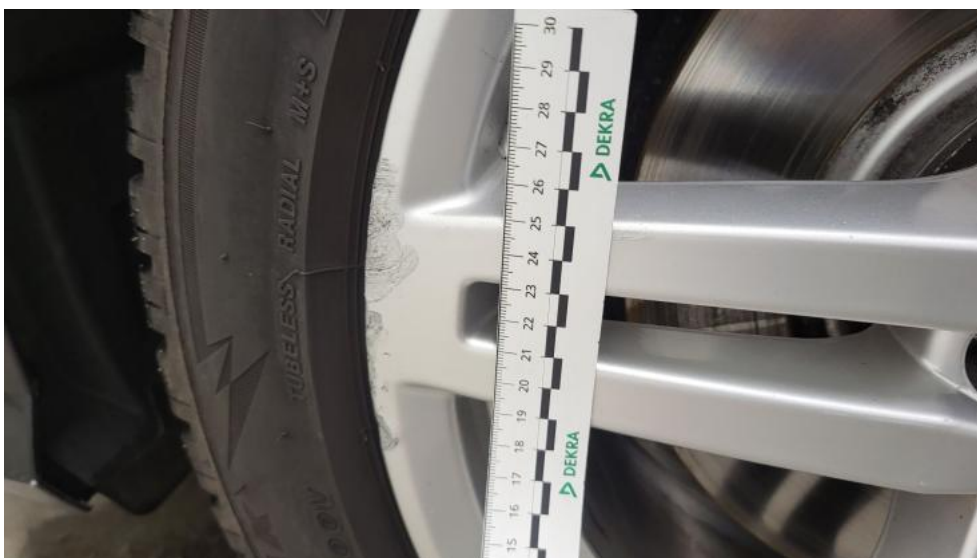
Fot. 76. Felga Aluminiowa przednia L - Rysa/odprysk 1
