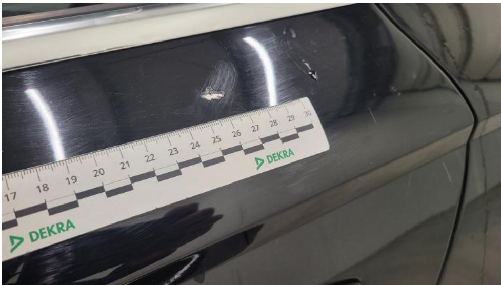
Fot. 71. Drzwi tylne L - Rysa/odprysk 2
