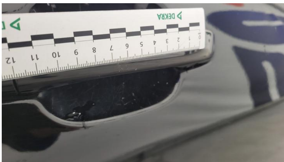
Fot. 56. Klamka drzwi tyl P - Rysa/odprysk 1
