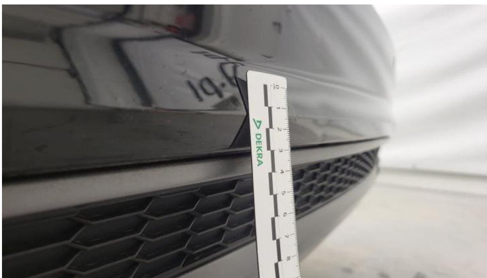
Fot. 63. Zderzak tylny() - Wgniecenie/odkształcenie 3
