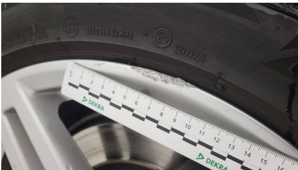
Fot. 60. Felga aluminiowa tylna P - Rysa/odprysk 1
