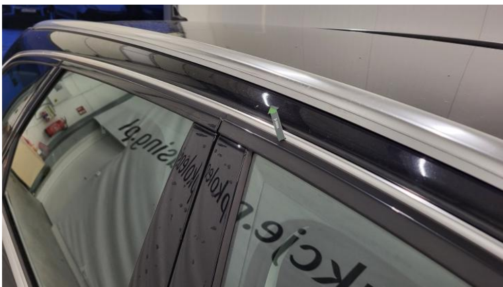
Fot. 58. Słupek przedni P - Wgniecenie/odkształcenie 1
