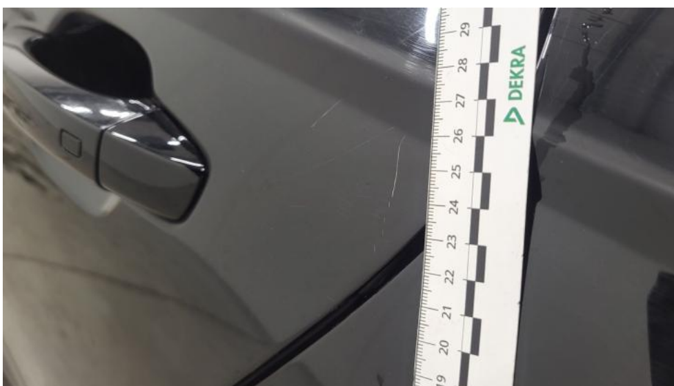
Fot. 70. Drzwi tylne L - Rysa/odprysk 1
