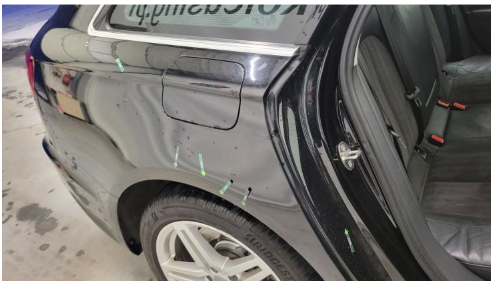
Fot. 59. Błotnik tylny P / Ściana boczna P - Wgniecenie/odkształcenie 1
