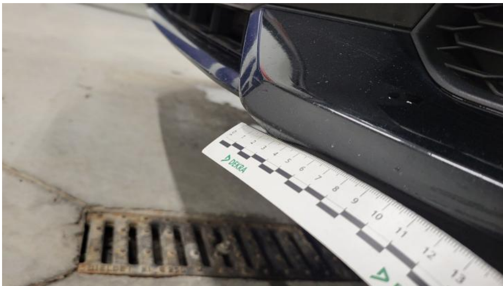
Fot. 45. Zderzak - Wgniecenie/odkształcenie 1
