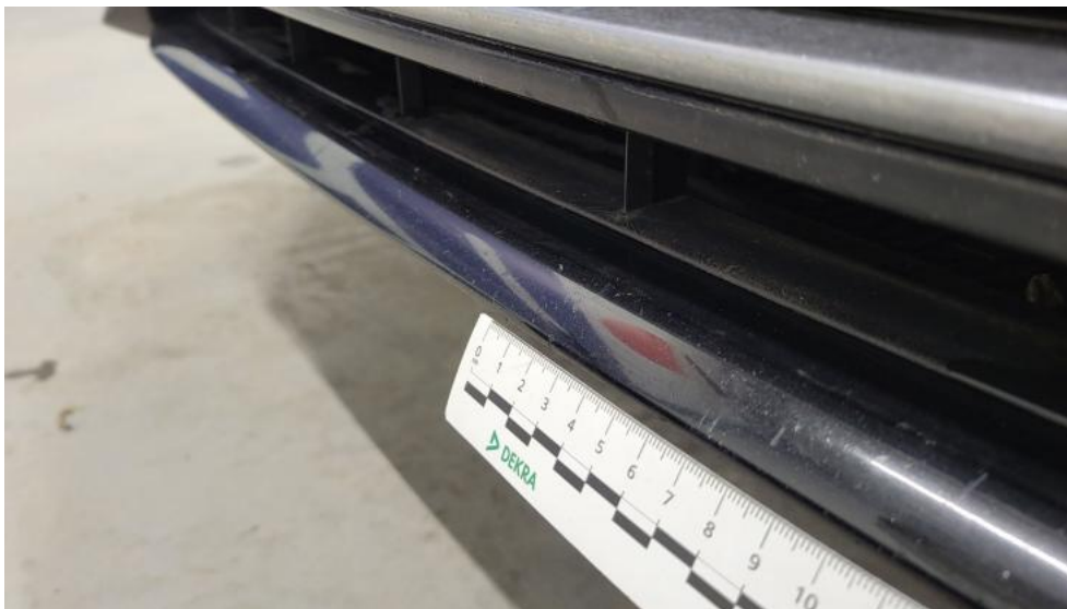
Fot. 43. Spoiler zderzaka przedniego - Rysa/odprysk 1
