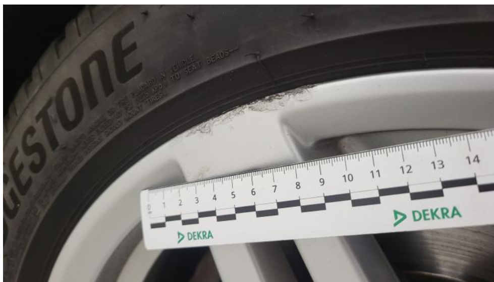
Fot. 67. Felga aluminiowa tylna L - Rysa/odprysk 1
