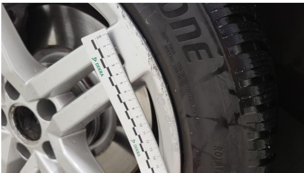
Fot. 50. Felga aluminiowa przednia P - Rysa/odprysk 1
