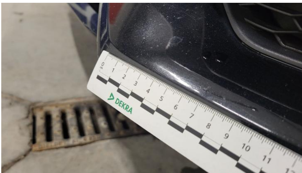
Fot. 47. Zderzak - Pęknięcie/rozerwanie 1
