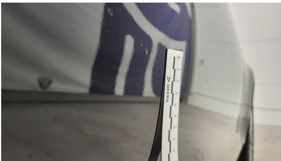
Fot. 53. Drzwi przednie P - Wgniecenie/odkształcenie 1
