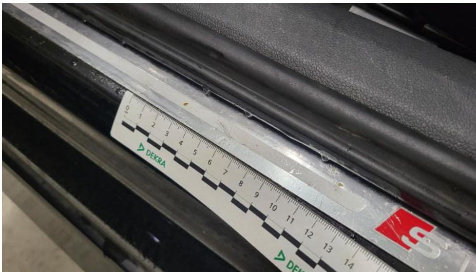
Fot. 73. Próg L - Rysa/odprysk 1
