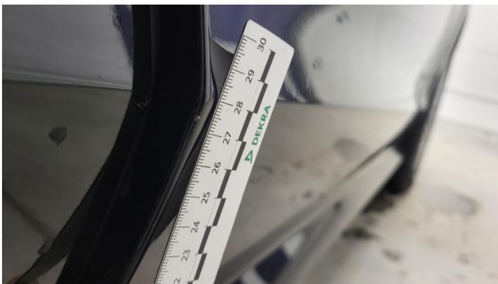
Fot. 52. Drzwi przednie P - Rysa/odprysk 1
