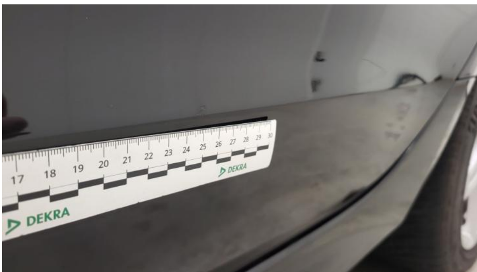
Fot. 72. Drzwi tylne L() - Rysa/odprysk 3
