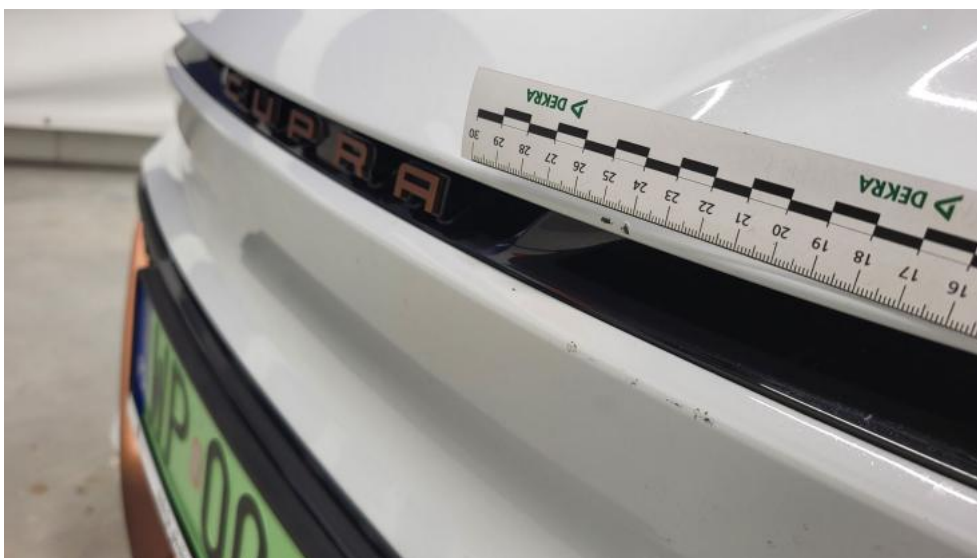
Fot. 42. Atrapa przednia - Wgniecenie/odkształcenie 1
