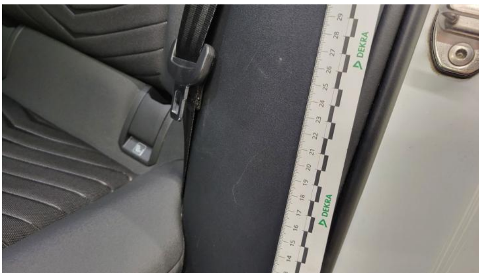
Fot. 52. Wykładzina(y) słupka tylnego L - Rysa/odprysk 1
