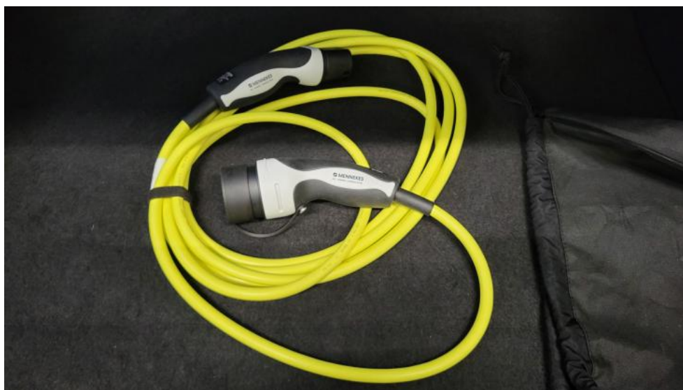
Fot. 34. Przewód ładowania baterii trakcyjnej
