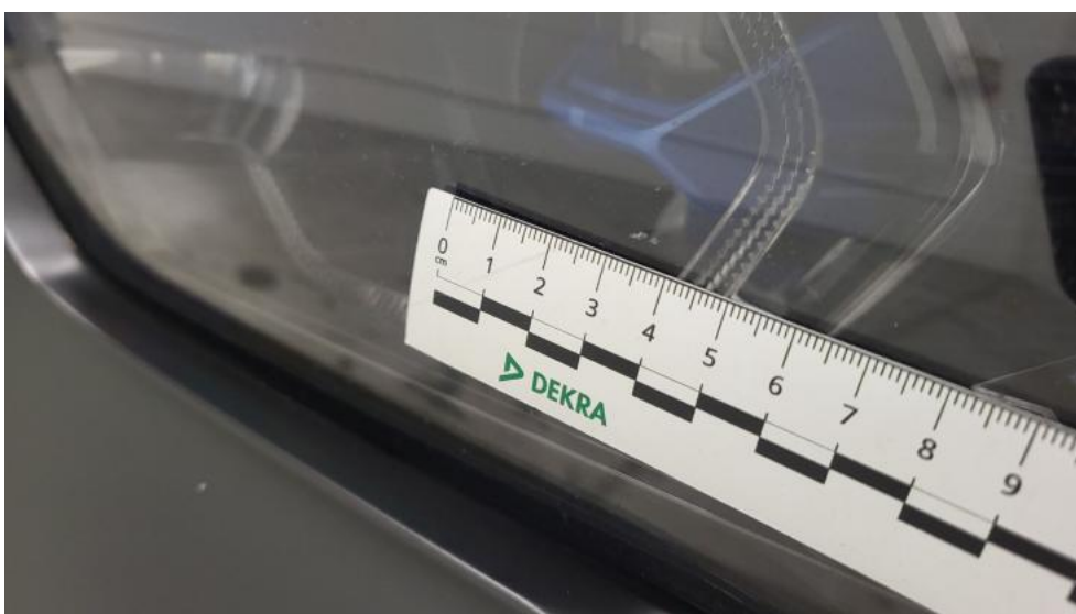
Fot. 66. Reflektor L - Rysa/odprysk 1
