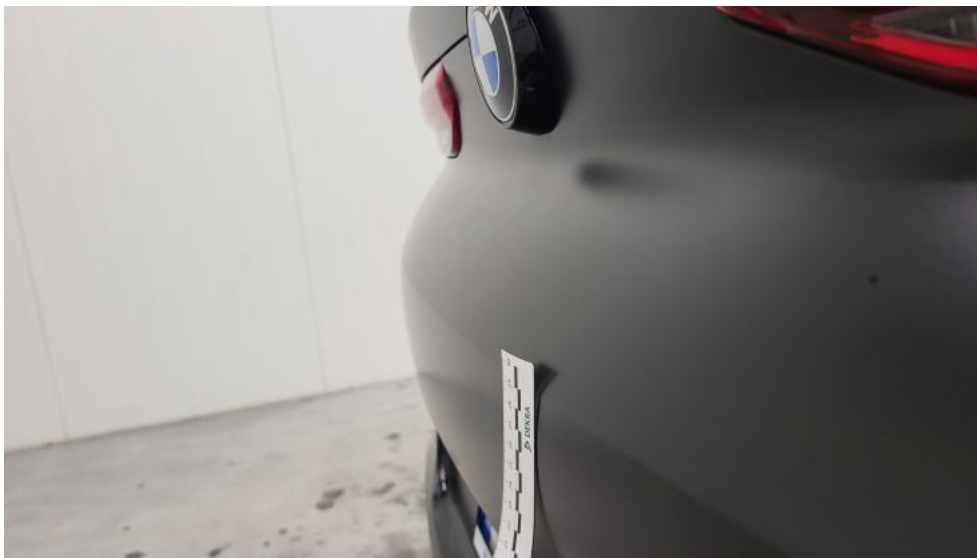
Fot. 59. Pokrywy bagażnika - Wgniecenie/odkształcenie 2
