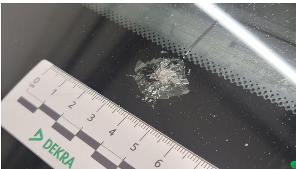
Fot. 52. Szyba czołowa - Pęknięcie/rozerwanie 1
