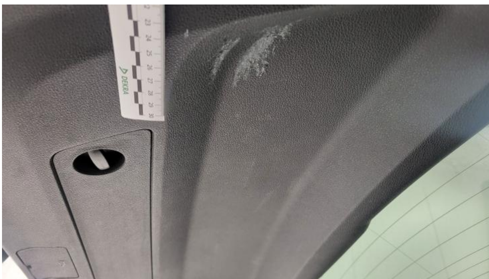
Fot. 46. Wykładzina pokrywy tylnej - Rysa/odprysk 1
