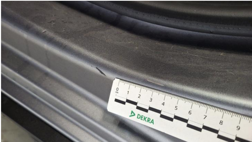
Fot. 59. Próg L - Rysa/odprysk 1
