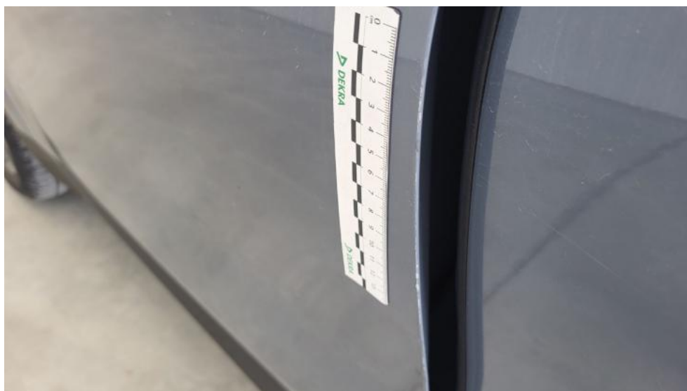
Photo 74. Drzwi przed L - Rysa/odprysk 1
