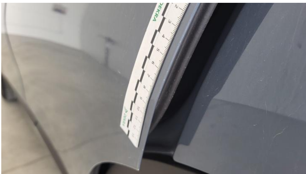
Photo 76. Drzwi tylne L - Rysa/odprysk 1
