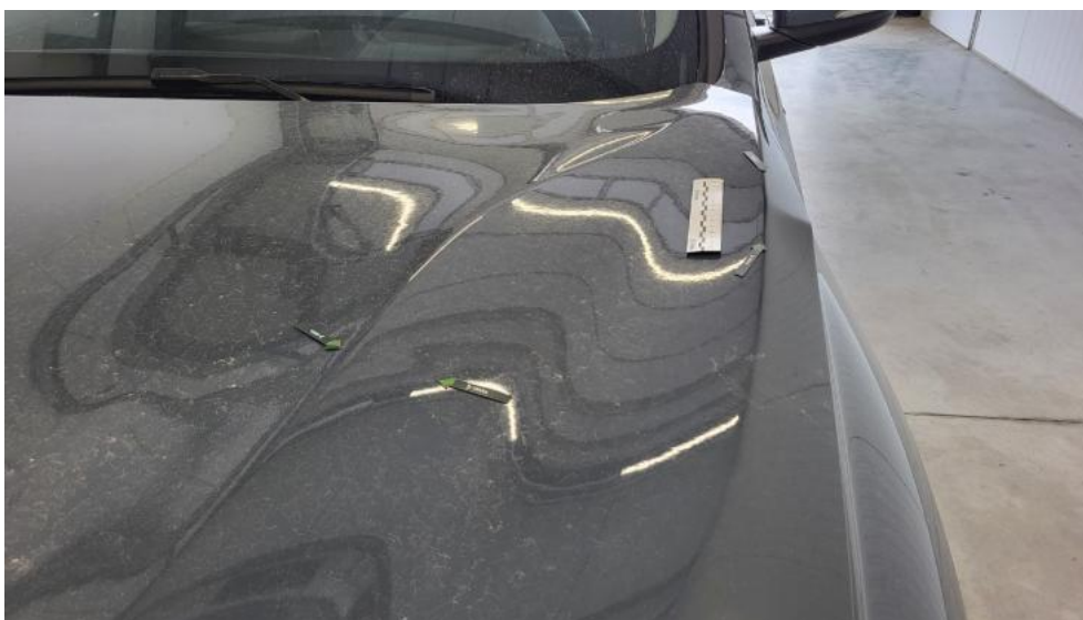
Photo 53. Pokrywa komory silnika() - Wgniecenie/odkształcenie 3
