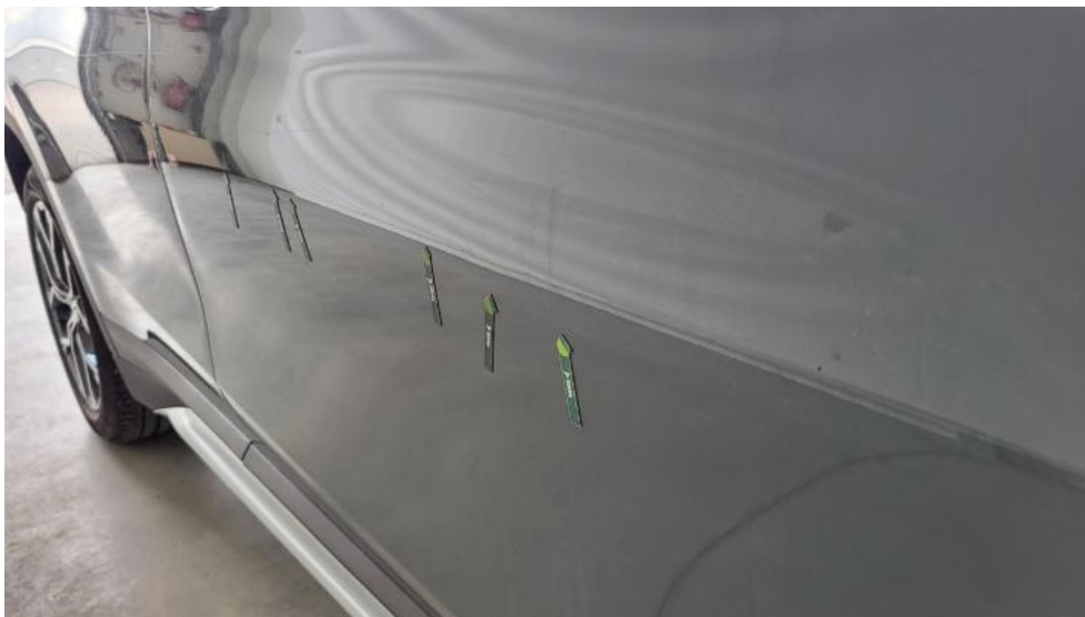
Photo 63. Drzwi przednie P - Wgniecenie/odkształcenie 1
