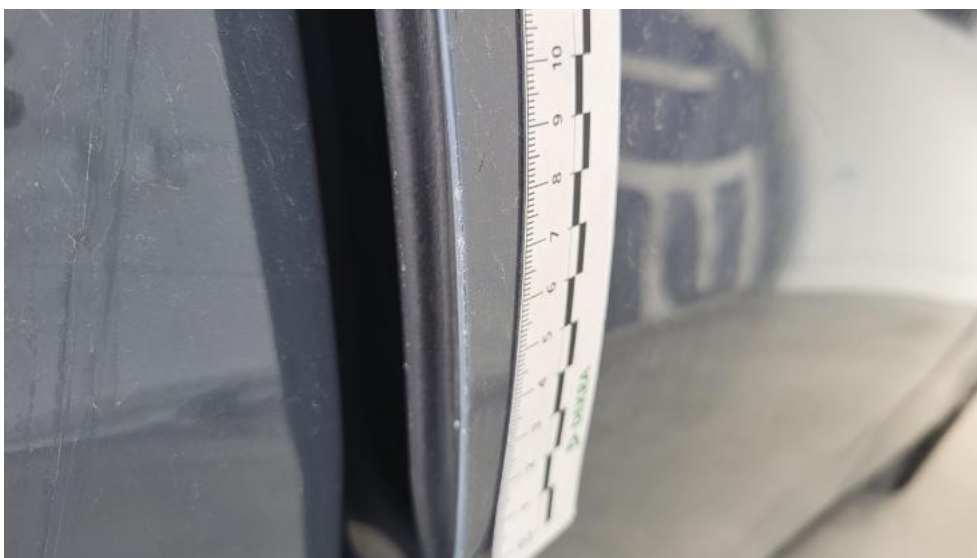
Photo 64. Drzwi tylne P - Rysa/odprysk 1
