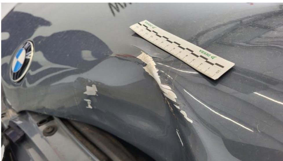
Photo 54. Pokrywa komory silnika - Pęknięcie/rozerwanie 1
