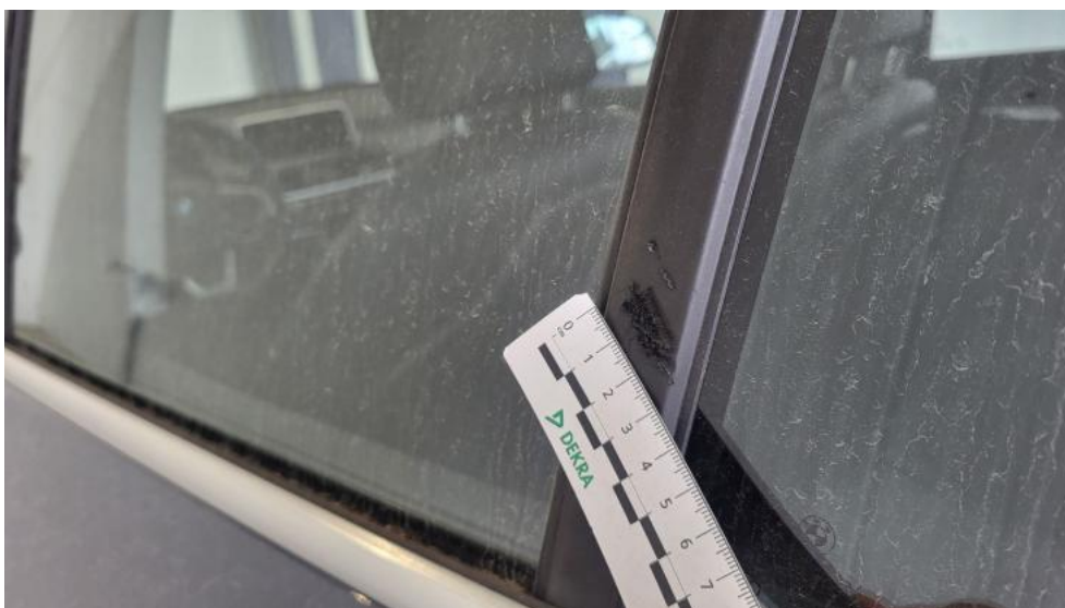
Photo 78. Listwa drzwi tylnych L - Rysa/odprysk 1
