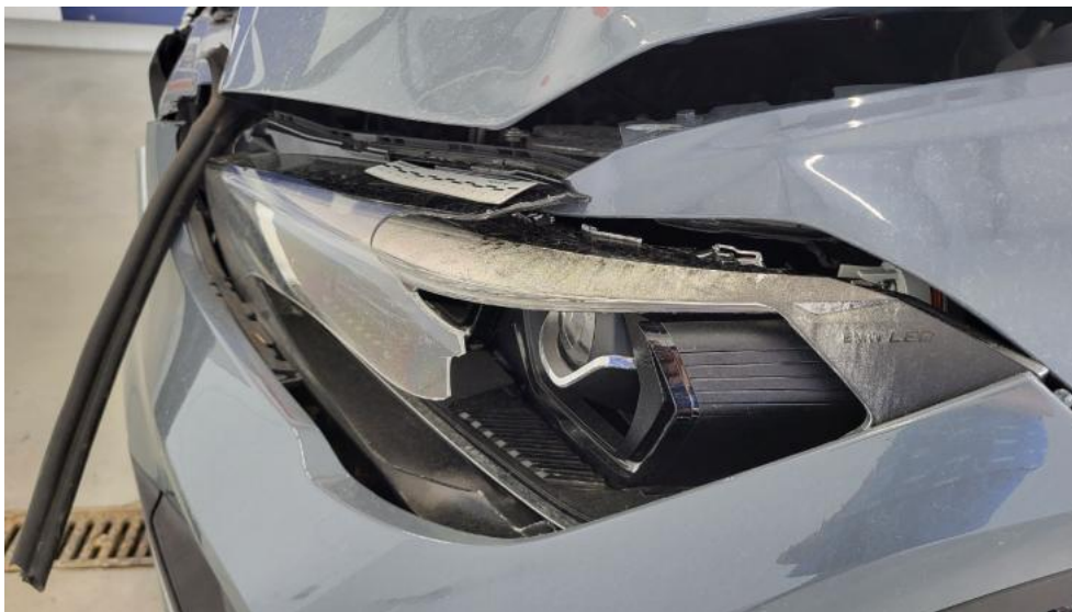
Photo 83. Reflektor L - Pęknięcie/rozerwanie 1
