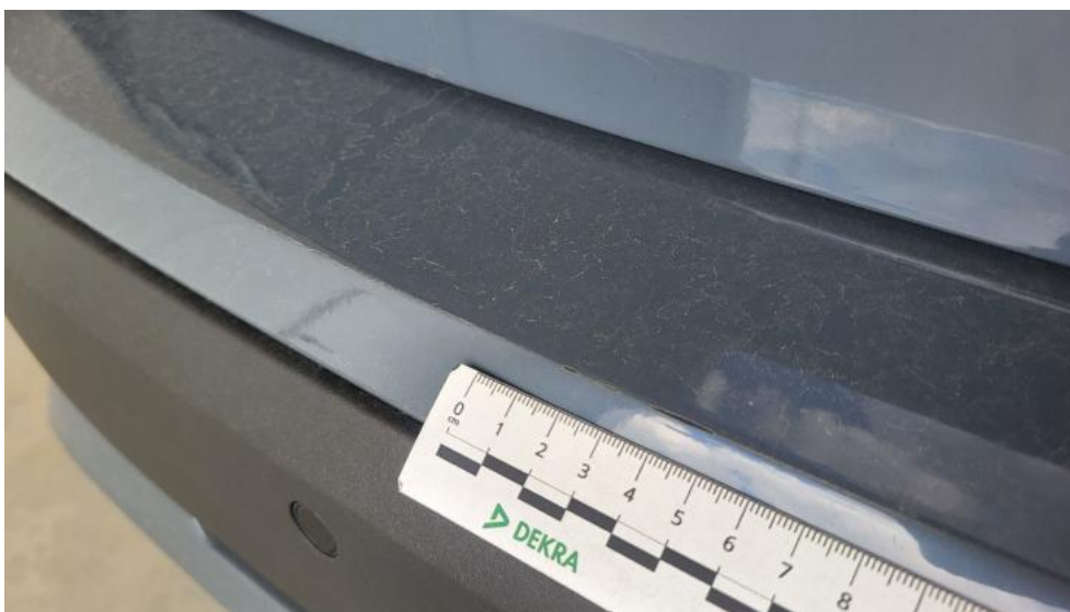
Photo 69. Zderzak tylny cz górna - Rysa/odprysk 1
