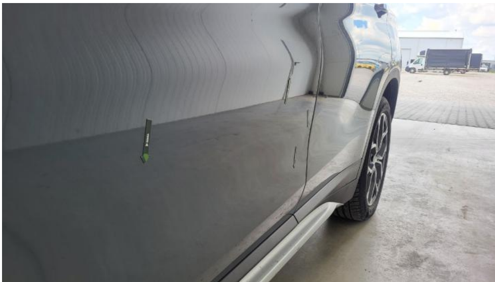
Photo 75. Drzwi przed L - Wgniecenie/odkształcenie 1
