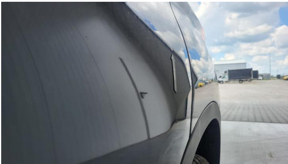
Photo 77. Drzwi tylne L - Wgniecenie/odkształcenie 1
