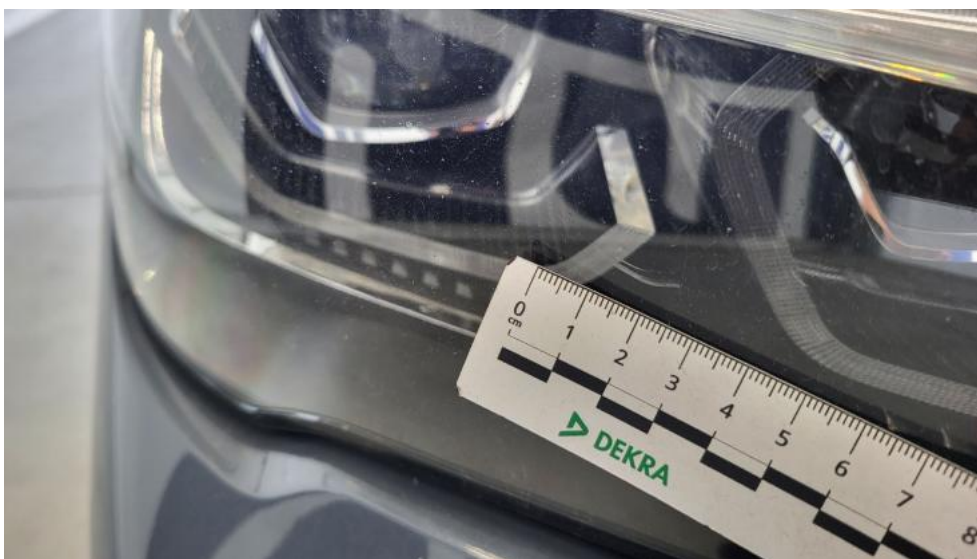
Photo 61. Reflektor P - Rysa/odprysk 1
