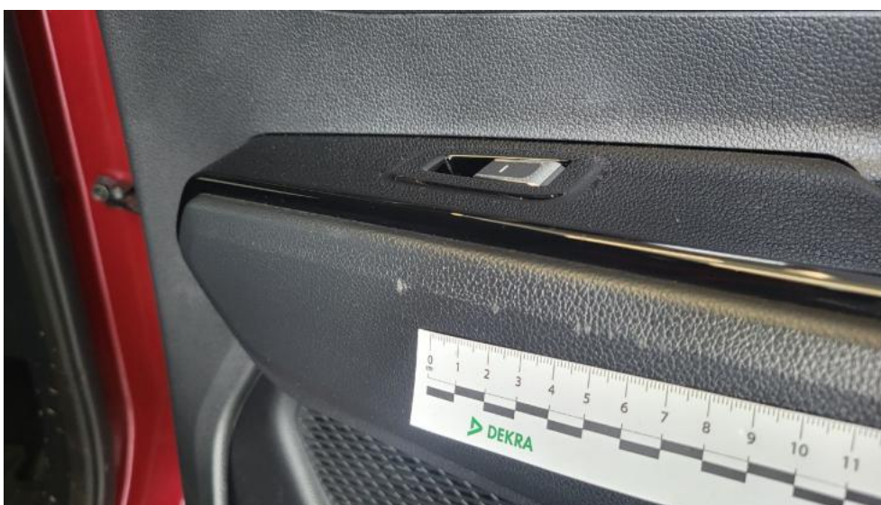
Fot. 86. Tapicerka drzwi tylnych P - Rysa/odprysk 1
