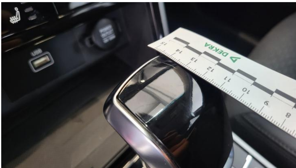
Fot. 82. Gałka dźwigni zmiany biegów - Rysa/odprysk 1
