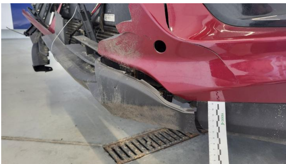
Fot. 58. Zderzak przedni cz dolna - Pęknięcie/rozerwanie 1
