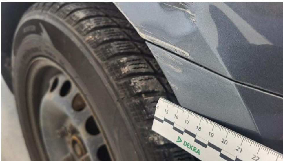
Fot. 43. Zderzak - Rysa/odprysk 1
