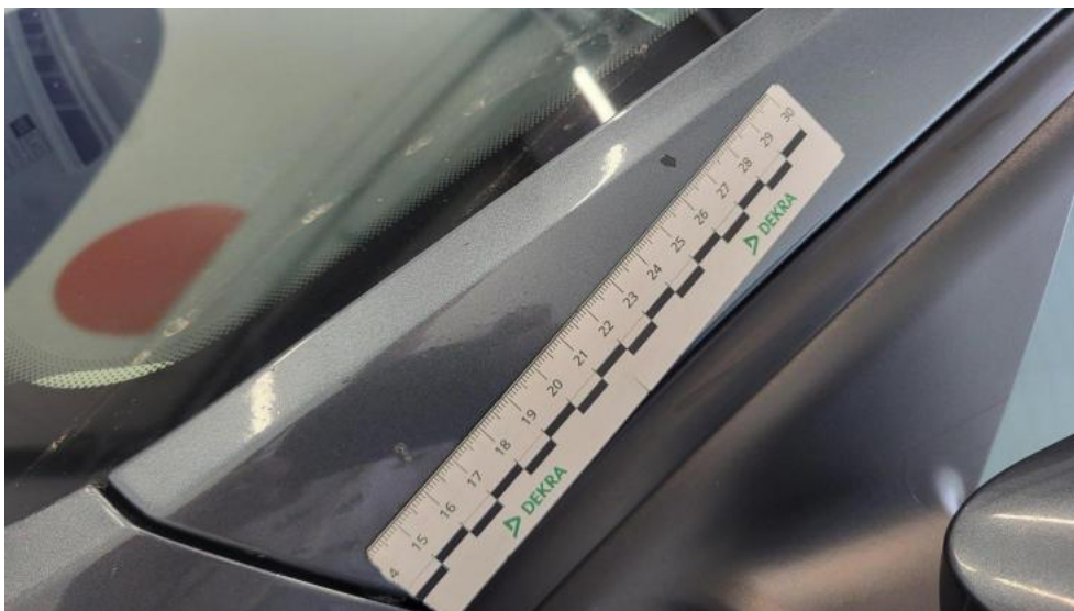
Fot. 83. Słupek przedni L - Rysa/odprysk 1
