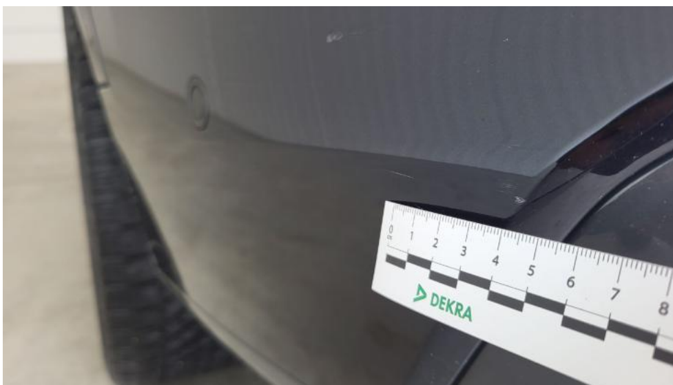
Fot. 59. Zderzak tylny - Rysa/odprysk 1
