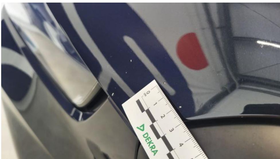
Fot. 48. Pokrywa komory silnika - Rysa/odprysk 1
