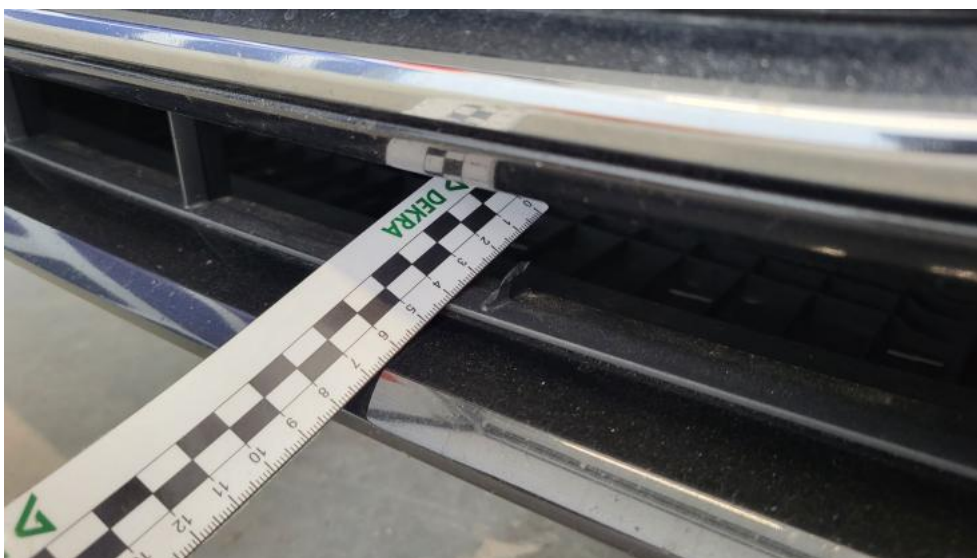
Fot. 42. Krata zderzaka prz. - Pęknięcie/rozerwanie 1
